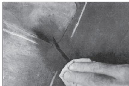
**7** Изнутри шины очистите область вокруг повреждения на ширину 100 мм во всех направлениях чистящей жидкостью с помощью атомайзера (распылителя). Помещение при этом должно хорошо проветриваться.
