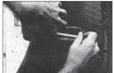
**6** Измерьте длину и ширину повреждения. По таблице определите, подлежит ли данное повреждение ремонту (см. приложение). Ширина повреждения в радиальной шине определяется количеством нитей поврежденного корда.
