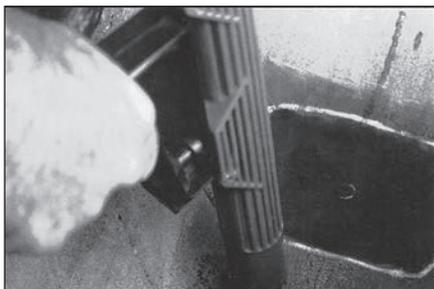
**18** Очистите пылесосом обработанную область для удаления металлической стружки и резиновой пыли. Очистите обработанную область проволочной щеткой S892 при скорости вращения дрели 4000 об/мин. Повторить очистку пылесосом.
