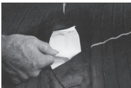
**35** Снимите защитную пленку с платформы сырой резины изнутри шины.
