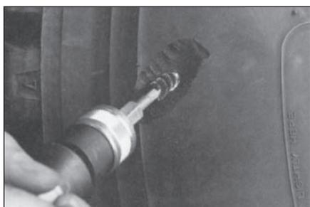
**16** Из-за того что резина пригорает при использовании инструмента на высокооборотной дрели, необходимо обработать края повреждения короткой проволочной щеткой № S896 на низкооборотной дрели, чтобы придать им необходимую шероховатую текстуру.
