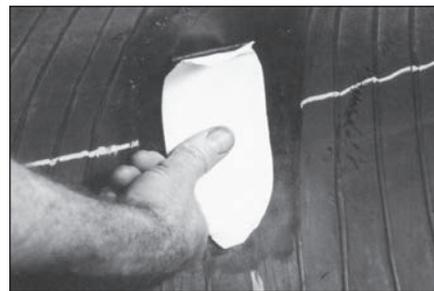
**30** Вырежьте платформу из сырой резины толщиной 3 мм и размером на 25 мм больше, чем размеры обработанного повреждения внутри шины. Расположите платформу по центру повреждения и прижмите ее большим пальцем.
