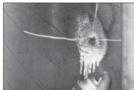
**6** Нанесите чистящую жидкость №704E на отмеченную область изнутри шины с помощью атомайзера (распылителя).
