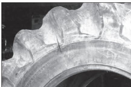
**1** Если шина была заполнена специальной жидкостью для балласта или вода попала внутрь, удалите всю жидкость и дайте шине полностью высохнуть в течение как минимум 24 часов.
