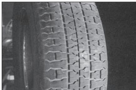
**1** Внимательно осмотрите шину с внешней и внутренней стороны, найдите повреждение, чтобы определить, подлежит ли она ремонту (см. приложение). Зона осмотра должна быть хорошо освещена.
