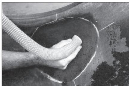
**48** Очистите пылесосом обработанную область для удаления металлической стружки и мелких частиц резины.
