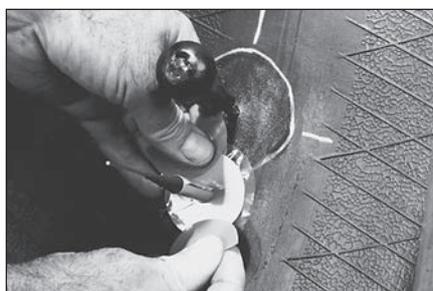
**16** Частично снимите синюю защитную пленку со шляпки грибка и освободите серый слой резины. Это позволит брать шляпку, не касаясь руками серого слоя резины, а также предотвратит преждевременное приклеивание, пока грибок не будет установлен на место.
