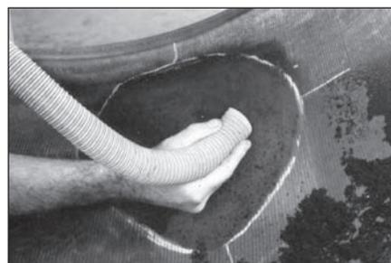
**46** Очистите пылесосом обработанную область для удаления металлической стружки и мелких частиц резины.
