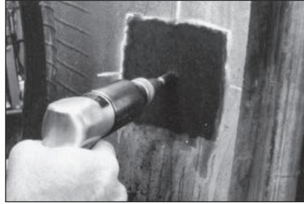
**11** Обработайте прокол с внутренней стороны шины карбидной фрезой 271/38 или 272 на пневмодрели, вращая её по часовой стрелке. Скорость вращения пневмодрели не должна превышать 1200 об/мин. Повторите эту процедуру, как минимум, три раза.
