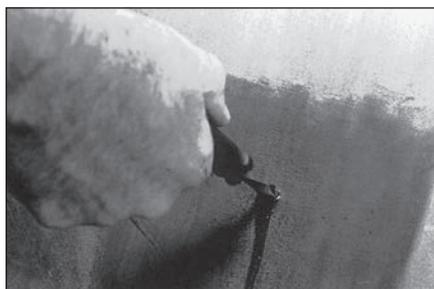
**10** Нанесите клей для химической вулканизации № 760 внутрь прокола и по всей его длине с помощью спирального шила, поворачивая шило по часовой стрелке. Повторите эту процедуру от 3 до 5 раз. Оставьте шило в проколе до тех пор, пока не перейдете к выполнению пункта 12.
