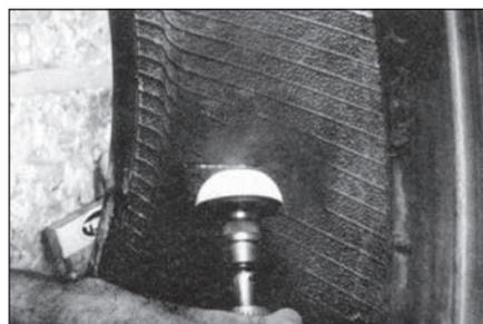
**21** Обработайте шину с внутренней стороны по периметру на ширину 40 мм вокруг повреждения мелкозернистой абразивной полусферой RH107 на низкооборотной дрели. Вы должны получить ровную платформу для вулканизационной резины.
