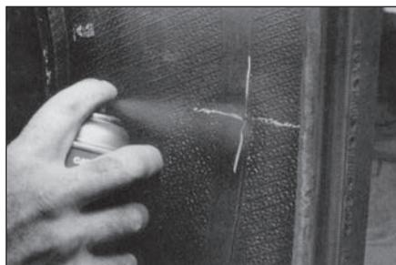
**7** Нанесите чистящую (обезжиривающую) жидкость на отмеченную область шины с помощью атомайзера (распылителя).
