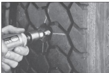
**10** Используя камень из оксида алюминия № S872 на высокооборотной пневмодрели, обработайте все распутившиеся нити стального корда до самой резины в месте повреждения. При этом действуйте с перерывами, чтобы резина не подгорала.
