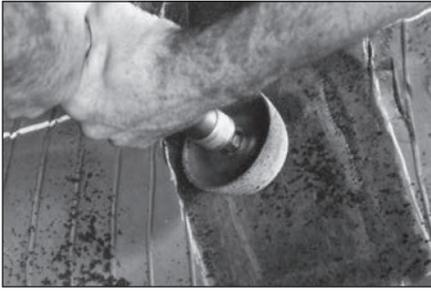
**46** Используя средне- или мелкозернистую полусферу RH120 или RH118 на низкооборотной дрели, обработайте пористый слой резины до получения ровной текстуры. Затем обработайте скос между внешним контуром по периметру заплаты и оставшимся участком заштрихованной области.
