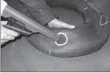
**10** Очистите пылесосом обработанную область для удаления металлической стружки и резиновой пыли.
