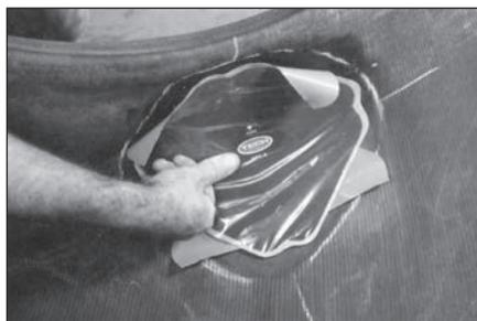
**51** Расположите заплатку строго по центру повреждения, используя линии, которые вы начертили в пункте 17. Убедитесь, что стрелка на заплатке, указывающая направление корда, направлена к ободу шины. Это значит, что направление нитей корда в заплатке совпадает с направлением нитей корда в шине. Прижмите середину заплатки большим пальцем.
