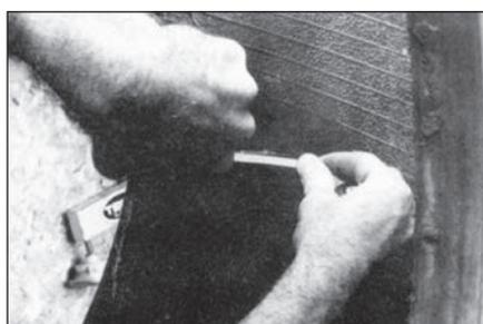
**22** Измерьте длину и ширину обработанного повреждения изнутри шины для правильного выбора заплаты.
