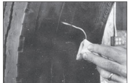
**9** Нанесите чистящую жидкость на ткань, не содержащую ворса, и очистите место повреждения с внешней стороны шины.
