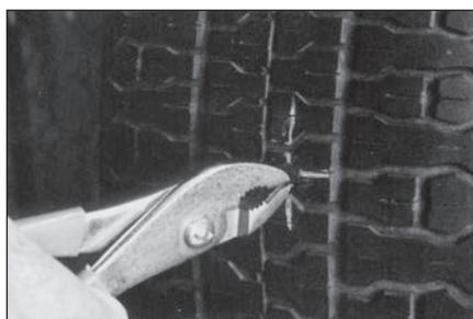
**17** Зажмите плоскогубцами металлический держатель с внешней стороны шины и вытяните ножку грибка. Если металлический держатель отделится от ножки, когда ножка грибка выйдет из прокола, зажмите ее плоскогубцами и тяните до тех пор, пока подложка не коснется поверхности шины изнутри.
