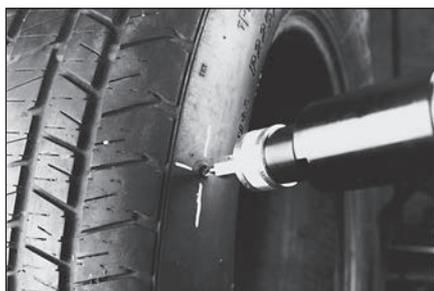
**9** При ремонте прокола в верхней или нижней части боковой поверхности шины обрабатывайте его карбидной фрезой только с внешней стороны шины. Изнутри этого делать не нужно. Соблюдайте угол прокола.
