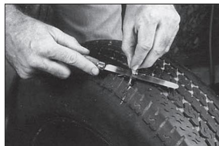
**15** Отрежьте оставшиеся на поверхности части жгута с внешней стороны шины.
