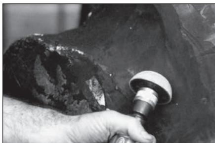
**56** Используя мелкозернистую абразивную полусферу RH107 на низкооборотной дрели, обработайте место ремонта шины снаружи так, чтобы оно стало вровень с остальной поверхностью шины.
