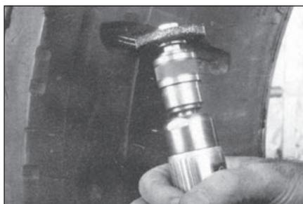
**11** Удалите оставшуюся резину между нитями корда с помощью metalloщетки в полиуретане № S890 на низкооборотной дрели. Обработайте порез так, чтобы обнажились только те нити корда, которые повреждены по всей длине пореза. При этом metalloщетка в полиуретане не повреждает нити корда.
