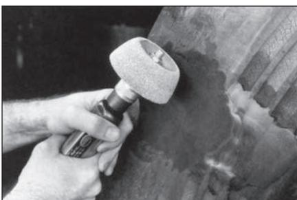
**59** Используя мелкозернистую абразивную полусферу RH118 на низкооборотной дрели, снимите излишки резины с внешней стороны шины по направлению от центра к краям до получения ровной поверхности.
