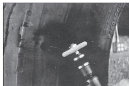
**18** Для придания шероховатости поверхности воронки повреждения обработайте её шероховальным кругом RH304 с зернистостью 230 SSG на низкооборотной пневмодрели, удерживая его под углом 45°. Круг при этом не должен касаться металлокорда.
