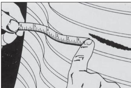
**4** Измерьте расстояние между бортовым кольцом шины и краем повреждения изнутри шины. Если повреждение находится в неремонтируемой зоне A-B по таблице, то шина ремонту не подлежит.
