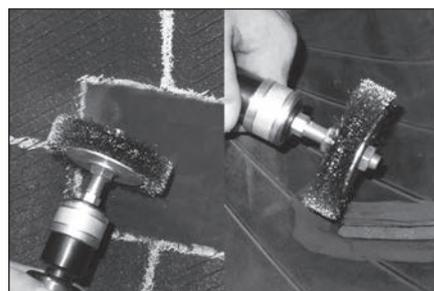
**27** Обработайте область вокруг повреждения текстурной metalloщёткой S892 на пневмодрели со скоростью вращения 4000 об/мин.
