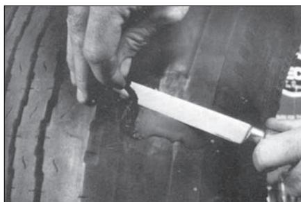
**43** После окончания вулканизации отсоедините линию подачи воздуха и снимите вулканизатор с шины. Дайте крышке остыть, а затем гибким ножом № 942 отрежьте остатки непроваренной резины на шине.
