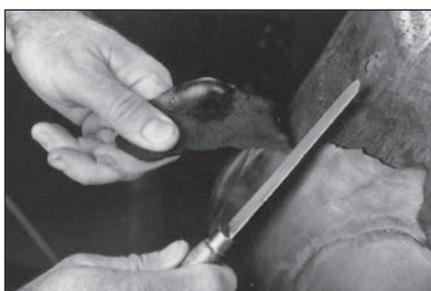
**38** После вулканизации снимите вулканизатор с шины, дайте ей остыть и срежьте лишнюю резину изнутри и снаружи шины специальным ножом 940 или 942.
