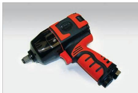
Ударные пневмогайковерты для легковых и грузовых колес. Надежные, компактные, имеют большой ударный момент в сочетании с малым весом. Ударные головки изготовлены из специальной хромомолибденовой стали Cr-Mo с термообработкой. Обработаны фосфатом марганца для увеличения износостойкости и предотвращения появления коррозии. Устойчивы к грязи, маслу и высоким температурам.
