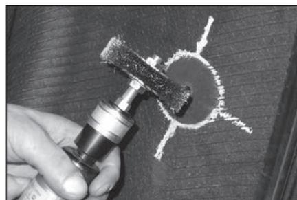
**11** Обработайте область вокруг повреждения текстурной metalloщёткой S892 на пневмодрели со скоростью вращения 4000 об/мин.
