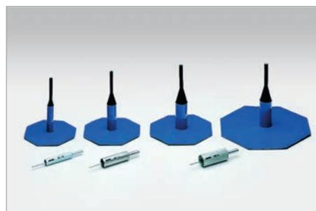
Грибки Uni-Seal с круглой и квадратной шляпкой предназначены для ремонта подготовленных проколов диаметром от 3 до 13 мм в протекторе радиальных и диагональных шин. Грибки с шестиугольной шляпкой применяются для ремонта подготовленных проколов от 13 до 25 мм в протекторе диагональных шин. Все грибки TECH устанавливаются методом холодной вулканизации.
