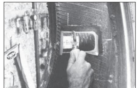
**53** Тщательно прикатайте заплату раскаткой № 936 от центра к краям. Нажимайте на раскатку для обеспечения более плотного контакта заплаты и шины.
