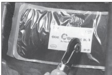
**46** Тщательно прикатайте заплату раскаткой № 936 от центра к краям. Нажимайте на раскатку для обеспечения более плотного прилегания заплаты к шине.
