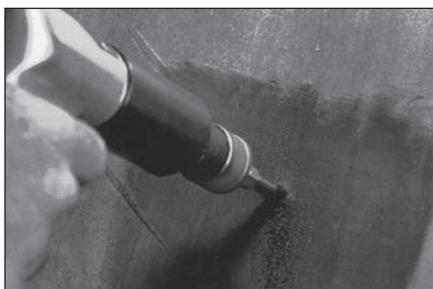
**8** Изнутри шины обработайте прокол карбидной фрезой на пневмодрели со скоростью вращения не более 1200 об/мин и направлением вращения по часовой стрелке. Повторите эту процедуру, как минимум, три раза.
