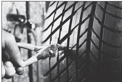
**2** Удалите предмет, вызвавший прокол в шине, а затем исследуйте шину на предмет расслоения корда.
