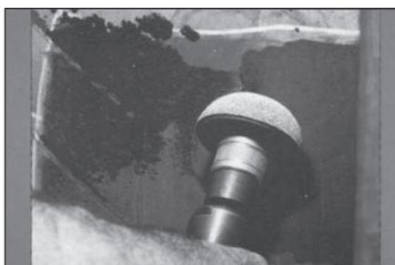
**40** Обработайте отмеченную область мелкозернистой абразивной полусферой RH107 на низкооборотной дрели (не более 4000 об/мин) до получения ровной поверхности. Это необходимо для увеличения площади соприкосновения заплата с шиной.
