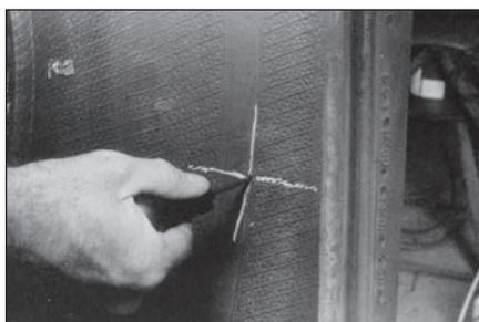
**5** Определите размер, угол и глубину прокола снаружи и изнутри с помощью гладкого шила 910-1.
