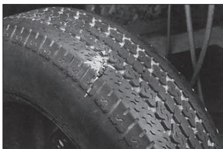
**16** Проверьте отремонтированную шину на герметичность с помощью жидкости для поиска проколов № 751. Если не будет пузырьков воздуха, шина готова к эксплуатации.
