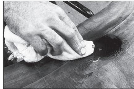
**3** Очистите ремонтируемую область с помощью чистящей (обезжиривающей) жидкости №704E и ткани, не содержащей ворс.
