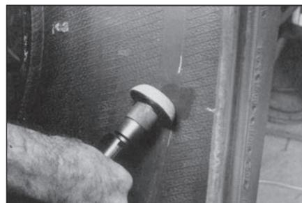
**9** Обработайте отмеченную область мелкозернистой абразивной полусферой RH107. Скорость вращения дрели при обработке не должна превышать 4000 об/мин. При обработке внутренней поверхности шины старайтесь не задеть нити корда. При работе необходимо использовать защитные очки № S918.
