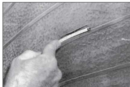
**4** При ремонте повреждения в боковой поверхности измерьте расстояние от края борта по контуру шины до края повреждения.
