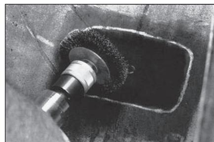
**17** Удалите частицы резины на обработанной области с помощью мягкой проволочной щетки S893 и низкооборотной дрели. При этом двигайтесь справа налево.
