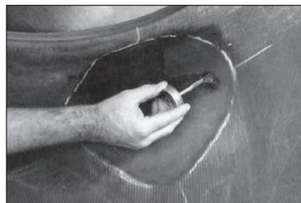
**49** Нанесите слой клея № 760 для холодной вулканизации на обработанную поверхность. Дайте клею примерно 3–5 минут для того, чтобы он полностью высох. Если ремонтируемая область камерной шины обработана до синтетических нитей корда, нанесите на нее 2 слоя клея и увеличьте время высыхания вдвое.
