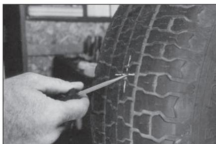
**4** Исследуйте повреждение с внешней и внутренней стороны шины с помощью гладкого шила 910-1.
