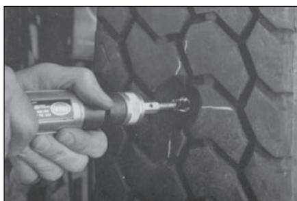
**13** Обработайте воронку вокруг повреждения снаружи шины короткой проволочной щеткой №S896 на низкооборотной дрели, чтобы придать ей необходимую шероховатую текстуру, так как происходит пригорание резины при использовании инструмента на высокооборотной дрели. Держите щетку под углом 90°.
