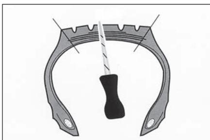
**5** Если спиральное шило входит в повреждение с небольшим сопротивлением или без него, проверьте, чтобы размер повреждения не превышал 10 мм.
