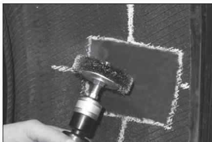
**47** Обработайте обведенную область вокруг повреждения текстурной металлощеткой S892 на пневмодрели со скоростью вращения 4000 об/мин.
