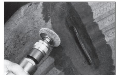
**18** Тем же шероховальным кольцом слегка зачистите поверхность шины по периметру повреждения на расстоянии 25–40 мм.
