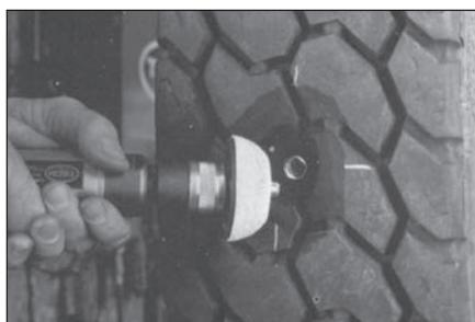
**14** Обработайте область вокруг повреждения на ширину от 40 до 50 мм абразивной полусферой RH107 на низкооборотной пневмодрели.
