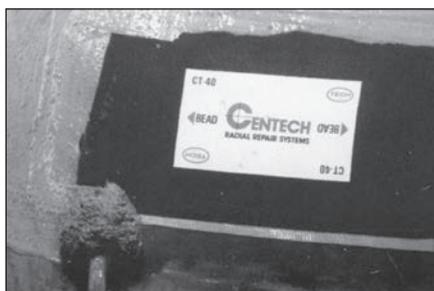
**49** При ремонте бескамерной шины нанесите герметик № 738 по периметру заплаты и на оставшуюся обработанную поверхность. Если ремонтируете камерную шину, посыпьте отремонтированное место тальком № 706. Это предотвратит слипание серого слоя на краях заплаты и камеры.
