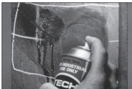
**38** Нанесите чистящую жидкость №704Е с помощью атомайзера (распылителя) на отмеченную область покрышки.
