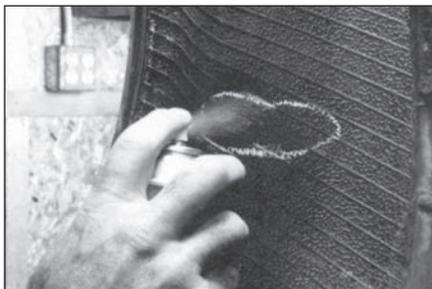
**7** Если шина подлежит ремонту, нанесите чистящую жидкость № 704E на отмеченную область покрышки с помощью атомайзера (распылителя).
