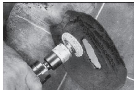
**15** Используя крупнозернистый шероховальный круг RH310 на низкооборотной дрели, удалите всю подгоревшую резину и неровности и постарайтесь, чтобы угол наклона воронки повреждения был  $45^\circ$ , если оно на боковой поверхности шины, а на повреждениях в плечевой области и в области протектора  $60^\circ$ .
