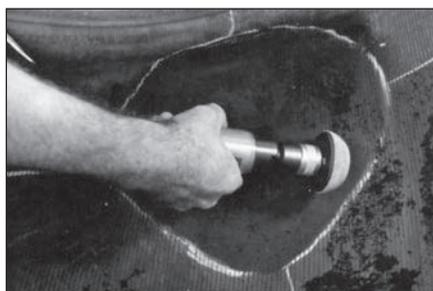
**45** Обработайте отмеченную область до ровной поверхности мелкозернистой абразивной полусферой RH107 на низкооборотной дрели со скоростью вращения не более 4000 об/мин. Это необходимо для увеличения площади соприкосновения заплатки с шиной.
