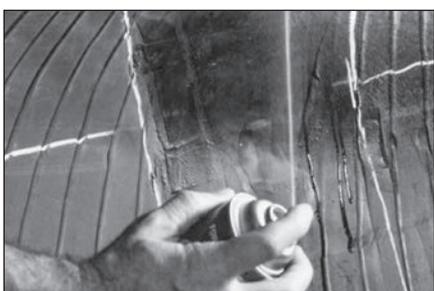
**40** Нанесите чистящую жидкость № 704Е на обведенную область шины с помощью атомайзера (распылителя).
