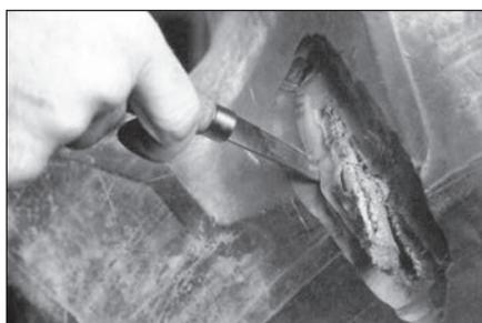
**12** Используя специальный нож № 940, окончательно удалите резину из поврежденного места шины. Нож должен быть направлен под углом 90° к шине.
