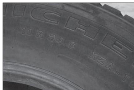
**18** По сведениям, указанным на боковой поверхности шины, определите ширину профиля шины, а также является ли шина камерной или бескамерной.
