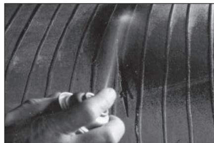
**6** Очистите место повреждения изнутри шины чистящей жидкостью № 704E с помощью атомизера (распылителя).
