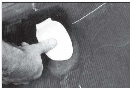
**27** Вырежьте платформу из сырой резины толщиной 3 мм и по ширине на 25 мм больше, чем размеры обработанного повреждения. Расположите ее с внутренней стороны шины строго по центру повреждения. Прижмите эту платформу большим пальцем.
