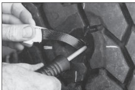
**28** Запрессуйте полоски сырой резины в повреждение с внешней стороны шины трамбовкой как можно более компактно.
