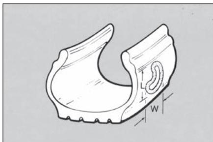
**22** Этот рисунок показывает, как правильно измерять размеры повреждения на радиальной шине. Длину измеряют от борта к борту по вертикали, ширину – в направлении движения шины по горизонтали. Измерение ширины важнее, так как она определяет количество поврежденных нитей корда.
