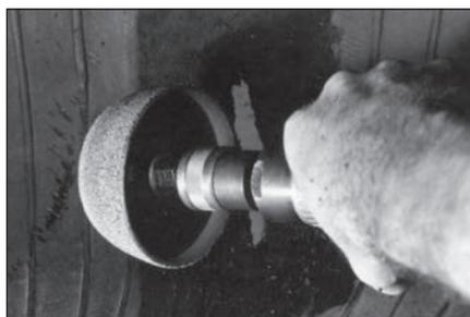
**20** Используя мелкозернистую полусферу RH118 на низкооборотной дрели, зачистите изнутри шины зону вокруг повреждения на расстоянии 50–65 мм.
