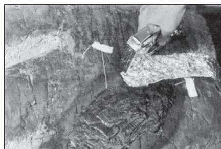
**83** При использовании вулканизационной камеры или вулканизатора типа Алтай перед проведением вулканизации в области протектора и в плечевой области необходимо поставить перемычку в канавке протектора, чтобы остановить «растекание» резины во время вулканизации.
