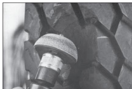
**51** Обработайте место ремонта шины снаружи мелкозернистой абразивной полусферой RH107 на низкооборотной пневмодрели (не более 4000 об/мин) так, чтобы поверхность шины стала ровной.
