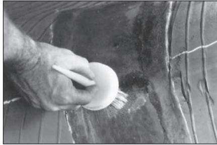
**50** Нанесите клей №760 для холодной вулканизации на всю обработанную область, двигаясь от центра к краям. Дайте клею высохнуть в течение 3–5 минут.
