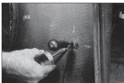
**14** Нанесите клей для химической вулканизации № 760 на обработанную поверхность. Дайте клею примерно 3–4 минуты для того, чтобы он полностью высох. При ремонте камерной шины обрабатывайте область до синтетических нитей корда, нанесите на нее 2 слоя клея. При работе в помещении с высокой влажностью или низкой температурой необходимо увеличить время высыхания клея.
