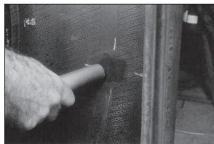
**12** Очистите пылесосом обработанную область для удаления металлической стружки, мелких частиц резины и резиновой пыли.
