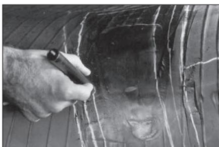
**43** Для лучшего приклеивания заплаты к шине рекомендуется снять верхний слой резины на шине непосредственно под заплатой. Обведите область для шерохования на расстоянии 25 мм внутри линии периметра заплаты.
