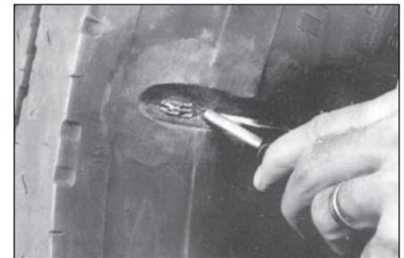
**35** Запрессуйте полоски сырой резины в повреждение с внешней стороны шины трамбовкой как можно более компактно.
