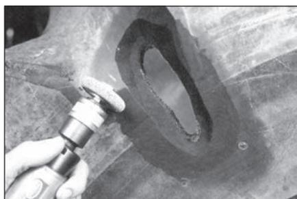
**15** Обработайте с внешней стороны шины область вокруг повреждения по периметру на ширину 40 мм шероховальным кругом RH308 с зернистостью (230 SSG) или мелкозернистой абразивной полусферой на низкооборотной дрели (максимальная скорость вращения 4000 об/мин).
