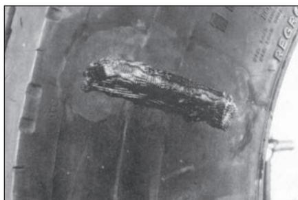
**37** Порез должен быть заполнен сырой резиной так, чтобы она выступала на 3–6 мм над поверхностью шины. Самая большая толщина слоя сырой резины должна находиться по центру поврежденного места и уменьшаться к его краям.
