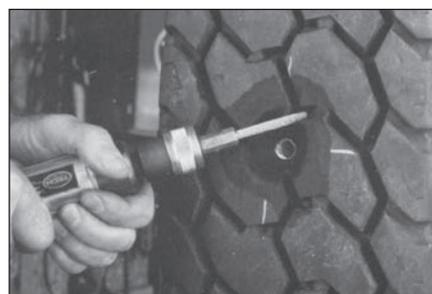
**15** Обработайте канавки протектора шерохователем в виде абразивного карандаша RH626 для лучшего последующего приклеивания вулканизирующей резины. Скорость вращения дрели при обработке не должна превышать 4000 об/мин.
