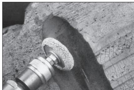
**17** С помощью крупнозернистого шероховального кольца RH310 на низкооборотной дрели обработайте место повреждения под углом 45° к плоскости повреждения для придания ему формы воронки. Не допускайте контакта абразивного инструмента с металлическим кордом.
