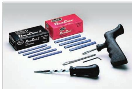
Аптечки – наборы автолюбителя для ремонта проколов. Эластичные, армированные синтетическим кордом, жгуты Permasure с клеевым слоем предназначены для ремонта проколов бескамерных шин любого типоразмера. Они устанавливаются методом холодной вулканизации. Бутылкачуковые жгуты применяются для временного ремонта шин и не вулканизируются. В обоих случаях шину не снимают с диска.
