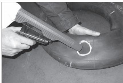
**8** Очистите пылесосом обработанную область для удаления металлической стружки и резиновой пыли.
