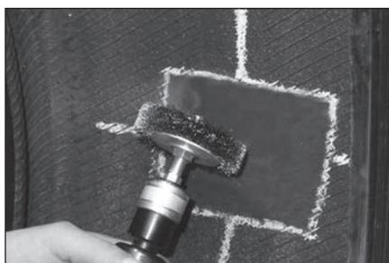
**41** Обработайте отмеченную область вокруг повреждения текстурной metalloщёткой S892 на пневмодрели со скоростью вращения 4000 об/мин.
