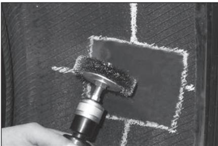
**13** Обработайте область вокруг повреждения текстурной металлощёткой S892 на пневмодрели со скоростью вращения 4000 об/мин.
