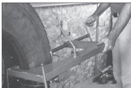
**34** Установите вулканизатор на шину, предварительно убедившись, что нагревательные элементы находятся по центру пореза снаружи и внутри шины. Установите пневмоподжим на вулканизаторе, подсоединив линию подачи воздуха.
