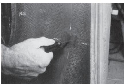
**13** Нанесите клей для химической вулканизации №760 внутрь прокола по всей его длине с помощью гладкого шила, поворачивая шило по часовой стрелке. Повторите эту процедуру от 3 до 5 раз. Оставьте шило в проколе до тех пор, пока не перейдете к выполнению пункта 16 данной инструкции.
