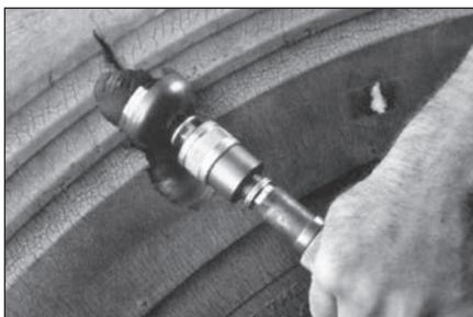
**8** Удалите резину в месте повреждения с внешней стороны шины колпачковым обрезателем № S2045, установленными на низкооборотной дрели (максимальная скорость вращения 4000 об/мин). **Внимание!** Старайтесь не повредить при этом стальные нити корда.
