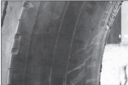
**1** Внимательно осмотрите шину с внешней и внутренней стороны, найдите повреждения, чтобы определить, подлежит ли она ремонту (см. приложение). Зона осмотра должна быть хорошо освещена.
