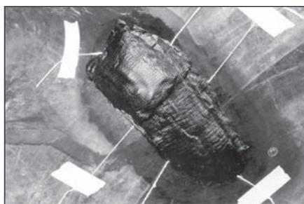
**32** Заполните повреждение так, чтобы сырая резина выступала на 3–6 мм над поверхностью шины (больше всего над центром обработанной области). Если повреждение находится в плечевой области шины, заполняйте повреждение до уровня на 9 мм выше поверхности шины, чтобы обеспечить нужное давление при вулканизации.
