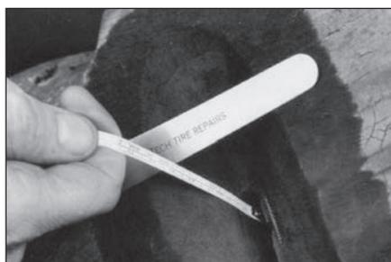
**25** Теперь нужно рассчитать время вулканизации. Для этого нужно знать толщину вулканизируемой резины. Измерьте максимальную глубину повреждения. Запишите данные.
