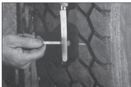
**16** Теперь вам необходимо определить общую толщину слоёв резины, которая будет вулканизоваться. Измерьте максимальную глубину пореза. Напишите размеры на внешней стороне шины для дальнейшего использования.
