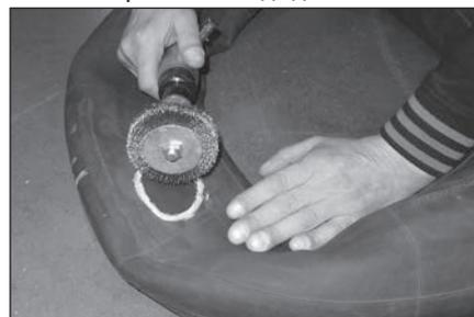
**9** Обработайте область вокруг повреждения текстурной metalloщёткой S892 на пневмодрели со скоростью вращения 4000 об/мин.
