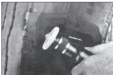
**19** С внешней стороны шины обработайте область шириной 25-40 мм по периметру вокруг воронки повреждения шероховальным кругом RH304 с зернистостью 230 SSG на низкооборотной пневмодрели.
