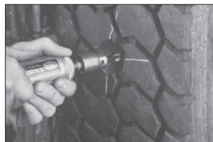
**9** Отрежьте с помощью алмазного бура № 283 на высокооборотной дрели (при минимальной скорости вращения 20 000 об/мин) все концы поврежденных нитей металлокорда. Держите бур под углом 90° к нити корда. Если повреждена одна нить корда, используйте алмазный бур № 280.
