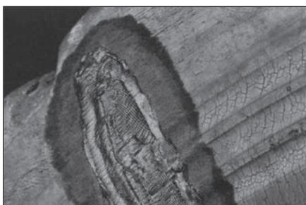
**34** Порез должен быть заполнен сырой резиной так, чтобы она выступала на 6–9 мм над поверхностью шины. Максимальная толщина слоя сырой резины должна находиться по центру поврежденного места и уменьшаться к его краям.
