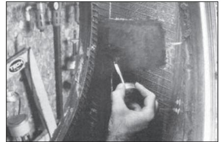
**50** Нанесите слой клея на обработанную поверхность от центра к краям. Дайте клею примерно 3–5 минут, чтобы он полностью высох.
