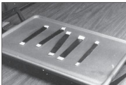
**26** Подготовьте сырую резину для использования. Нарежьте достаточное количество полосок резины для горячей вулканизации для заполнения повреждения. Предварительно нагрейте резину до температуры 49°–55°С.
