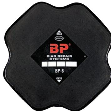
Для правильного выбора заплаты необходимо определить размер повреждения в шине, измерив в самом широком месте зону с удалённым кордом. Найдите размер повреждения в горизонтальной верхней строке таблицы. Затем определите несущую способность каркаса шины (показатель нагрузки) в левом столбце таблицы. Рекомендуемый размер заплаты находится в квадрате пересечения значений размера повреждения и несущей способности каркаса шины.
