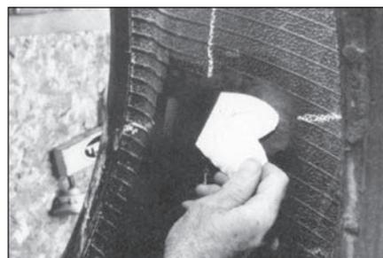
**38** Снимите с сырой резины защитную полиэтиленовую пленку.
