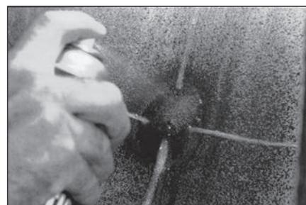
**6** Нанесите чистящую (обезжиривающую) жидкость № 704Е на отмеченную область покрышки с помощью атомайзера (распылителя).
