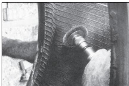
**20** Обработайте края пореза внутри шины с помощью текстурной проволочной щетки № S893 на низкооборотной дрели, чтобы придать им необходимую шероховатую текстуру.
