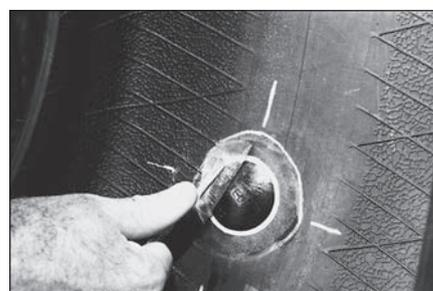
**23** Удалите прозрачную полиэтиленовую защитную пленку.
