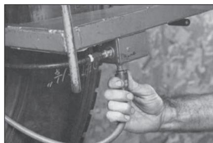
**36** После окончания процесса вулканизации отсоедините линию подачи воздуха и снимите вулканизатор с шины. Дайте шине остыть, а затем ножом срежьте с неё остатки непроваренной резины. Это обычно не требуется, если вы используете вулканизатор с пневмоподжимом.
