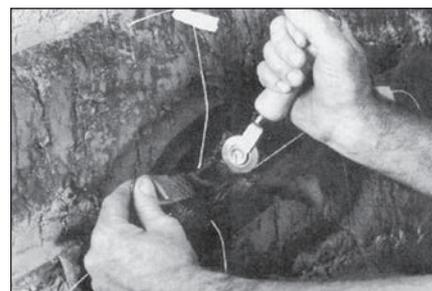
**81** С помощью раскатки № 936 закончите процесс заполнения воронки повреждения сырой резиной. Сырая резина должна выступать над поверхностью шины на 3–6 мм, чтобы на нее оказывалось равномерное давление.
