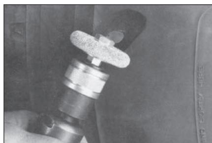
**17** С внешней стороны шины обработайте воронку повреждения шероховальным кругом RH308 на низкооборотной пневмодрели.
