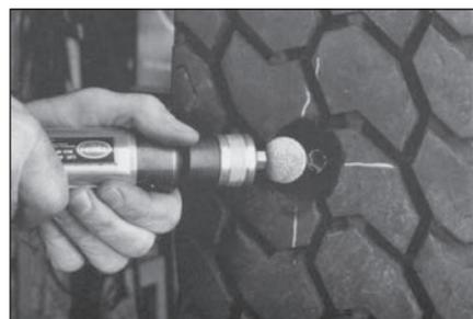
**12** Для получения необходимой текстуры обработайте воронку вокруг повреждения снаружи шины шероховальным шариком с зернистостью (230 SSG) на низкооборотной пневмодрели. Держите шерохователь под углом 45°.
