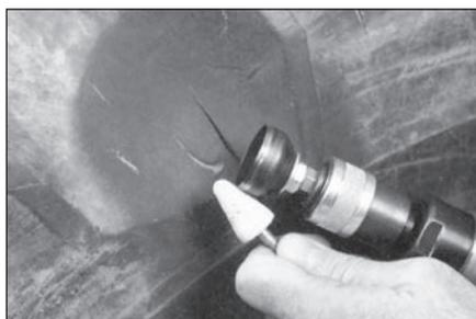
**9** С внешней стороны шины снимите верхний слой резины по периметру повреждения колпачковым обрезателем №S2045, установленным на низкооборотной дрели (максимальная скорость вращения 4000 об/мин). Затачивайте колпачковый обрезатель перед каждым применением.
