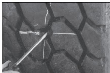
**4** Определите размер повреждения и возможное расслоение слоев корда с помощью спирального шила с тупым концом.
