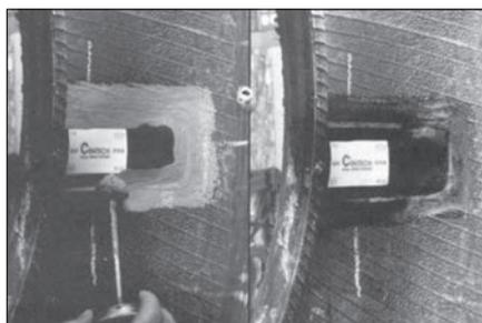
**55** Снимите прозрачную полиэтиленовую пленку с заплат. При ремонте бескамерной шины нанесите герметик заплат № 738 по периметру заплат и на оставшуюся обработанную поверхность. Если вы ремонтируете камерную шину, посыпьте отремонтированное место тальком № 736. Это предотвратит слипание серого слоя на краях заплат и камеры.
