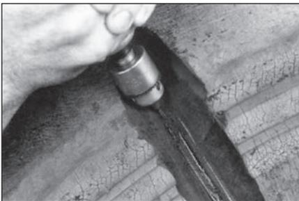
**13** Отрежьте с помощью алмазного бура № 283 на высокооборотной дрели (при минимальной скорости вращения 20 000 об/мин) концы поврежденных нитей металлокорда с одного края повреждения. Держите бур под углом 90° к нити корда.
