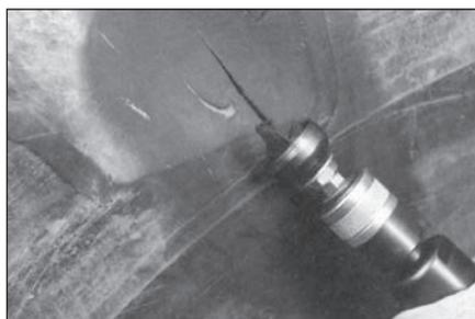
**10** Удалите резину в месте повреждения с внешней стороны шины колпачковым обрезателем №S2045, установленным на низкооборотной пневмодрели (максимальная скорость вращения 4000 об/мин).
