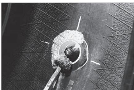
**24** При ремонте бескамерной шины нанесите специальный герметик №738 по периметру шляпки грибка и на оставшуюся обработанную поверхность. При ремонте камерной шины нанесите тальк во избежание слипания краев шляпки грибка и камеры.
