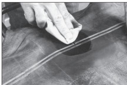
**5** Очистить область вокруг этого отверстия с помощью чистящей (обезжиривающей) жидкости №704E и ткани, не содержащей ворс.
