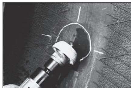
**8** Обработайте отмеченную область мелкозернистой абразивной полусферой RH102. Скорость вращения дрели при обработке не должна превышать 4000 об/мин. При работе необходимо использовать защитные очки № S918.
