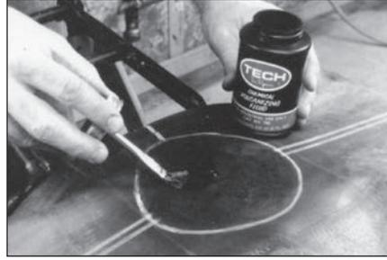
**11** Нанесите тонкий слой клея от центра ремонтируемой области к краям. Не наносите дополнительный слой клея, так как это только увеличит время его высыхания. Дайте клею примерно 3–4 минуты для того, чтобы он полностью высох.
