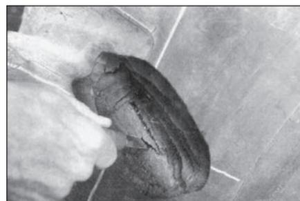
**12** Удалите все поврежденные нити корда специальным ножом №940. Корд должен удаляться под углом  $90^\circ$ . Закруглите края повреждения во избежание дальнейшего его увеличения.
