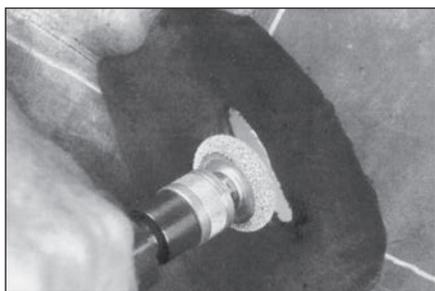
**16** Для получения более гладкой поверхности нужно обрабатывать повреждение среднезернистым шероховальным кругом RH308 на низкооборотной дрели. Если вы используете крупнозернистый круг в пункте 15, то пункт 16 можно не выполнять.
