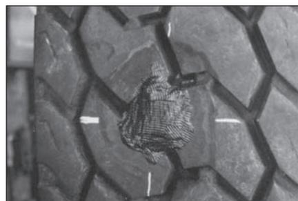
**30** Порез должен быть заполнен сырой резиной так, чтобы она выступала на 3–6 мм над поверхностью шины. Самая большая толщина слоя сырой резины должна находиться по центру поврежденного места и уменьшаться к его краям.
