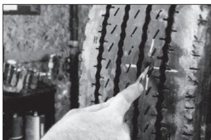
**4** Исследуйте повреждение с внешней и внутренней стороны шины. Проверьте глубину и угол прокола снаружи и изнутри.
