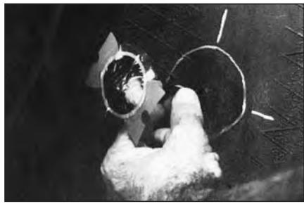
18 Удалите спиральное шило и установите грибок в повреждение с внутренней стороны шины.
