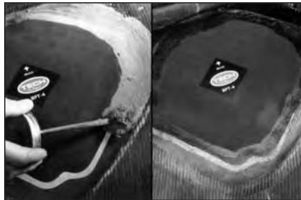
**55** При ремонте бескамерной шины нанесите герметик №738 по периметру заплаты и на оставшуюся обработанную поверхность. Если вы ремонтируете камерную покрышку, посыпьте отремонтированное место тальком №706. Это предотвратит слипание серого слоя на краях заплаты и камеры.
