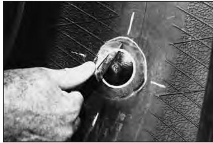
23 Удалите прозрачную полиэтиленовую защитную пленку.
