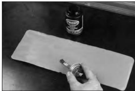
**54** Нанесите слой клея №760 для холодной вулканизации на всю заплату для улучшения процесса холодной вулканизации.
