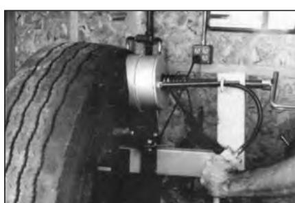
**42** Установите пневмоподжим на вулканизаторе, подсоединив линию подачи воздуха. Подайте давление воздуха не более 2 атм. Если вы используете ручной вулканизатор без пневмоподжима, то вам необходимо снова затянуть его через 5-10 минут после начала процесса вулканизации.
