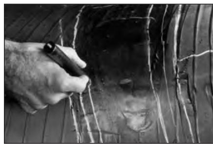
45 Для лучшего приклеивания заплаты к покрышке рекомендуется снять верхний слой резины на покрышке непосредственно под заплатой. Обведите область для шерохования на расстоянии 25 мм внутри линии периметра заплаты.
