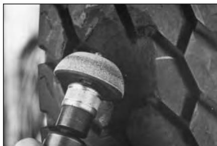
**51** Обработайте место ремонта покрышки снаружи мелкозернистой абразивной полусферой на низкооборотной пневмодрели (не более 4000 об/мин) так, чтобы поверхность покрышки стала ровной.
