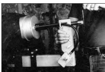
**41** Установите вулканизатор на покрышку, предварительно убедившись, что нагревательные элементы находятся по центру пореза снаружи и изнутри шины. Для точного расположения нагревательных элементов по центру используйте нарисованые восковым мелком линии.
