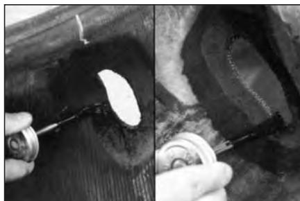
**25** Нанесите слой клея для холодной или горячей вулканизации на очищенное место повреждения изнутри и снаружи покрышки и дайте ему высохнуть.
