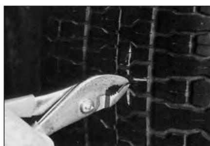
**17** Зажмите плоскогубцами металлический держатель с внешней стороны покрышки и вытяните ножку грибка. Если металлический держатель отделяется от ножки, когда ножка грибка выйдет из прокола, зажмите ее плоскогубцами и тяните до тех пор, пока подложка не коснется поверхности покрышки изнутри.
