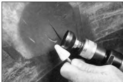
**9** Снимите верхний слой резины по периметру повреждения колпачковым обрезателем №S2045, установленным на низкооборотной дрели (максимальная скорость вращения 4000 об/мин). Затачивайте колпачковый обрезатель перед каждым применением.
