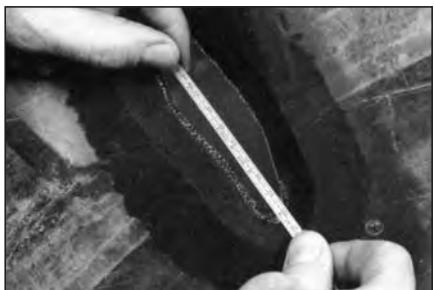
**21** Измерьте длину повреждения после обработки, чтобы определить необходимый размер заплаты ВР (BPT). Определите количество слоев корда в покрышке.
