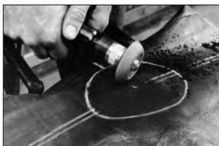
8 Обработайте ремонтируемую область механически. Это необходимо для удаления технологических неровностей и верхнего слоя поверхности камеры. Скорость вращения дрели при обработке не должна превышать 4000 об/мин. Используйте шлифовальную полусферу.
