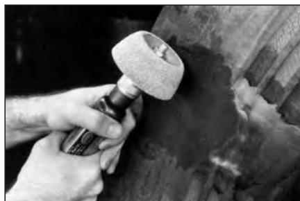
**61** Используя абразивную полусферу на низкооборотной дрели, снимите излишки резины с внешней стороны покрышки по направлению от центра к краям до получения ровной поверхности.
