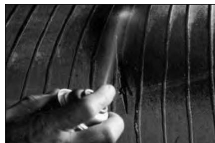
**6** Очистите место повреждения изнутри покрышки чистящей жидкостью №704Е с помощью атомайзера (распылителя) №975.
