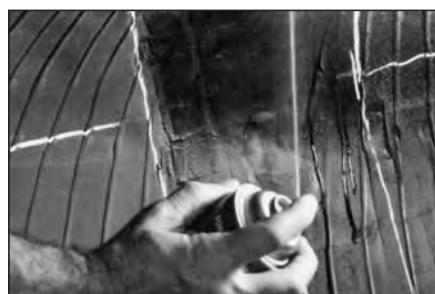
42 Нанесите чистящую жидкость №704E на обведенную область покрышки с помощью атомайзера (распылителя) №975.
