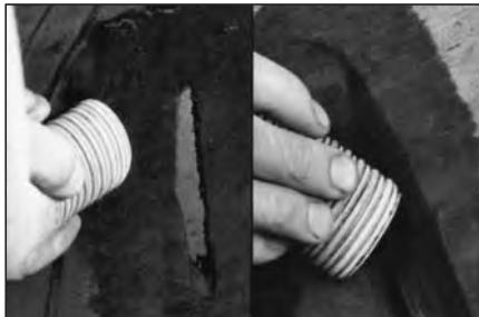
**28** Очистите пылесосом №S999 ремонтируемую поверхность от резиновой крошки снаружи и изнутри покрышки.
