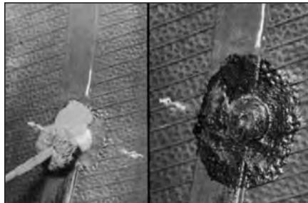
**20** При ремонте бескамерной покрышки нанесите герметик №738 по периметру шляпки грибка и на оставшуюся обработанную поверхность. При ремонте камерной покрышки нанесите тальк №706 во избежание слипания краев шляпки грибка и камеры.
