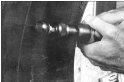
**10** Снимите верхний слой резины в месте повреждения с внешней стороны покрышки колпачковыми обрезателями, установленными на низкооборотной дрели (максимальная скорость вращения 4000 об/мин).
