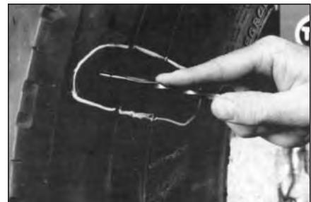
1 Внимательно осмотрите покрышку с внешней и внутренней стороны, найдите повреждения, чтобы определить, подлежит ли она ремонту (см. приложение). Зона осмотра должна быть хорошо освещена.
