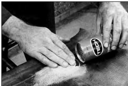
**13** Удалите прозрачную полиэтиленовую пленку с заплаты и посыпьте отремонтированное место тальком №706. Это предотвратит прилипание серого слоя заплаты к внутренней стороне покрышки. После этого камера готова к эксплуатации.
