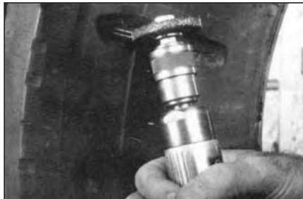
**11** Удалите оставшуюся резину между нитями корда с помощью металлощетки в полиуретане №S890 на низкооборотной дрели. Обработайте порез так, чтобы обнажились только те нити корда, которые повреждены по всей длине пореза. При этом металлощетки в полиуретане не повреждают нити корда.
