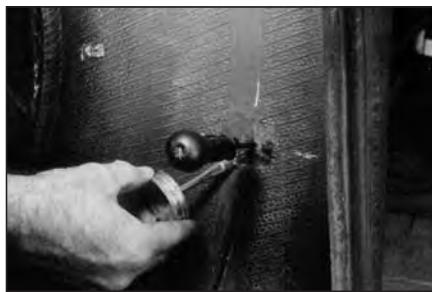
**14** Нанесите клей для химической вулканизации №760 на обработанную поверхность. Дайте клею примерно 3-4 минуты для того, чтобы он полностью высох. При ремонте камерной покрышки обработайте область до синтетических нитей корда, нанесите на нее 2 слоя клея. При работе в помещении с высокой влажностью или низкой температурой необходимо увеличить время высыхания клея.
