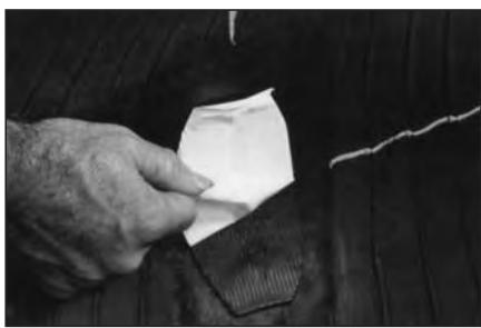
37 Снимите защитную пленку с платформы сырой резины изнутри покрышки.
