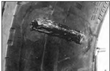
**38** Порез должен быть заполнен сырой резиной так, чтобы она выступала на 3-6 мм над поверхностью покрышки. Самая большая толщина слоя сырой резины должна находиться по центру поврежденного места и уменьшаться к его краям.
