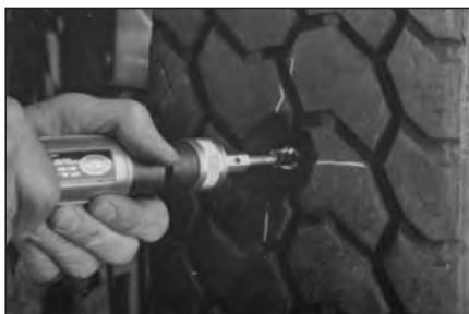
**13** Обработайте края пореза снаружи покрышки короткой проволочной щеткой №S896 на низкооборотной дрели, чтобы придать им необходимую шероховатую текстуру, так как происходит пригорание резины при использовании инструмента на высокогооборотной дрели. Держите щетку под углом 90°.
