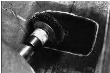
**17** Удалите частицы резины на обработанной области с помощью мягкой проволочной щетки №893 и низкооборотной дрели. При этом двигайтесь справа налево.
