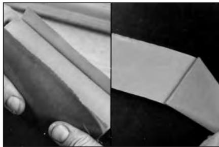
**53** Разорвите перфорацию на синей защитной пленке и полностью снимите ее. Важно не касаться серого слоя руками!
