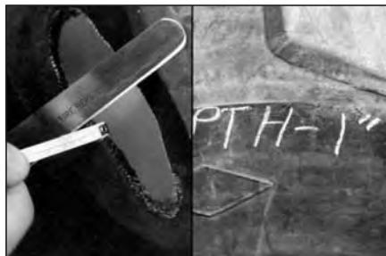
**20** Для определения времени вулканизации вам необходимо знать толщину шины в месте повреждения. Измерьте максимальную глубину пореза. Напишите размеры на внешней стороне покрышки для дальнейшего использования. Не измеряйте глубину повреждения под углом 45°.
