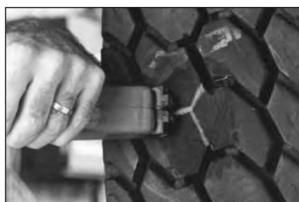
**53** Нарежьте канавки с помощью регувера №1571631 (S146B) для нарезки протектора. Глубина нарезки должна совпадать с глубиной уже существующих канавок.
