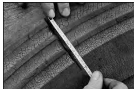
**3** Определите длину и ширину повреждения для определения ремонтопригодности. Если есть скрытые повреждения, прибавьте их размер.
