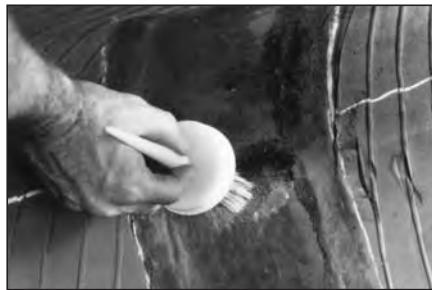
**52** Нанесите клей №760 для холодной вулканизации на всю обработанную область, двигаясь от центра к краям. Дайте kleю высохнуть в течение 3–5 минут.
