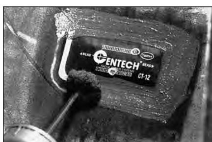
**25** При ремонте бескамерной покрышки нанесите специальный герметик №738 по периметру заплаты и на оставшуюся обработанную поверхность. При ремонте камерной покрышки нанесите тальк №706 во избежание слипания краев заплаты и камеры.
