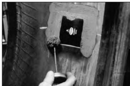
25 При ремонте бескамерной покрышки нанесите герметик №738 по периметру шляпки грибка и на оставшуюся обработанную поверхность. При ремонте камерной покрышки нанесите тальк во избежание слипания краев шляпки грибка и камеры.
