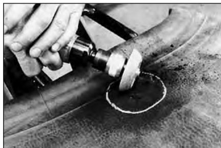
6 Обработайте ремонтируемую область для удаления технологических неровностей и верхнего слоя камеры. Скорость вращения дрели при обработке не должна превышать 4000 об/мин. Используйте шлифовальную полусферу.
