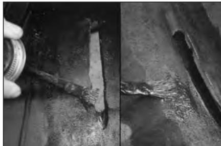
**29** Нанесите слой клея для холодной или горячей вулканизации на всю обработанную область вокруг повреждения изнутри и снаружи покрышки и дайте ему высохнуть.
