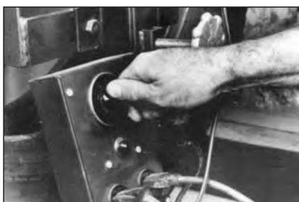
**43** Установите таймер, используя расчетное время вулканизации.
