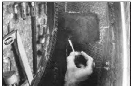
**51** Нанесите слой клея на обработанную поверхность от центра к краям. Дайте клею примерно 3-5 минут, чтобы он полностью высох.
