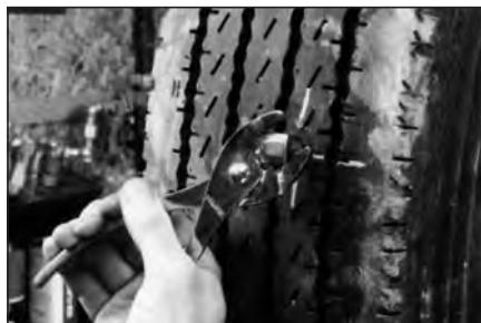
1 Внимательно осмотрите покрышку с внешней и внутренней стороны, чтобы определить ее ремонтопригодность (см. приложение).
