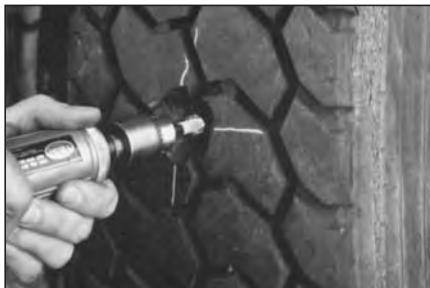
**10** Используя камень из оксида алюминия №S872 на высокогооборотной пневмодрели, обработайте все распустившиеся нити стального корда до самой резины в месте повреждения. При этом действуйте с перерывами, чтобы резина не подгорала.
