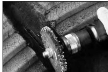
**9** Удалите снаружи покрышки оставшуюся резину между нитями корда металлощеткой в резиновой оболочке №S897 на низкооборотной дрели. Обработайте порез так, чтобы обнаружились только те нити корда, которые повреждены по всей длине пореза. При этом металлощетки в резиновой оболочке не повреждают нити корда.
