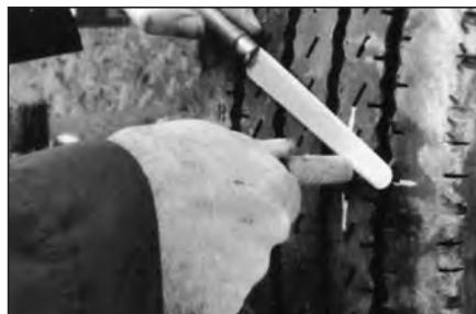
26 Отрежьте выступающую часть ножки грибка бровень с поверхностью покрышки. Если ножка закрывает канавку рисунка протектора, вы можете нарезать протектор заново в месте ремонта.
