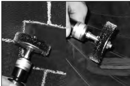
28 Очистите место повреждения мягкой проволочной щеткой на низкоботоротной дрели с последующей очисткой пылесосом.
