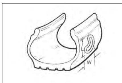
**24** На данном рисунке показано, как правильно измерять размеры повреждения. Длина измеряется по вертикали в направлении от борта до борта, а ширина по горизонтали параллельно беговой дорожке.
