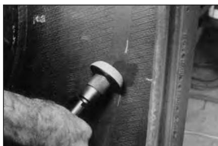
7 Нанесите чистящую (обезжикивающую) жидкость на отмеченную область покрышки с помощью атомайзера (распылителя).
