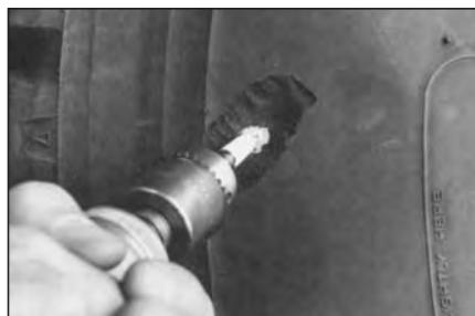
**15** Обработайте концы металлокорда камнем из оксида алюминия №S872 на высокогооборотной дрели.
