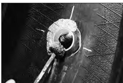
24 При ремонте бескамерной покрышки нанесите специальный герметик №738 по периметру шляпки грибка и на оставшуюся обработанную поверхность. При ремонте камерной покрышки нанесите тальк во избежание слипания краев шляпки грибка и камеры.
