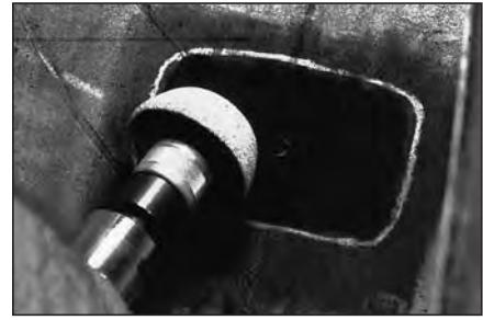
**16** Обработайте выступающую часть ножки, а затем отмеченную область мелкозернистой абразивной полусферой. Скорость вращения дрели при обработке не должна превышать 4000 об/мин.
