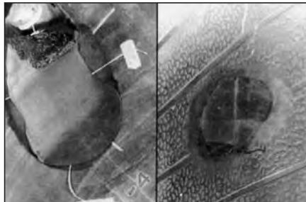
**38** По окончании вулканизации снимите вулканизатор и дайте покрышке остить до комнатной температуры.
