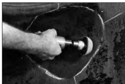
**45** Обработайте отмеченную область до ровной поверхности мелкозернистой абразивной полусферой на низко-оборотной дрели со скоростью вращения не более 4000 об/мин. Это необходимо для увеличения площади соприкосновения заплаты с покрышкой.
