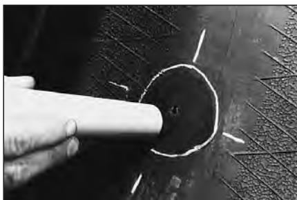
12 Очистите пылесосом №S999 обработанную область для удаления металлической стружки и резиновой пыли.
