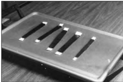
**26** Подготовьте сырую резину для использования. Нарежьте достаточное количество полосок резины для горячей вулканизации для заполнения повреждения. Предварительно нагрейте резину до температуры 49°- 55°C.
