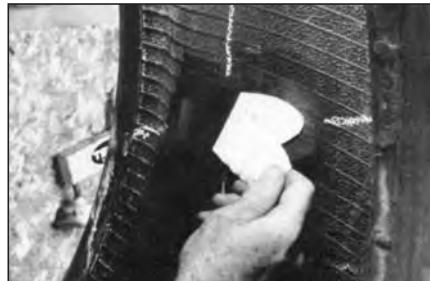
**39** Снимите с сырой резины защитную полиэтиленовую пленку.
