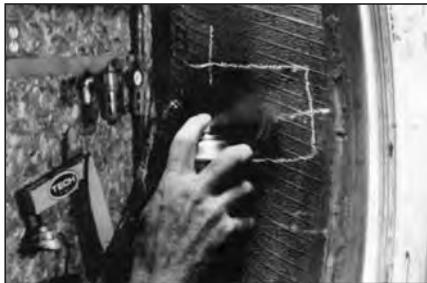
**46** Нанесите чистящую жидкость №704E с помощью атомайзера №975 на отмеченную область покрышки.
