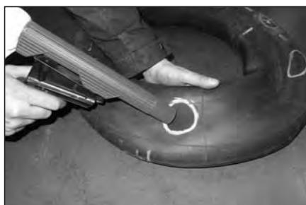
8 Очистите пылесосом №S999 обработанную область для удаления металлической стружки и резиновой пыли.
