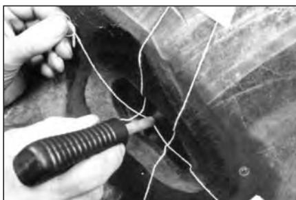
**29** Положите в область пореза с внешней стороны покрышки х/б нити для вентиляции, чтобы снять давление с корда (внутри поврежденной части корда покрышки при вулканизации накапливается воздух). Закрепите пластирем концы нитей на расстоянии 75 мм от краев повреждения.
