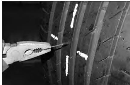
20 Вытяните ножку грибка плоскогубцами за металлический стержень, пока он не встанет на место. При этом проверьте совпадение направления стрелки к ободу.
