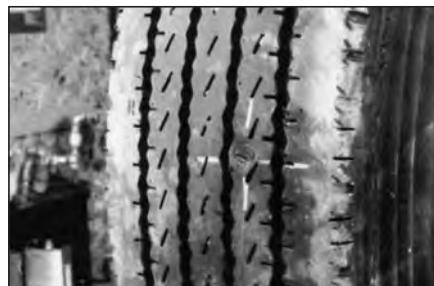
27 Ремонт завершен. Шина готова к эксплуатации.
