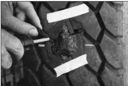
**31** Канавки протектора в месте ремонта заполните кусочками резины, чтобы сырья резина в процессе вулканизации не растекалась по рисунку протектора и не вулканизировала его. Если канавка большая, можно использовать гипс или алюминиевую фольгу в качестве блокирующего материала.
