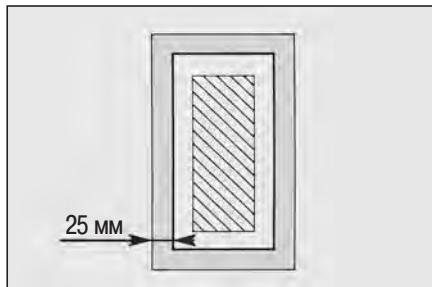
**46** На рисунке область снятия верхнего слоя резины заштрихована. Средняя жирная линия – это períметр заплаты. Внешняя линия на расстоянии 25 мм от линии períметра заплаты ограничивает область шерохования.
