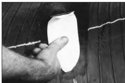
**32** Вырежьте платформу из сырой резины толщиной 3 мм и размером на 25 мм больше, чем размеры обработанного повреждения внутри покрышки. Расположите платформу по центру повреждения и прижмите ее большим пальцем.
