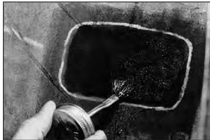
**19** Нанесите клей для химической вулканизации №760 на обработанную поверхность. Дайте kleю примерно 3-4 минуты для того, чтобы он полностью высох. При ремонте камерной покрышки обработайте область до синтетических нитей корда, нанесите на нее 2 слоя клея и увеличьте время высыхания вдвое.
