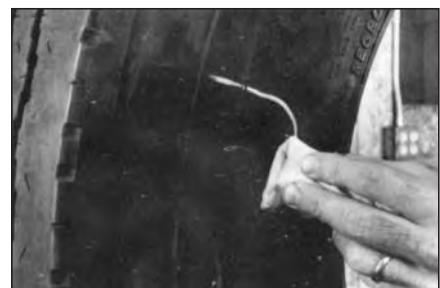
7 Если покрышка подлежит ремонту, нанесите чистящую жидкость №704Е на отмеченную область покрышки с помощью атомайзера (распылителя) №975.
