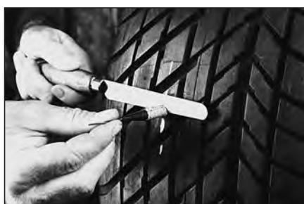
25 Отрежьте выступающую часть ножки грибка на 3 мм выше уровня поверхности покрышки.
