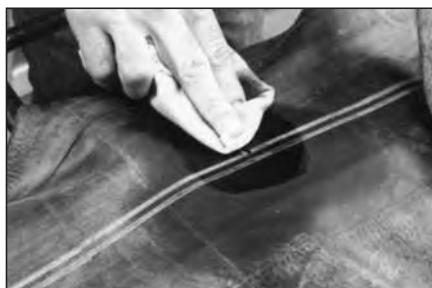
5 Очистите ремонтируемую область с помощью чистящей (обезжирающей) жидкости №704Е и ткани, не содержащей ворса.
