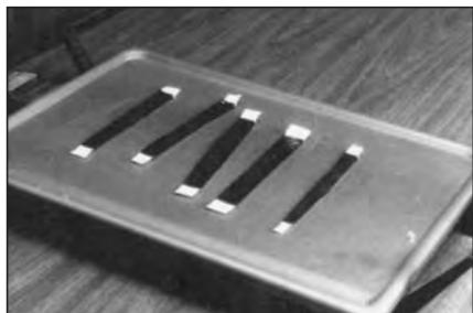
32 Нарежьте достаточное количество полос из сырой резины толщиной 3 мм, чтобы заполнить обработанный порез. Предварительно положите полоски резины на нагревательный стол и нагрейте примерно до 49°-55°C.
