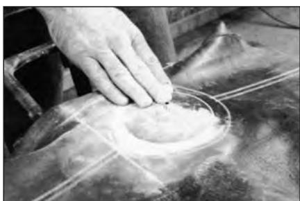
**16** Удалите прозрачную полиэтиленовую пленку с подложки и посыпьте отремонтированное место тальком №706. Это предотвратит прилипание серого слоя подложки к внутренней поверхности покрышки.
