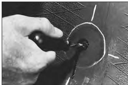
13 Нанесите клей №760 для химической вулканизации внутрь прокола и по всей его длине с помощью спирального шила №915. Поворачивайте шило по часовой стрелке. Повторите эту процедуру от 3 до 5 раз. Оставьте шило в проколе до тех пор, пока не перейдете к выполнению пункта 18.
