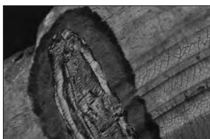
**36** Порез должен быть заполнен сырой резиной так, чтобы она выступала на 6-9 мм над поверхностью покрышки. Максимальная толщина слоя сырой резины должна находиться по центру поврежденного места и уменьшаться к его краям.
