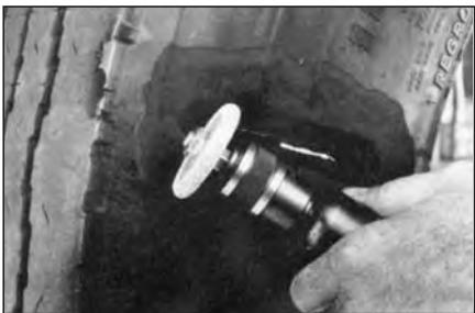
**19** Обработайте покрышку с внешней стороны по периметру на ширину 40 мм вокруг повреждения шероховальным кругом с зернистостью (230 SSG) или мелкозернистой абразивной полусферой на низкооборотной дрели.
