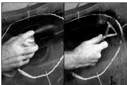
**44** Нанесите чистящую жидкость №704Е на отмеченную область изнутри покрышки с помощью атомайзера (распылителя) №975. Пока отмеченная область еще влажная, удалите грязь скребком №933.
