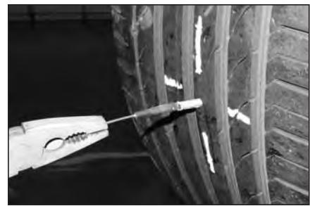
**13** Зажмите плоскогубцами металлический стержень с внешней стороны покрышки и вытяните ножку грибка, пока серый слой резины не будет выступать на 15 мм с внешней стороны покрышки.
