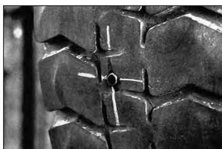
26 Ремонт завершен. Шина готова к эксплуатации.
