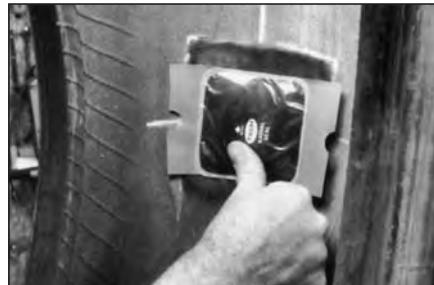
21 Как только грибок установлен на место, нажмите на шляпку грибка большим пальцем и прижмите его к шине.
