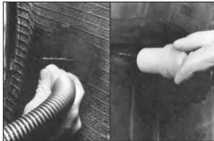
29 Очистите пылесосом №S999 обработанную область для удаления металлической стружки и резиновой пыли с внутренней и внешней стороны покрышки.
