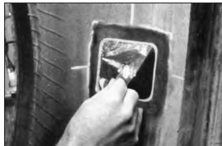
24 Удалите прозрачную полиэтиленовую защитную пленку.
