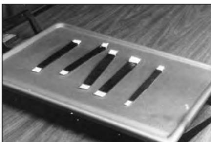
**26** Подготовьте сырую резину для использования. Нарезьте достаточное количество полосок резины для горячей вулканизации для заполнения повреждения. Предварительно нагрейте резину до температуры 49° - 55°С.
