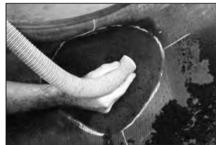
**46** Очистите пылесосом №S999 обработанную область для удаления металлической стружки и мелких частиц резины.
