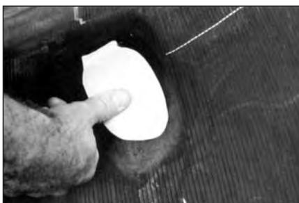
**27** Вырежьте платформу из сырой резины толщиной 3 мм и по ширине на 25 мм больше, чем размеры обработанного повреждения. Расположите ее с внутренней стороны покрышки строго по центру повреждения. Прижмите эту платформу большим пальцем.
