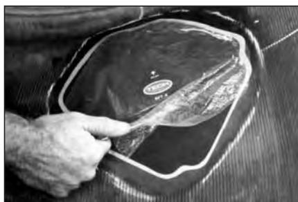
**54** Удалите прозрачную полиэтиленовую пленку с заплата.
