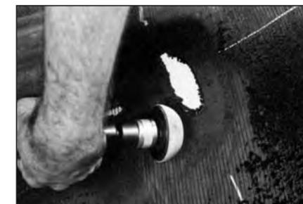
**17** Нарисуйте восковым мелком линии под прямым углом по центру повреждения изнутри покрышки для дальнейшей центровки заплатки по ним. Обработайте периметр вокруг повреждения на ширину 40 мм мелкозернистой абразивной полусферой на низкооборотной дрели. Вы должны получить ровную платформу для вулканизационной резины.
