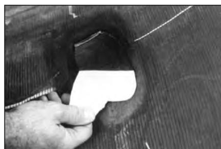
**34** Снимите с сырой резины защитную полиэтиленовую пленку.
