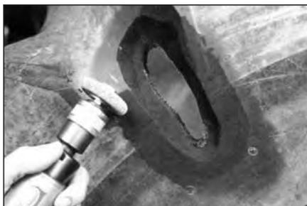
**15** Обработайте с внешней стороны покрышки область вокруг повреждения по периметру на ширину 40 мм шероховальным кругом с зернистостью (230 SSG) или мелкозернистой абразивной полусферой на низкооборотной дрели (максимальная скорость вращения 4000 об/мин).
