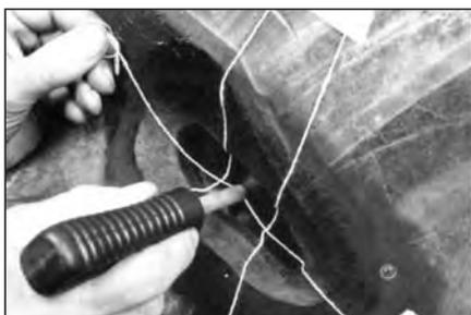
**29** Положите в область пореза с внешней стороны покрышки х/б нити для вентиляции, чтобы снять давление с корда (внутри поврежденной части корда покрышки при вулканизации накапливается воздух). Закрепите пластырем концы нитей на расстоянии 75 мм от краев повреждения.
