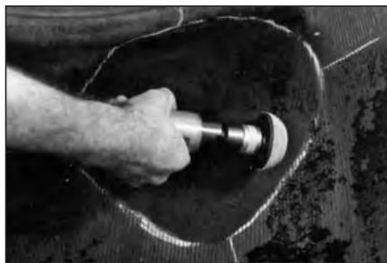
**45** Обработайте отмеченную область до ровной поверхности мелкозернистой абразивной полусферой на низкооборотной дрели со скоростью вращения не более 4000 об/мин. Это необходимо для увеличения площади соприкосновения заплатки с покрышкой.
