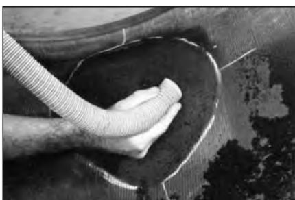
**48** Очистите пылесосом №S999 обработанную область для удаления металлической стружки и мелких частиц резины.
