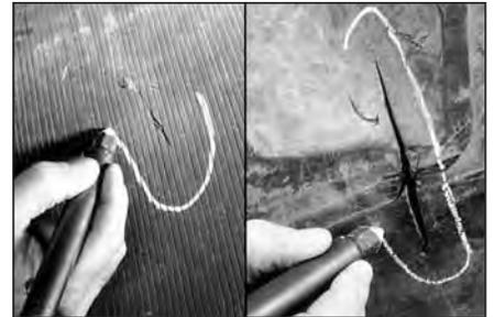
**3** При осмотре найдите и отметьте восковым маркировочным мелком №951 все повреждения изнутри и снаружи покрышки.
