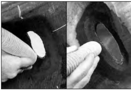
**18** Очистите вакуумным пылесосом №S999 обработанную область, чтобы удалить частицы резины и резиновую пыль с внутренней и внешней стороны покрышки.
