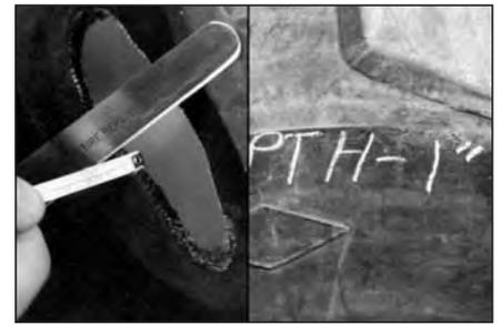
**20** Для определения времени вулканизации вам необходимо знать толщину шины в месте повреждения. Измерьте максимальную глубину пореза. Напишите размеры на внешней стороне покрышки для дальнейшего использования. Не измеряйте глубину повреждения под углом 45°.
