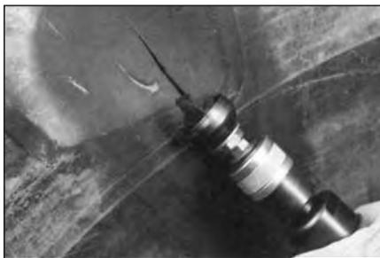
**10** Удалите резину в месте повреждения с внешней стороны покрышки колпачковым обрезателем №S2045, установленным на низкооборотной пневмодрели (максимальная скорость вращения 4000 об/мин). Также вы можете использовать шейм с зернистостью (390 SSG).
