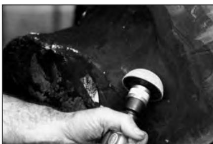
**56** Используя мелкозернистую абразивную полусферу на низкооборотной дрели, обработайте место ремонта покрышки снаружи так, чтобы оно стало вровень с остальной поверхностью покрышки.
