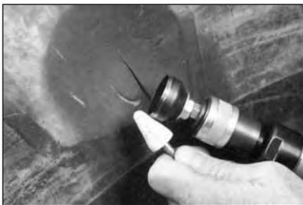
**9** Снимите верхний слой резины по периметру повреждения колпачковым обрезателем №S2045, установленным на низкооборотной дрели (максимальная скорость вращения 4000 об/мин). Заточивайте колпачковый обрезатель перед каждым применением.
