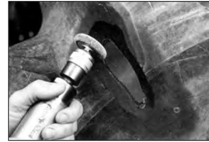
**14** Обработайте края повреждения под углом 45°, используя шероховальный круг с зернистостью (230 SSG) на низкооборотной дрели (максимальная скорость вращения 4000 об/мин). Это нужно для получения нужной текстуры резины в месте повреждения.
