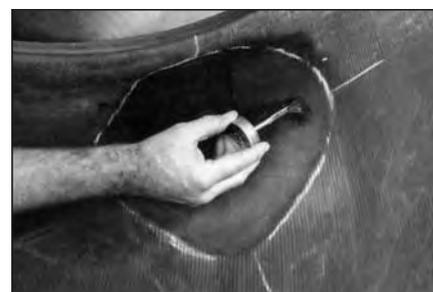
**49** Нанесите слой клея №760 для холодной вулканизации на обработанную поверхность. Дайте клею примерно 3-5 минут для того, чтобы он полностью высох. Если ремонтируемая область камерной покрышки обработана до синтетических нитей корда, нанесите на нее 2 слоя клея и увеличьте время высыхания вдвое.
