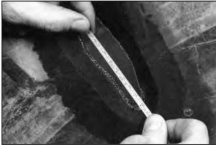
**21** Измерьте длину повреждения после обработки, чтобы определить необходимый размер заплаты ВР (ВРТ). Определите количество слоев корда в покрышке.
