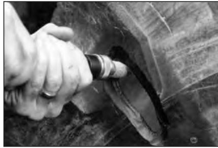
**13** Шерохователем типа "карандаш" с мелкой зернистостью (230 SSG), установленным на низкооборотной дрели (максимальная скорость вращения 4000 об/мин), обработайте основание повреждения и закруглите его концы, чтобы оно не увеличилось после ремонта.
