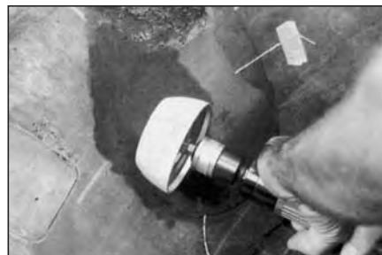
**58** Механически обработайте область повреждения с наружной стороны покрышки шероховальной полусферой до получения ровной поверхности на одном уровне с первоначальной поверхностью покрышки. При этом полусфера должна вращаться в направлении от центра повреждения к краю. Это позволит отремонтированной области иметь такую же гибкость, как и вся покрышка.
