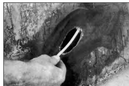
**61** Измерьте максимальную длину зоны повреждения корда, чтобы определить размер повреждения. Определите число слоев корда в покрышке и выберите заплату по таблице TOR (см. приложение).
