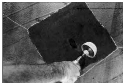
**67** Среднезернистой или мелкозернистой полусферой на низкооборотной дрели обработайте каландровый слой резины до получения бархатной текстуры. Затем сформируйте наклон по направлению к первоначальному контуру заплаты. После этого слегка обработайте поверхность покрышки изнутри за пределами контура заплаты.
