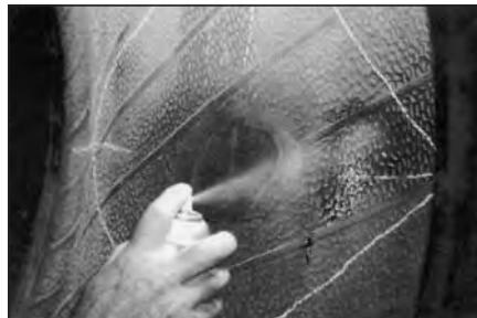
**40** Очистите обведенную область изнутри покрышки чистящей жидкостью №704Е с помощью атомайзера (распылителя) №975.
