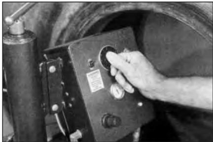
**37** Подайте давление на вулканизатор и установите на таймере время вулканизации. Не оставляйте включенный вулканизатор без присмотра.
