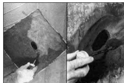
**70** Нанесите ровный слой клея №1082 для горячей вулканизации вокруг повреждения с наружной и внутренней стороны покрышки и дайте ему высохнуть в течение 15 минут или более во влажных условиях. Удваивайте время высыхания при нанесении клея на поврежденный корд. Если вы используете клей №760 для холодной вулканизации, дайте ему высохнуть в течение 3-5 минут. На поврежденный корд нужно наносить 2 слоя клея.
