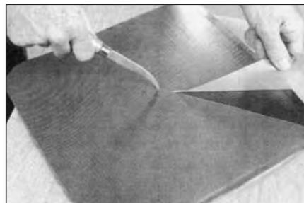
74 Слегка согните заплату и разрежьте защитное покрытие в направлении, противоположном стрелке, указывающей на борт. Снимите защитное покрытие, чтобы обнажить 75-100 мм сырой резины.
