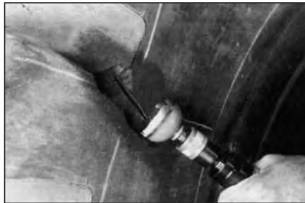
11 Удалите резину в месте повреждения с внешней стороны покрышки колпачковым обрезателем №S2045, установленными на низкооборотной пневмодрели (максимальная скорость вращения 4000 об/мин).
