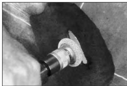
16 Для получения более гладкой поверхности нужно обрабатывать повреждение среднезернистым шероховальным кругом на низкооборотной дрели. Если вы используете крупнозернистый круг в пункте 15, то пункт 16 можно не выполнять.
