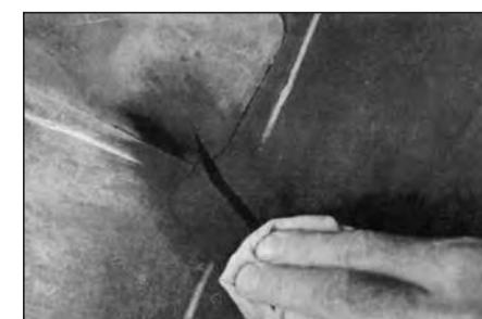
**9** Нанесите обезжирающую (чистящую) жидкость на ткань, не содержащую ворс, и очистите место повреждения с наружной стороны покрышки, двигаясь от центра ремонтируемой области к краям. Повторите эту процедуру 2-3 раза для хорошей очистки поверхности. Чистящая (обезжирающая) жидкость должна полностью высохнуть.
