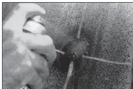
6 Нанесите чистящую (обезжирающую) жидкость № 704 на отмеченную область покрышки с помощью атомайзера (распылителя).
