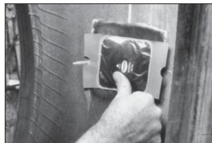
**24** Как только грибок установлен на место, нажмите на шляпку грибка большим пальцем и прижмите его к шине.
