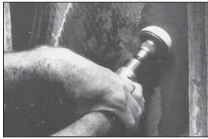
**41** Обработайте отмеченную область мелкозернистой абразивной полу-сферой на низкооборотной дрели до получения ровной шероховатой поверхности. Это необходимо для увеличения площади соприкосновения заплаты с покрышкой.
