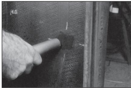
10 Очистите пылесосом № S999 обработанную область для удаления металлической стружки, мелких частиц резины и резиновой пыли.
