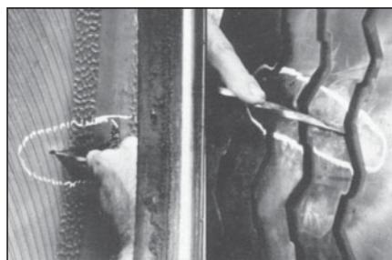
**5** Исследуйте повреждение с внешней и внутренней стороны покрышки с помощью спирального шила, чтобы определить размер повреждения и возможное расслоение слоев корда.
