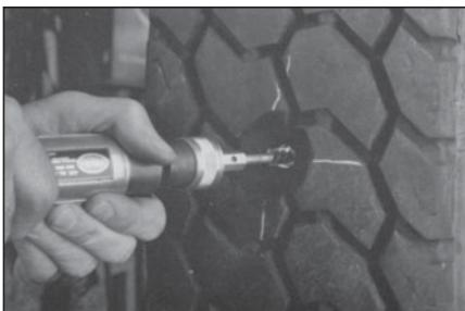
**13** Обработайте края пореза снаружи покрышки короткой проволочной щёткой № S896 на низкооборотной дрели, чтобы придать им необходимую шероховатую текстуру, так как происходит пригорание резины при использовании инструмента на высокооборотной дрели. Держите щётку под углом 90°.
