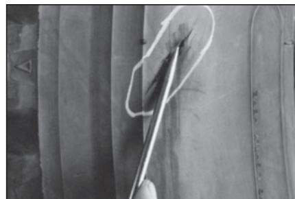
**1** Внимательно осмотрите покрышку с внешней и внутренней стороны, найдите повреждения, чтобы определить, подлежит ли она ремонту (см. приложение). Зона осмотра должна быть хорошо освещена.
