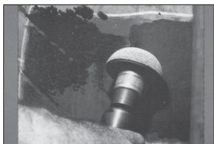
39 Обработайте отмеченную область мелкозернистой абразивной полу-сферой на низкооборотной дрели (не более 5000 об/мин) до получения ровной поверхности. Это необходимо для увеличения площади соприкосновения заплаты с покрышкой.
