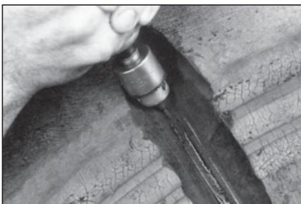
**13** Отрежьте с помощью алмазного бура № 283 на высокогооборотной дрели (при минимальной скорости вращения 20 000 об/мин) концы поврежденных нитей металлокорда с одного края повреждения. Держите бур под углом 90° к нити корда.
