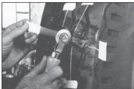
**31** Заполните обработанную область таким образом, чтобы сырья резина выступала примерно на 3-6 мм над поверхностью покрышки (больше всего над центром обработанной области).
