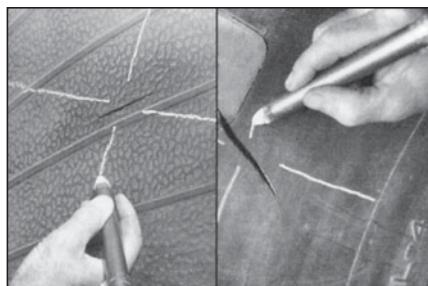
**2** При осмотре найдите и отметьте все повреждения изнутри и снаружи покрышки длинными линиями, пересекающимися под прямым углом. Это поможет потом отцентрировать по ним вулканизатор и заплату.
