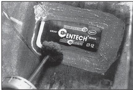
**28** При ремонте бескамерной покрышки нанесите специальный герметик № 738 по периметру заплаты и на оставшуюся обработанную поверхность. При ремонте камерной покрышки нанесите тальк № 706 во избежание сlipания краев заплаты и камеры.
