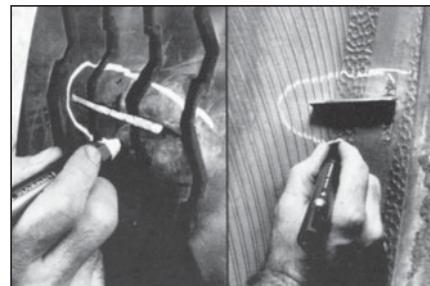
**3** Обозначьте место повреждения покрышки с внешней и внутренней стороны восковым маркировочным мелком № 951.
