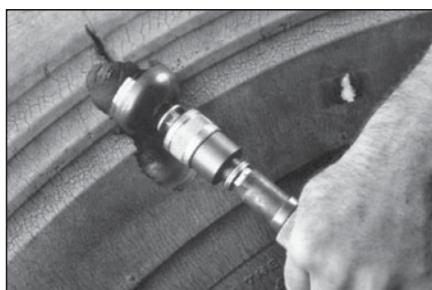
**8** Удалите резину в месте повреждения с внешней стороны покрышки колпачковым обрезателем № S2045, установленными на низкооборотной дрели (максимальная скорость вращения 5000 об/мин).
