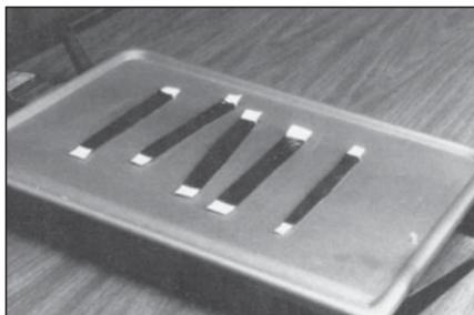
**28** Нарежьте достаточное количество полос из сырой резины толщиной 3 мм, чтобы заполнить обработанный порез. Предварительно положите полоски резины на нагревательный стол и нагрейте примерно до 49°-55°C.
