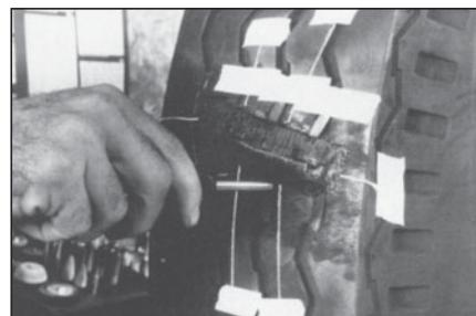
**32** Канавки протектора в месте ремонта заполните кусочками резины, чтобы сырья резина в процессе вулканизации не растекалась по рисунку протектора и не вулканизировала его. Если канавка большая, можно использовать гипс в качестве блокирующего материала.
