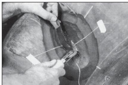
32 Заполняйте до того момента, когда можно использовать раскатку, прокатайте сырую резину так, чтобы повреждение было заполнено до уровня 3-6 мм над поверхностью покрышки. При подготовке повреждения в плечевой области или в зоне протектора нужно сделать перемычку в канавке протектора, чтобы резина не вытекала при вулканизации. Перемычки можно делать из частиц резины, остающихся при шероховке, из алюминиевой фольги или алебастра.
