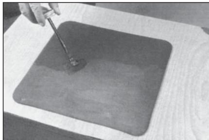
72 Нанесите слой клея для горячей вулканизации на заднюю сторону заплаты и дайте ему высохнуть в течение 15 минут или более при повышенной влажности. После высыхания клея снова наложите защитное покрытие на заплату.
