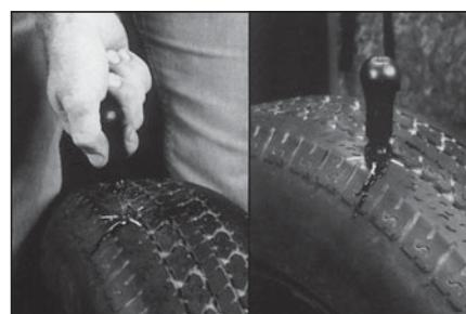
6 Поместите спиральное шило в повреждение и, вращая по часовой стрелке, промажьте прокол kleem по всей глубине. Затем, вращая спиральное шило по часовой стрелке, удалите его из покрышки. Убедитесь в том, что правильно определили угол прокола, так как возможно дополнительное повреждение шины. Данный пункт следует повторить, как минимум, 3 раза. Оставьте спиральное шило в проколе до выполнения пункта № 11 настоящей инструкции.
