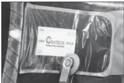
35 Тщательно прикатайте центральную часть заплаты раскаткой № 936 от середины к краям. Нажимайте на раскатку для обеспечения более плотного прилегания заплаты к покрышке.
