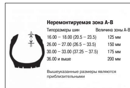
**5** По таблице по выбору заплат TOR (см. приложение) посмотрите размер неремонтируемой зоны покрышки и, используя измерения из предыдущего пункта, определите, находится ли повреждение в пределах этой зоны.
