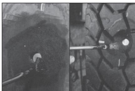
**23** Нанесите слой клея для холодной или горячей вулканизации на всю обработанную область вокруг повреждения внутри и снаружи покрышки и дайте ему высохнуть.
