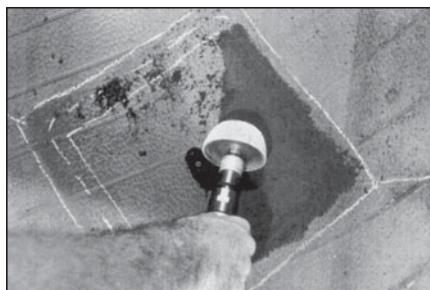
**66** Крупнозернистой полусферой на низкооборотной дрели снимите верхний бутиловый слой резины в пределах внутренней сплошной отмеченной линии. При этом полусфера всегда должна вращаться в одну сторону по поверхности, что предотвратит задирание бутилового слоя резины. Обрабатывайте бутиловый наружный слой резины до тех пор, пока под ним не появится внутренний слой каландровой резины. Вы заметите его появление по изменению цвета. Он более чёрный.
