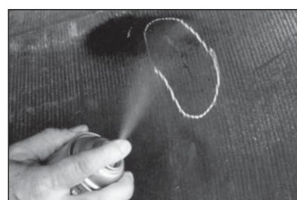
**7** Очистите место повреждения на внутренней поверхности покрышки чистящей жидкостью № 704 с помощью атомайзера (распылителя) № 975 .
