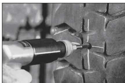
9 Обработайте прокол с помощью карбидной фрезы с внешней стороны покрышки. Повторите эту процедуру три раза. Очистите пылесосом обработанную область для удаления металлической стружки и резиновой пыли.
