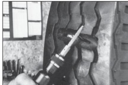
**12** При ремонте повреждения на беговой дорожке обработайте канавки протектора тем же шерохователем типа "карандаш" на низкооборотной дрели для лучшей адгезии сырой резины при последующей вулканизации.
