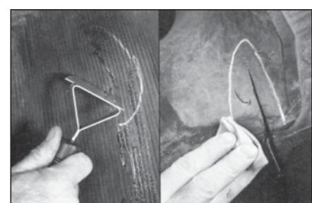
**8** Пока отмеченная область еще влажная, удалите грязь скребком № 933. Нанесите чистящую жидкость на ткань не содержащую ворса и очистите место повреждения. Дайте чистящей жидкости 3-5 минут, чтобы полностью высохнуть.
