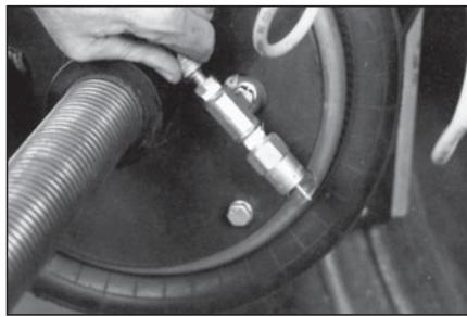
**36** Установите пневмоподжим на вулканизаторе, подсоединив линию подачи воздуха. Подайте давление воздуха не более 2 атм. Если Вы используете ручной вулканизатор без пневмоподжима, то Вам необходимо снова затянуть его через 5-10 минут после начала процесса вулканизации.
