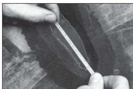
**20** Измерьте длину повреждения после обработки, чтобы определить необходимый размер заплаты ВР. Определите количество слоев корда в покрышке.
