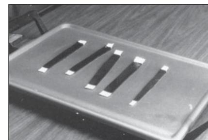
**25** Подготовьте сырую резину для использования. Нарежьте достаточное количество полосок резины для горячей вулканизации для заполнения повреждения. Предварительно нагрейте резину до температуры 49°- 55°C.
