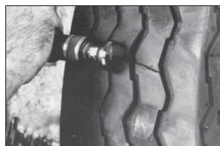
**9** Удалите резину с внешней стороны шины в месте повреждения колпачковыми обрезателями № S2045, установленными на низкооборотной дрели (максимальная скорость вращения 5000 об/мин) до появления корда.
