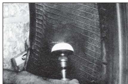
**18** Обработайте покрышку с внутренней стороны по периметру на ширину 40 мм вокруг повреждения мелкозернистой абразивной полусферой на низкооборотной дрели. Вы должны получить ровную платформу для вулканизационной резины.
