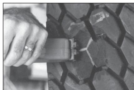
**52** Нарежьте канавки с помощью регрувера № S145 для нарезки протектора. Глубина нарезки должна совпадать с глубиной уже существующих канавок.
