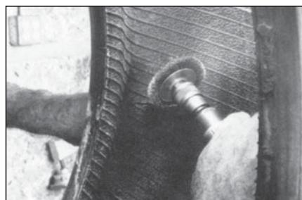
**17** Обработайте края пореза внутри покрышки с помощью текстурной проволочной щётки № S893 на низкооборотной дрели, чтобы придать им необходимую шероховатую текстуру.
