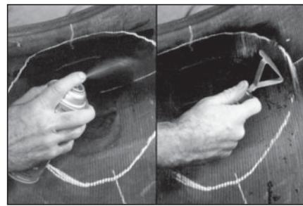
**43** Нанесите чистящую жидкость № 704 на отмеченную область изнутри покрышки с помощью атомайзера (распылителя) № 975. Пока отмеченная область еще влажная, удалите грязь скребком № 933.
