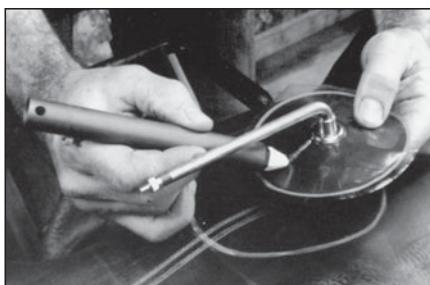
7 Плотно прикрутите новый вентиль к подложке и мелом отметьте на ней направление вентиля для правильной установки подложки и предотвращения возможной утечки воздуха в дальнейшем.
