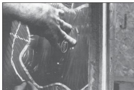
**38** Используя нарисованные Вами линии изнутри покрышки (см. пункт 21), приложите заплату, выбранную заранее (см. пункт 18) на повреждение по центру. Обведите заплату по периметру маркировочным мелком примерно на 25 мм больше размеров заплаты. Это будет область для механической обработки шероховкой.
