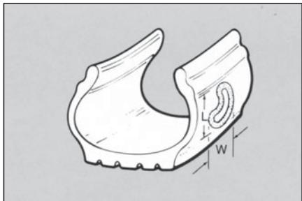
**22** Этот рисунок показывает, как правильно измерять размеры повреждения на радиальной шине. Длину измеряют от борта к борту по вертикали, ширину – в направлении движения шины по горизонтали. Измерение ширины важнее, так как она определяет количество повреждённых нитей корда.
