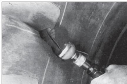
**11** Удалите резину в месте повреждения с внешней стороны покрышки колпачковым обрезателем № S2045, установленными на низкооборотной пневмодрели (максимальная скорость вращения 5000 об/мин).
