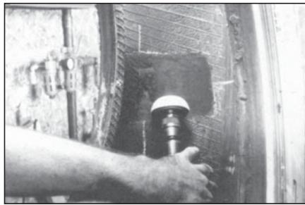
**44** Обработайте отмеченную область мелкозернистой абразивной полу-сферой на низкооборотной дрели до получения ровной шероховатой поверхности. Это нужно для увеличения площади контакта заплаты с покрышкой. При работе всегда пользуйтесь защитными очками № S918.
