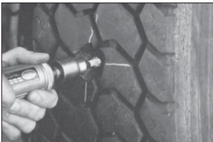
**10** Используя камень из оксида алюминия № S872 на высокооборотной пневмодрели, обработайте все распустившиеся нити стального корда до самой резины в месте повреждения. При этом действуйте с перерывами, чтобы резина не подгорала.
