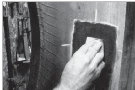
**14** Нанесите обезжирающую жидкость на ткань, не содержащую ворс. Очистите место повреждения, двигаясь от центра ремонтируемой области к краям. Повторите эту процедуру столько раз, сколько требуется для хорошей очистки ремонтируемой поверхности. Дайте обезжирающей жидкости 3-4 минуты для того, чтобы полностью высохнуть.
