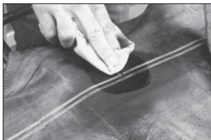
5 Очистите ремонтируемую область с помощью чистящей (обезжирающей) жидкости № 704 и ткани, не содержащей ворса.
