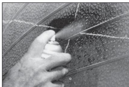
**7** Изнутри покрышки очистите область вокруг повреждения на ширину 100 мм во всех направлениях чистящей жидкостью с помощью атомайзера (распылителя). Помещение при этом должно хорошо проветриваться.
