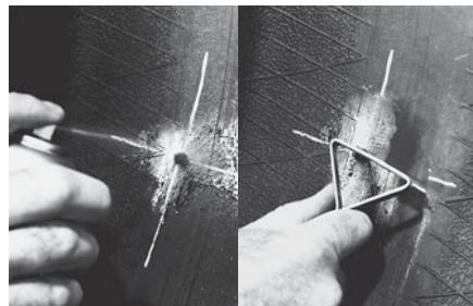
4 Исследуйте повреждение с внешней и внутренней стороны шины с помощью спирального шила №915. Проверьте угол и глубину прокола снаружи и изнутри. Если в прокол входит ТОЛЬКО заостренная (конусная) часть спирального шила, то его диаметр 3 мм (ремонтируется грибком № 250UL, см. рисунок А). Если в прокол входит основная часть шила, то его диаметр 6 мм (ремонтируется грибком № 251UL, см. рисунок В).
