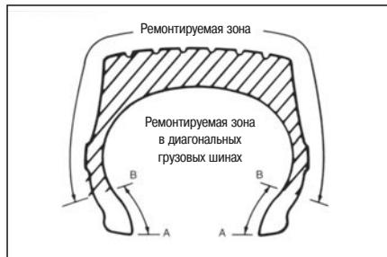
**2** Измерьте расстояние между краем борта покрышки и краями повреждения изнутри покрышки. Если повреждение попадает в неремонтируемую зону А-В, покрышка не подлежит ремонту. Величина неремонтируемой зоны А-В при размерах шин 7.0 (8) – 8.75 (9) равна 81 мм, а при размерах шин 9.00 (10) – 14.00 (15) равна 100 мм.
