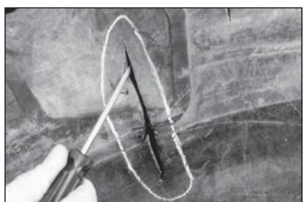
**5** Удалите из покрышки все инородные предметы, если они есть. Определите размер повреждения и возможное расслоение слоев корда с помощью спирального шила с тупым концом изнутри и снаружи покрышки.
