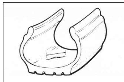
**6** Изнутри покрышки измерьте максимальные габариты повреждения (корда). Используя таблицу по применению заплат ВР, определите, подлежит ли повреждение ремонту (см. приложение).
