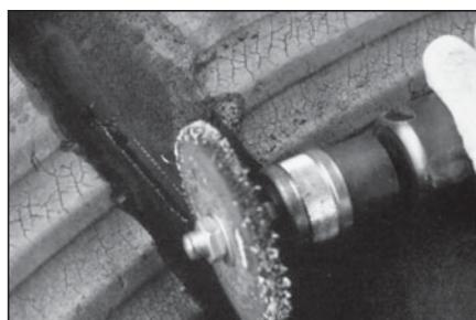
**9** Удалите снаружи покрышки оставшуюся резину между нитями корда металлощёткой в резиновой оболочке № S897 на низкооборотной дрели. Обработайте порез так, чтобы обнаружились только те нити корда, которые повреждены по всей длине пореза. При этом металлощётки в резиновой оболочке не повреждают нити корда.
