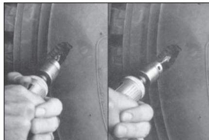
**14** Отрежьте с помощью алмазного бура № 283 на высокооборотной дрели (при минимальной скорости вращения 20 000 об/мин) все концы повреждённых нитей металлокорда. Держите бур под углом 90° к нити корда. Если повреждена одна нить корда, используйте алмазный бур № 280.
