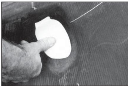
**26** Вырежьте платформу из сырой резины толщиной 3 мм и по ширине на 25 мм больше, чем размеры обработанного повреждения. Расположите её с внутренней стороны покрышки строго по центру повреждения. Прижмите эту платформу большим пальцем.
