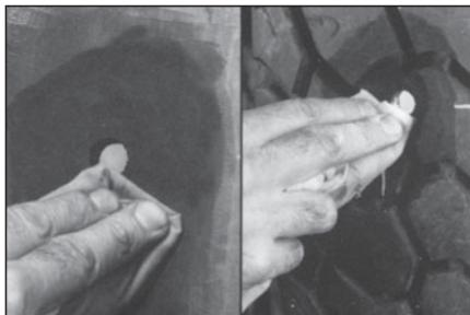
**22** Нанесите чистящую жидкость на ткань не содержащую ворса и очистите место повреждения. Повторите эту процедуру столько раз, сколько требуется для хорошей очистки ремонтируемой поверхности. Дайте чистящей жидкости 3-5 минут, чтобы полностью высохнуть.
