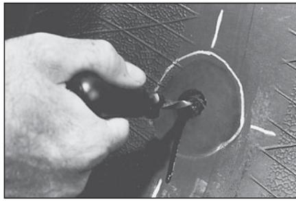
**12** Нанесите клей № 760 для химической вулканизации внутрь прокола и по всей его длине с помощью спирального шила № 915. Поворачивайте шило по часовой стрелке. Повторите эту процедуру от 3 до 5 раз. Оставьте шило в проколе до тех пор, пока не перейдете к выполнению пункта 17.
