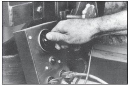
**39** Установите таймер, используя расчётное время вулканизации.
