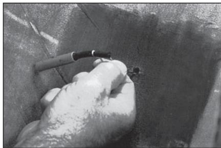
14 Удалите спиральное шило из прокола и вставьте проволочный металлический держатель в прокол с внутренней стороны покрышки. Протащите металлический держатель наружу.
