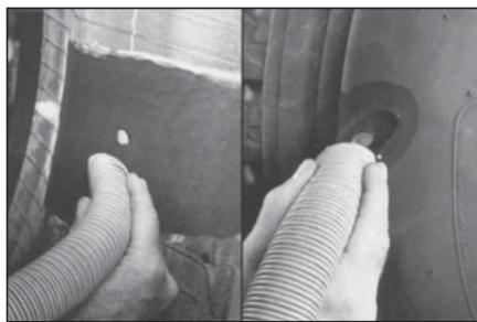
**29** Очистите пылесосом № S999 обработанную область для удаления металлической стружки и мелких частиц резины.
