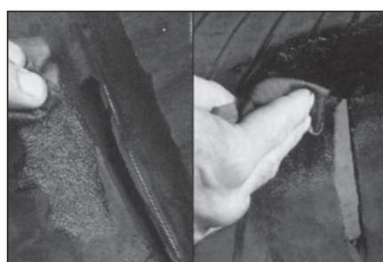
**27** Нанесите чистящую жидкость № 704 на ткань не содержащую ворс и тщательно очистите место повреждения изнутри и снаружи покрышки. Дайте чистящей жидкости 3-5 минут, чтобы полностью высохнуть.
