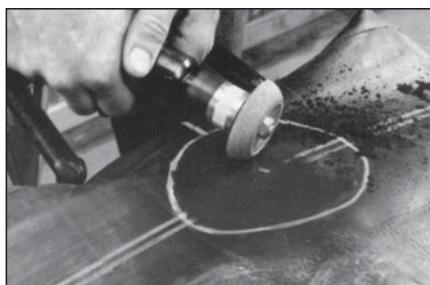
8 Обработайте ремонтируемую область механически. Это необходимо для удаления технологических неровностей и верхнего слоя поверхности камеры. Скорость вращения дрели при обработке не должна превышать 5000 об/мин. Используйте шлифовальную полусферу.
