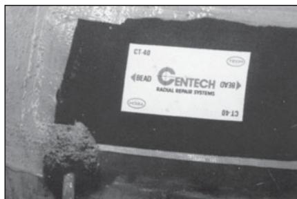
**48** При ремонте бескамерной покрышки нанесите герметик № 738 по периметру заплаты и на оставшуюся обработанную поверхность. Если ремонтируете камерную покрышку, посыпьте отремонтированное место тальком № 706. Это предотвратит слипание серого слоя на краях заплаты и камеры.
