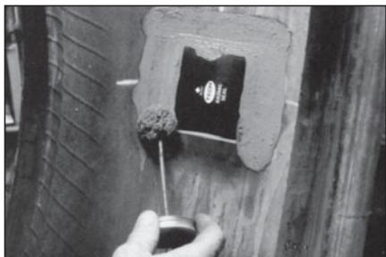
**28** При ремонте бескамерной покрышки нанесите герметик № 738 по периметру шляпки грибка и на оставшуюся обработанную поверхность. При ремонте камерной покрышки, нанесите тальк во избежание слипания краев шляпки грибка и камеры.
