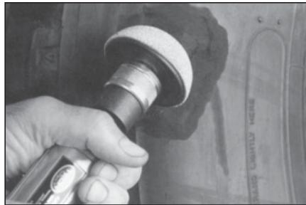
**46** Обработайте место ремонта покрышки снаружи мелкозернистой абразивной полусферой на низкооборотной дрели со скоростью вращения не более 5000 об/мин., чтобы поверхность покрышки стала ровной. Обработку производите движениями от центра повреждения к краям. Эта операция носит косметический характер.
