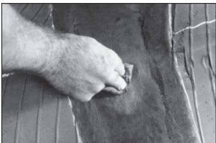
**49** Нанесите чистящую жидкость № 704 на ткань не содержащую ворс и тщательно очистите место повреждения, двигаясь от центра ремонтируемой области к краям. Дайте чистящей жидкости 3-4 минуты, чтобы полностью высохнуть.
