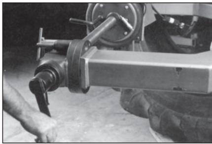
**35** Установите вулканизатор на покрышку, предварительно убедившись, что нагревательные элементы находятся по центру пореза снаружи и внутри шины. Периодически проверяйте нагревательные элементы.
