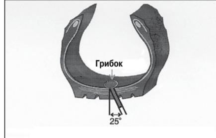
1 Обозначьте место повреждения покрышки с внешней и внутренней стороны с помощью воскового маркировочного мелка № 951.
