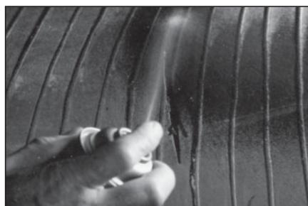
**6** Очистите место повреждения изнутри покрышки чистящей жидкостью № 704 с помощью атомайзера (распылителя) № 975.
