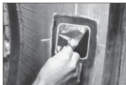
**27** Удалите прозрачную полиэтиленовую защитную пленку.
