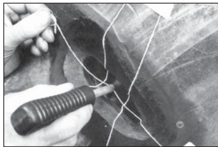
**28** Положите в область пореза с внешней стороны покрышки х/б нити для вентиляции, чтобы снять давление с корда (внутри поврежденной части корда покрышки при вулканизации накапливается воздух). Закрепите пластырем концы нитей на расстоянии 75 мм от краёв повреждения.
