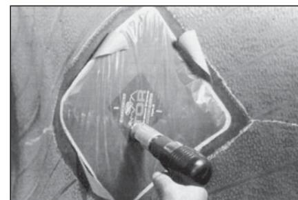
**52** Используя пневмомолот № S990, прижмите заплату к поверхности покрышки от центра к краям.
