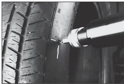
**9** Когда ремонтируете нижнюю или верхнюю часть боковой поверхности шины, обработайте повреждение с помощью карбидной фрезы только с внешней стороны шины минимум 3 раза. Правильно выберите угол при обработке.
