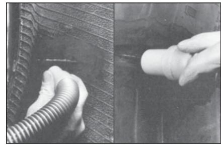
**24** Очистите пылесосом № S999 обработанную область для удаления металлической стружки и резиновой пыли с внутренней и внешней стороны покрышки.
