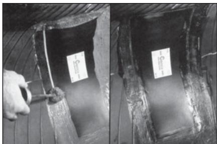
**58** Для бескамерных шин: нанесите серый герметик № 738 на края заплаты и зачищенную поверхность за пределами заплаты.
