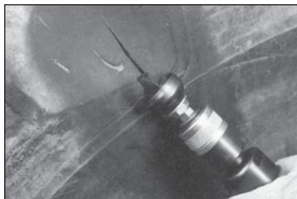
**10** Удалите резину в месте повреждения с внешней стороны покрышки колпачковым обрезателем № S2045, установленным на низкооборотной пневмодрели (максимальная скорость вращения 5000 об/мин). Также вы можете использовать шейм с зернистотью (390 SSG).
