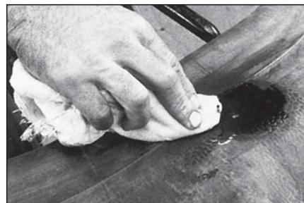
3 Очистите ремонтируемую область с помощью чистящей (обезжирающей) жидкости № 704 и ткани, не содержащей ворс.
