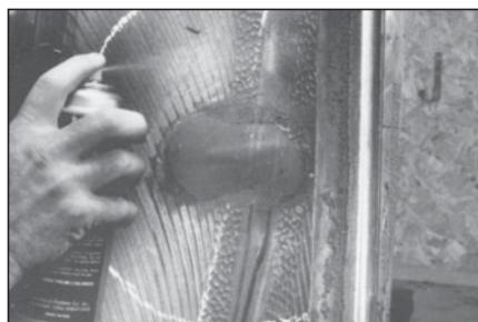
**39** Нанесите чистящую жидкость № 704 на отмеченную область покрышки с помощью атомайзера (распылителя) № 975.
