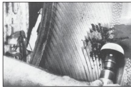
**15** Обработайте покрышку с внутренней стороны по периметру на ширину 40 мм вокруг повреждения мелкозернистой абразивной полу сфере на низкооборотной дрели. Вы должны получить ровную платформу для вулканизационной резины.
