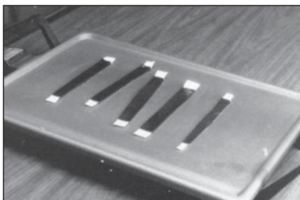
**24** Подготовьте сырую резину для использования. Нарежьте достаточное количество полосок резины для горячей вулканизации для заполнения повреждения. Предварительно нагрейте резину до температуры 49°- 55°C.
