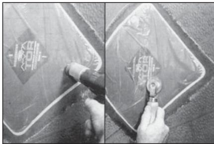
**54** После снятия каждого 50 мм покрытия обрабатывайте их пневмо-молотком и раскаткой и так далее до края заплаты.
