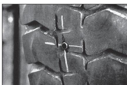
25 Ремонт завершен. Шина готова к эксплуатации.
