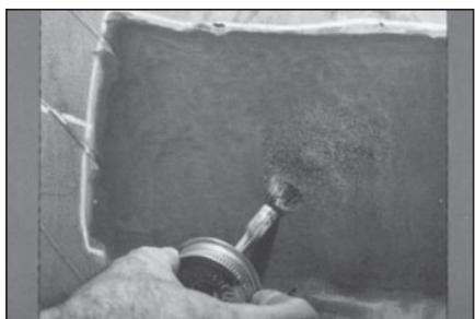
42 Нанесите слой клея № 760 для холодной вулканизации на обработанную поверхность. Дайте клею примерно 3-5 минут, чтобы он полностью высох (во влажных условиях время высыхания клея увеличивается).
