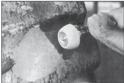
**87** Обработайте место ремонта покрышки снаружи шероховкой на низкооборотной дрели, дойдя до первоначальной поверхности покрышки и следя за тем, чтобы шероховка вращалась в направлении от центра к краям места вулканизации.
