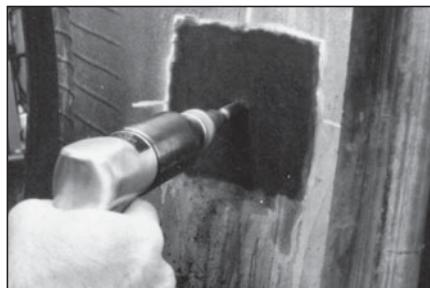
**11** Подготовьте повреждение с помощью карбидной фрезы на пневмодрели. Скорость вращения пневмодрели при обработке прокола не должна превышать 1200 об/мин. Используйте вращение по часовой стрелке. Обработайте прокол с внутренней стороны покрышки. Повторите эту процедуру, как минимум, три раза.
