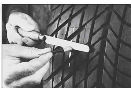
24 Отрежьте выступающую часть ножки грибка на 3 мм выше уровня поверхности покрышки.
