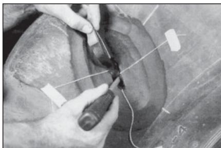
31 Начинайте заполнять повреждение полосами предварительно нагретой сырой резины толщиной 3 мм, уплотняя их специальной трамбовкой, чтобы воздух не скапливался в резине.
