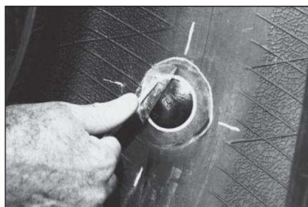
22 Удалите прозрачную полиэтиленовую защитную пленку.
