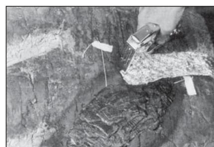
**83** При использовании вулканизационной камеры или вулканизатора типа Монафлекс перед проведением вулканизации в области протектора и в плечевой области необходимо поставить перемычку в канавке протектора, чтобы остановить «растекание» резины во время вулканизации.
