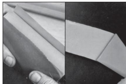
**51** Разорвите перфорацию на синей защитной пленке и полностью снимите её. Важно не касаться серого слоя руками!
