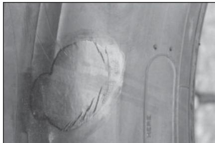
**44** После вулканизации извлеките покрышку из вулканизатора и дайте ей остыв. Проверьте качество ремонта.
