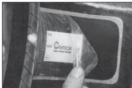
37 Снимите прозрачную полиэтиленовую пленку с заплаты.
