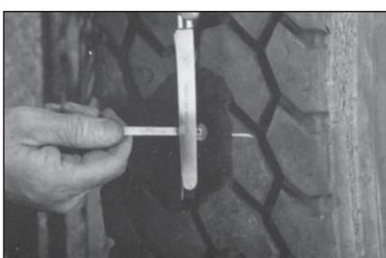
**16** Для вулканизации в дальнейшем вам необходимо знать толщину резинового слоя. Измерьте максимальную глубину пореза. Напишите размеры на внешней стороне покрышки для дальнейшего использования.
