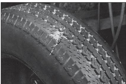
**16** Проверьте отремонтированную покрышку на герметичность с помощью жидкости для поиска проколов № 751. Если не будет пузырьков воздуха, покрышка готова к эксплуатации.
