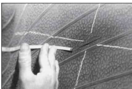
**4** При ремонте повреждения в боковой поверхности измерьте расстояние от края борта по контуру покрышки до края повреждения.
