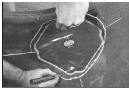
**42** Используя нарисованные ранее линии (см. пункт 17), приложите заплату, выбранную ранее (см. пункт 21) на центр повреждения изнутри покрышки. Обведите маркировочным мелком заплату по периметру примерно на 25 мм от краев заплаты. Это область для механической обработки шероховкой.
