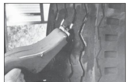
**52** Используя мелкозернистую абразивную полусферу на низкооборотной дрели, обработайте место ремонта покрышки снаружи так, чтобы оно стало вровень с остальной поверхностью покрышки.
