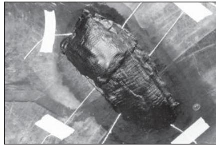
**31** Заполните повреждение так, чтобы сырья резина выступала на 3 - 6 мм над поверхностью покрышки (больше всего над центром обработанной области). Если повреждение находится в плечевой области покрышки, заполните повреждение до уровня на 9 мм выше поверхности покрышки, чтобы обеспечить нужное давление при вулканизации.
