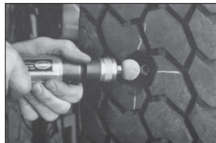
**12** Для получения необходимой текстуры обработайте повреждение снаружи стороны покрышки шероховальным шариком с зернистостью (230 SSG) на низкооборотной пневмодрели. Держите шерохователь под углом 45°.
