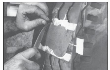
**49** Снимите прозрачную полиэтиленовую пленку с заплаты.
