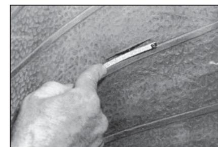
**6** Измерьте длину повреждения и посмотрите на таблицу выбора заплат TOR (см. приложение), чтобы определить, подлежит ли покрышка ремонту. Рекомендуется, чтобы размер повреждения на диагональных покрышках внедорожной техники не превышал 1/3 поперечного сечения покрышки в любом направлении.
