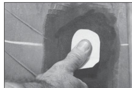
**25** Вырежьте платформу из сырой резины толщиной 3 мм и размером на 25 мм больше, чем размеры обработанного повреждения внутри покрышки. Расположите платформу по центру пореза и прижмите ее большим пальцем.
