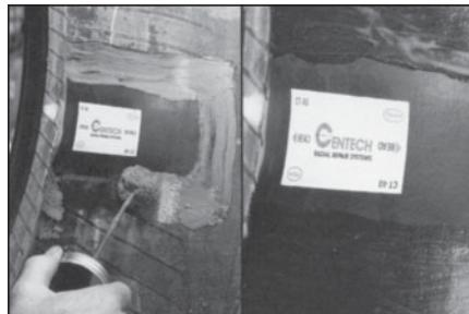
**45** При ремонте бескамерной покрышки нанесите герметик заплат № 738 по периметру заплаты и на оставшуюся обработанную поверхность. При высыхании герметик чернеет. Если Вы ремонтируете камерную покрышку, посыпьте отремонтированное место тальком № 706. Это предотвратит слипание серого слоя на краях заплаты и камеры.
