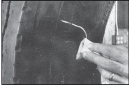
**7** Если покрышка подлежит ремонту, нанесите чистящую жидкость № 704 на отмеченную область покрышки с помощью атомайзера (распылителя) № 975.
