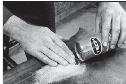
**12** Удалите прозрачную полиэтиленовую пленку с заплаты и посыпьте отремонтированное место тальком № 706. Это предотвратит прилипание серого слоя заплаты к внутренней стороне покрышки. После этого камера готова к эксплуатации.
