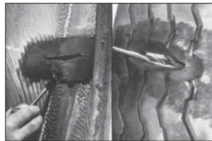
23 Нанесите тонкий, ровный слой клея для холодной или горячей вулканизации на всю обработанную область вокруг повреждения изнутри и снаружи покрышки и дайте ему высохнуть.
