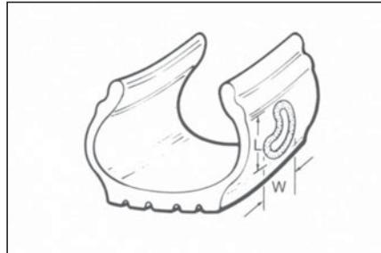
**20** На данном рисунке показано, как правильно измерять размеры повреждения. Длина измеряется по вертикали в направлении от борта до борта, а ширина по горизонтали параллельно беговой дорожке.
