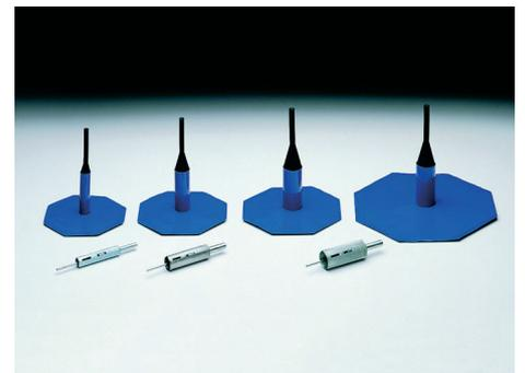
Грибки "Uni-Seal" и "Radial-Seal", предназначенные для ремонта проколов диаметром от 3 до 30 мм в области протектора, в плечевой зоне и на боковой поверхности радиальных и диагональных покрышек легковых и грузовых машин. Устанавливаются методом холодной вулканизации.
