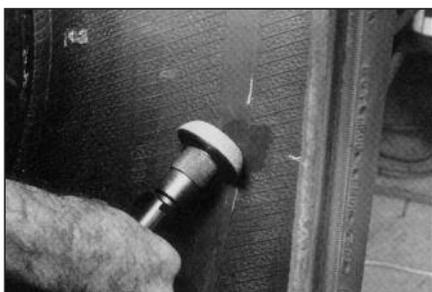
**9** Обработайте отмеченную область мелкозернистой абразивной полусферой. Скорость вращения дрели при обработке не должна превышать 5000 об/мин. При обработке внутренней поверхности шины старайтесь не задеть нити корда. При работе необходимо использовать защитные очки № S918.
