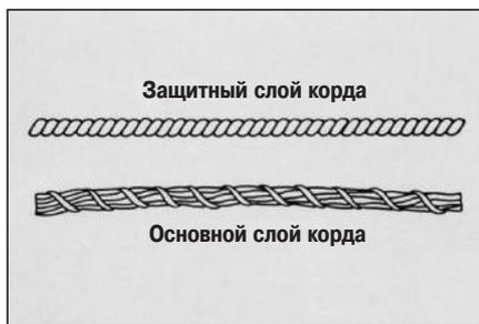
**10** В шинах применяются различные виды корда (защитный и основной). Защитный корд состоит из перекрученных жил, которые являются более гибкими, имеют меньший диаметр и расположены ближе друг к другу, чем жилы основного корда.
