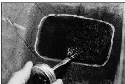
**22** Нанесите клей для химической вулканизации № 760 на обработанную поверхность. Дайте клею примерно 3-4 минуты для того, чтобы он полностью высох. При ремонте камерной покрышки обработайте область до синтетических нитей корда, нанесите на нее 2 слоя клея и увеличьте время высыхания вдвое.
