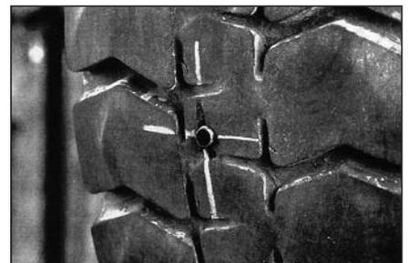
**25** Ремонт завершен. Шина готова к эксплуатации.
