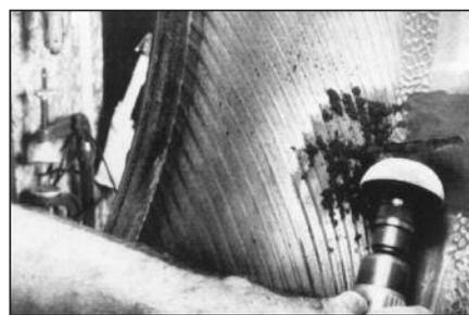
**15** Обработайте покрышку с внутренней стороны по периметру на ширину 40 мм вокруг повреждения мелкозернистой абразивной полусферой на низкооборотной дрели. Вы должны получить ровную платформу для вулканизационной резины.
