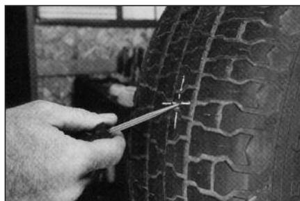
**4** Исследуйте повреждение с внешней и внутренней стороны шины с помощью спирального шила № 915.
