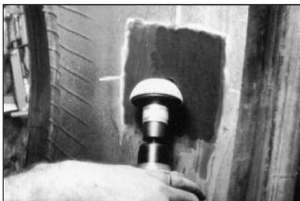
**10** Обработайте отмеченную область абразивной полусферой на пневмодрели. Скорость вращения пневмодрели при обработке не должна превышать 5000 об/мин.
