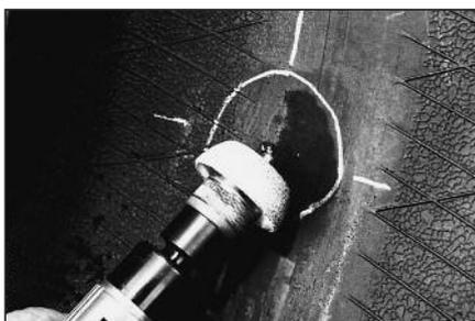
**8** Обработайте отмеченную область мелкозернистой абразивной полусферой. Скорость вращения дрели при обработке не должна превышать 5000 об/мин. При работе необходимо использовать защитные очки № S918.
