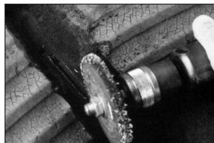
**9** Удалите снаружи покрывки оставшуюся резину между нитями корда металлощеткой в резиновой оболочке № S897 на низкооборотной дрели. Обработайте порез так, чтобы обнажились только те нити корда, которые повреждены по всей длине пореза. При этом металлощетки в резиновой оболочке не повреждают нити корда.
