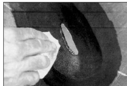
**24** Нанесите обезжиривающую (чистящую) жидкость на ткань, не содержащую ворс, и очистите обработанное место повреждения снаружи. Повторите эту процедуру 2-3 раза для хорошей очистки поверхности. Чистящая (обезжиривающая) жидкость должна полностью высохнуть.
