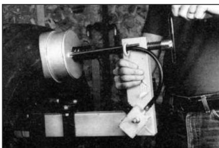
**37** Установите вулканизатор на покрышку, предварительно убедившись, что нагревательные элементы находятся по центру пореза снаружи и изнутри шины. Для точного расположения нагревательных элементов по центру используйте нарисованные восковым мелком линии.
