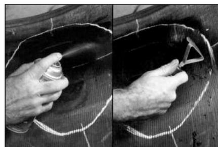
**43** Нанесите чистящую жидкость № 704 на отмеченную область изнутри покрывки с помощью атомизера (распылителя) № 975. Пока отмеченная область еще влажная, удалите грязь скребком № 933.
