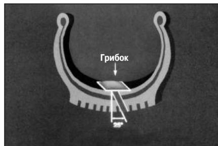
**6** Если угол прокола превышает  $25^\circ$ , необходимо применять двойной метод ремонта (с помощью ножки грибка и армированной заплата). Измерьте габариты повреждения. Если диаметр составляет 10 мм, используйте радиальный грибок № 291UL, если диаметр равен 15 мм, используйте радиальный грибок № 292UL.
