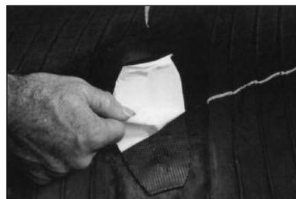
**36** Снимите защитную пленку с платформы сырой резины изнутри покрышки.
