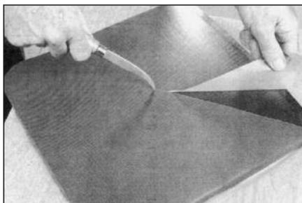
**74** Слегка согните заплата и разрежьте защитное покрытие в направлении, противоположном стрелке, указывающей на борт. Снимите защитное покрытие, чтобы обнажить 75-100 мм сырой резины.
