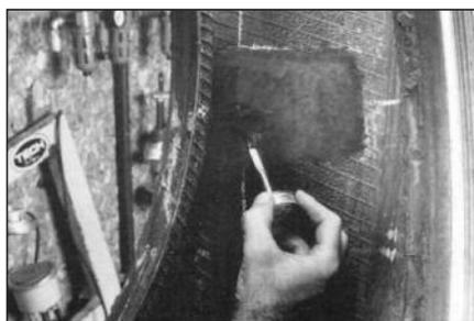
**47** Нанесите слой клея на обработанную поверхность от центра к краям. Дайте клею примерно 3-5 минут, чтобы он полностью высох.
