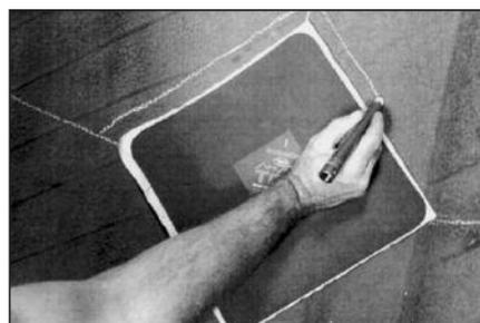
**62** Положите ранее определенную заплату TOR на повреждение и обведите ее по периметру на расстоянии примерно 25 мм от края заплаты. Эта линия является указателем для последующей очистки и шерохования.
