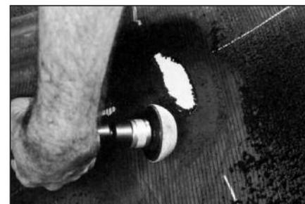
**17** Нарисуйте восковым мелком линии под прямым углом по центру повреждения изнутри покрышки для дальнейшей центровки заплаты по ним. Обработайте периметр вокруг повреждения на ширину 40 мм мелкозернистой абразивной полусферой на низкооборотной дрели. Вы должны получить ровную платформу для вулканизационной резины.
