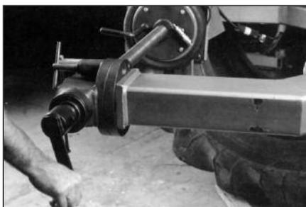
**35** Установите вулканизатор на покрывку, предварительно убедившись, что нагревательные элементы находятся по центру пореза снаружи и внутри шины. Периодически проверяйте нагревательные элементы.
