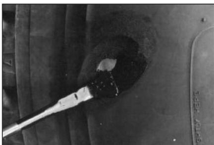
**31** Нанесите слой клея для холодной или горячей вулканизации на всю обработанную область вокруг повреждения снаружи покрышки и дайте ему высохнуть.
