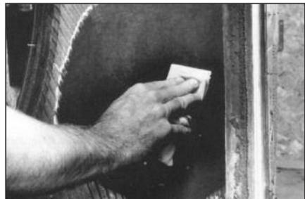
**43** Нанесите на ткань чистящую жидкость и тщательно очистите место повреждения, двигаясь от центра ремонтируемой области к краям. Дайте чистящей жидкости 3-4 минуты, чтобы полностью высохнуть. Увеличьте время высыхания в 2 раза на камерных шинах, если корд обнажён.
