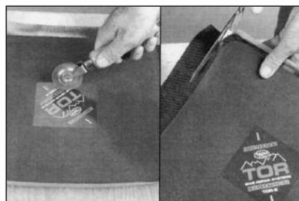
**73** Положите заплата на лист сырой резины толщиной 1,5 мм или 3 мм и прокатайте раскаткой от центра к краям. После прокатывания отрежьте сырую резину на расстоянии примерно 6 мм от края заплата.
