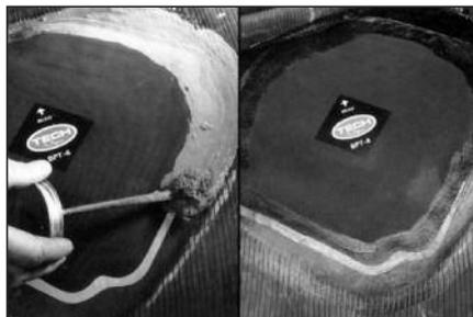
**53** При ремонте бескамерной шины нанесите герметик № 738 по периметру заплаты и на оставшуюся обработанную поверхность. Если Вы ремонтируете камерную покрышку, посыпьте отремонтированное место тальком № 706. Это предотвратит слипание серого слоя на краях заплаты и камеры.
