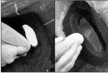
**18** Очистите вакуумным пылесосом № S999 обработанную область, чтобы удалить частицы резины и резиновой пыли с внутренней и внешней стороны покрывки.
