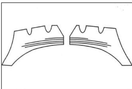
**10** Наружная резина должна удаляться примерно под углом 45° для повреждений в боковой поверхности и под углом 60° для повреждений в зоне протектора и плечевой области. Слои корда удаляются под углом 90°, чтобы повреждение было как можно меньше.
