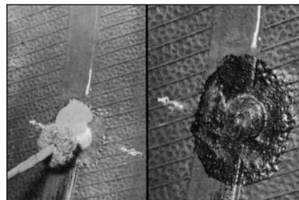
**19** При ремонте бескамерной покрышки нанесите герметик № 738 по периметру шляпки грибка и на оставшуюся обработанную поверхность. При ремонте камерной покрышки, нанесите тальк № 706 во избежание слипания краев шляпки грибка и камеры.
