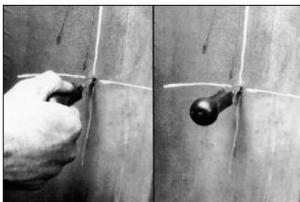
**5** С внутренней стороны покрышки определите угол прокола, используя спиральное шило № 915.
