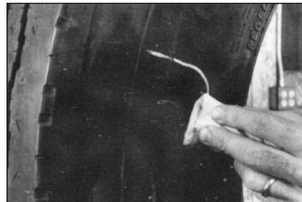
**9** Нанесите чистящую жидкость на ткань не содержащую ворса и очистите место повреждения с внешней стороны покрывки.
