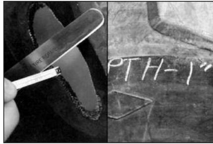
**19** Для определения времени вулканизации в Вам необходимо знать толщину шины в месте повреждения. Измерьте максимальную глубину пореза. Напишите размеры на внешней стороне покрывки для дальнейшего использования. Не измеряйте глубину повреждения под углом 45°.
