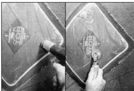
**54** После снятия каждых 50 мм покрытия обрабатывайте их пневмомолотком и раскаткой и так далее до края заплаты.
