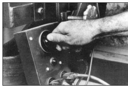
**39** Установите таймер, используя расчётное время вулканизации.
