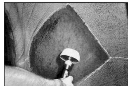
**44** Далее обработайте появившийся слой резины среднезернистой (SSJ 230) или мелкозернистой (SSJ 170) шероховальной полусферой на низкооборотной дрели до получения бархатной текстуры. Далее сформируйте скос по направлению к первоначальному контуру заплаты. Затем слегка обработайте поверхность покрышки за пределами заплаты.
