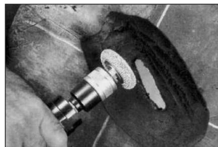
**15** Используя крупнозернистый шероховальный круг на низкооборотной дрели, удалите всю подгоревшую резину и неровности и постарайтесь, чтобы угол скоса повреждения был 45°, если оно на боковой поверхности шины, а на повреждениях в плечевой области и в области протектора 60°.
