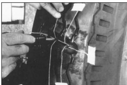
**28** Положите в область пореза с внешней стороны покрышки х/б нити для вентиляции, чтобы снять давление воздуха с корда (внутри поврежденной части корда покрышки при вулканизации накапливается воздух). Закрепите пластырем концы нитей на внешней стороне покрышки примерно на расстоянии 75 мм от обработанной зоны повреждения.
