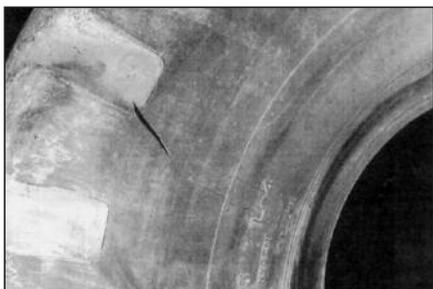
**1** Внимательно осмотрите покрышку с внешней и внутренней стороны, найдите повреждения, чтобы определить, подлежит ли она ремонту (см. приложение). Зона осмотра должна быть хорошо освещена. Если в покрышке есть вода, то нужно высушить ее в течение 24 часов.
