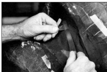
**41** Отрежьте ножом остатки «непроваренной» резины на покрывке. Это обычно не требуется, если Вы используете вулканизатор с пневмоподжимом.
