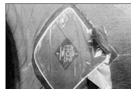
**53** По мере применения пневмомолотка снимайте полиэтиленовое покрытие, но сразу не более, чем по 50 мм во избежание сохранения воздуха под заплатой.
