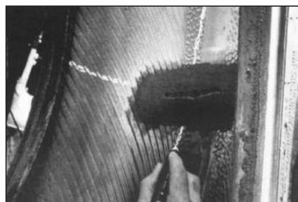
**21** Маркировочным мелком № 951 обозначьте место по центру повреждения изнутри покрышки, чтобы легче можно было отцентрировать заплату.
