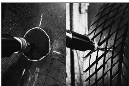
**7** Подготовьте повреждение с помощью карбидной фрезы. Скорость вращения дрели при этом не должна превышать 1200 об/мин. Используйте вращение по часовой стрелке. Обработайте прокол с внутренней, а затем с внешней стороны покрышки. Повторите эту процедуру, как минимум, три раза. Используйте карбидную фрезу 3 мм при ремонте с грибком 250UL или фрезу 6 мм при ремонте с грибком 251UL.
