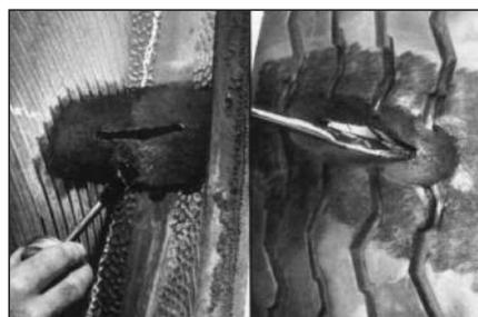
**23** Нанесите тонкий, ровный слой клея для холодной или горячей вулканизации на всю обработанную область вокруг повреждения изнутри и снаружи покрышки и дайте ему высохнуть. А. Время высыхания клея для горячей вулканизации 15-20 минут (немного больше во влажном климате). Удвойте это время при обнажённом корде. В. Время высыхания клея для холодной вулканизации 3-5 минут (немного больше во влажном климате). Нанесите 2 слоя клея и удвойте время высыхания при ремонте камерной шины.
