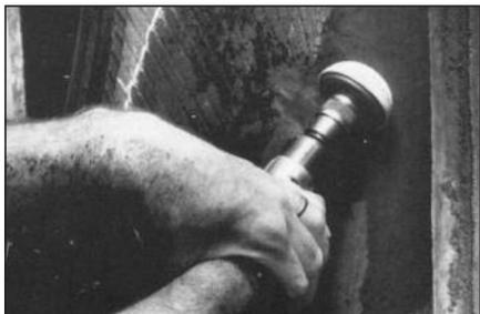
**41** Обработайте отмеченную область мелкозернистой абразивной полусферой на низкооборотной дрели до получения ровной шероховатой поверхности. Это необходимо для увеличения площади соприкосновения заплаты с покрышкой.
