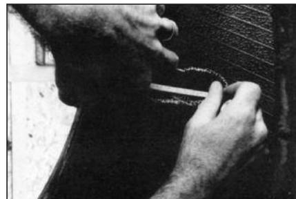
**6** Измерьте длину и ширину повреждения. По таблице определите, подлежит ли данное повреждение ремонту (см. приложение). Ширина повреждения в радиальной шине определяется количеством нитей поврежденного корда.
