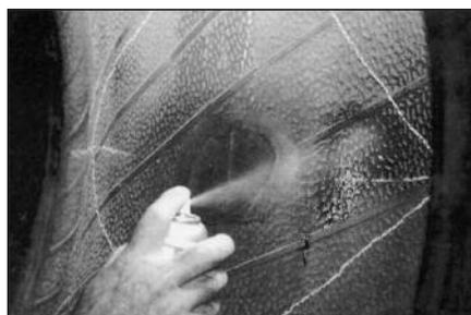
**40** Очистите обведенную область изнутри покрышки чистящей жидкостью № 704 с помощью атомайзера (рапылителя) № 975.
