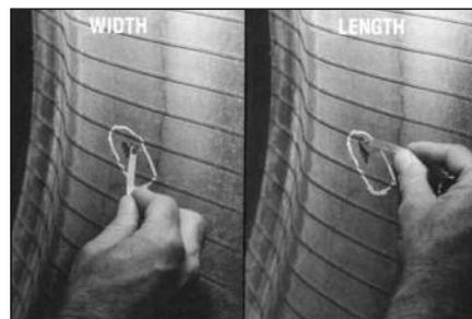
**6** Измерьте длину и ширину повреждения. По той же таблице определите, подлежит ли данное повреждение ремонту. Если повреждены одна или две нити корда, они должны быть удалены в месте повреждения.
