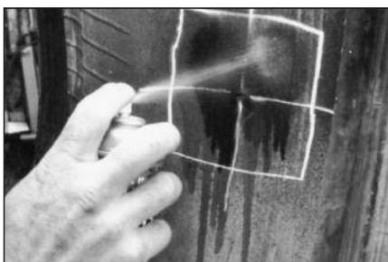
**8** Нанесите чистящую жидкость на отмеченную область покрышки с помощью атомайзера № 975.
