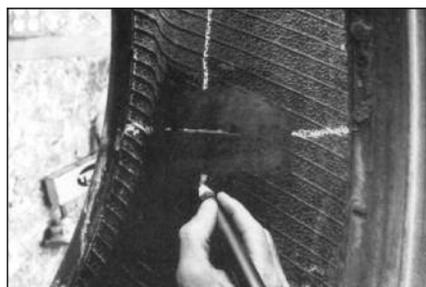
**26** Обозначьте место повреждения покрышки с внешней и внутренней стороны восковым маркировочным мелком. Нарисуйте указательные линии под прямым углом к повреждению на внутренней стороне покрышки в виде креста, чтобы легче можно было отцентрировать заплату.
