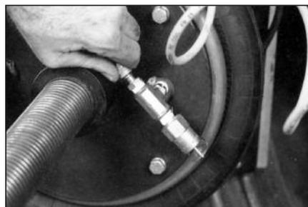
**40** По истечении времени вулканизации отсоедините линию подачи воздуха и снимите вулканизатор с покрывки. Дайте покрывке остыть.
