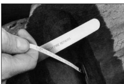
**25** Для будущей вулканизации Вы должны рассчитать время вулканизации. Для этого нужно знать толщину вулканизируемой резины. Измерьте максимальную глубину повреждения. Запишите данные.
