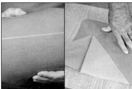
**48** Разорвите перфорацию на защитном синем полиэтиленовом покрытии заплаты и снимите его. Не касайтесь серого слоя резины во избежание его загрязнения.
