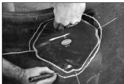
**42** Используя нарисованные ранее линии (см. пункт 17), приложите заплату, выбранную ранее (см. пункт 21) на центр поврежденная изнутри покрывки. Обведите маркировочным мелком заплату по периметру примерно на 25 мм от краёв заплаты. Это область для механической обработки шероховкой.
