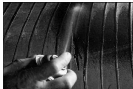
**6** Очистите место повреждения изнутри покрывки чистящей жидкостью № 704 с помощью атомайзера (распылителя) № 975.
