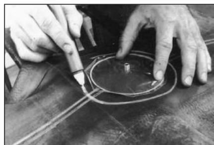
**6** Приложите заплату по центру отверстия и обведите ее на расстоянии 15 мм. Это будет область для механической обработки камеры. Обозначьте на камере направление оригинального металлического вентиля для дальнейшего правильного монтажа камеры в обод.
