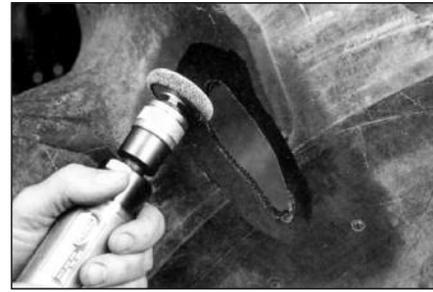
**14** Обработайте края повреждения под углом 45°, используя шероховальный круг с зернистостью (230 SSG) на низкооборотной дрели (максимальная скорость вращения 5000 об/мин). Это нужно для получения нужной текстуры резины в месте повреждения.
