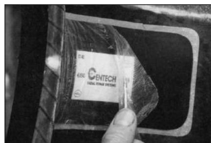
**37** Снимите прозрачную полиэтиленовую пленку с заплатки.
