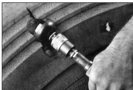
**8** Удалите резину в месте повреждения с внешней стороны покрывки колпачковым обрезателем № S2045, установленными на низкооборотной дрели (максимальная скорость вращения 5000 об/мин). **Внимание!** Старайтесь не повредить при этом стальные нити корда.
