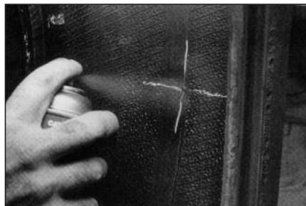
**7** Нанесите чистящую (обезжиривающую) жидкость на отмеченную область покрышки с помощью атомайзера (распылителя).
