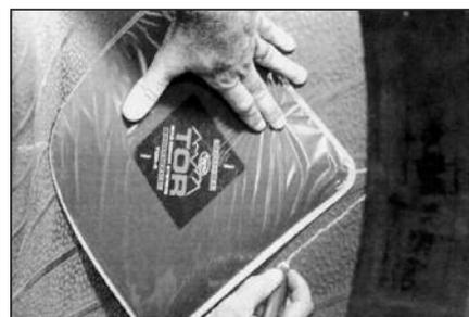
**39** Используя линии (см. пункт 2), положите заплату на середину повреждения изнутри покрышки и обведите ее по периметру на расстоянии 25 мм. Это будет указателем для последующей механической обработки.
