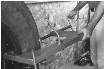
**33** Установите вулканизатор на покрышку, предварительно убедившись, что нагревательные элементы находятся по центру пореза снаружи и внутри шины. Установите пневмоподжим на вулканизаторе, подсоединив линию подачи воздуха.
