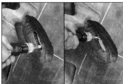
**14** Для удаления неровностей обработайте края повреждения шерохователем типа "карандаш" с крупной зернистостью (SSJ 390), а затем таким же шерохователем с мелкой зернистостью (SSJ 230), установленными на низкооборотной дрели для получения необходимой текстуры резины между слоями корда.
