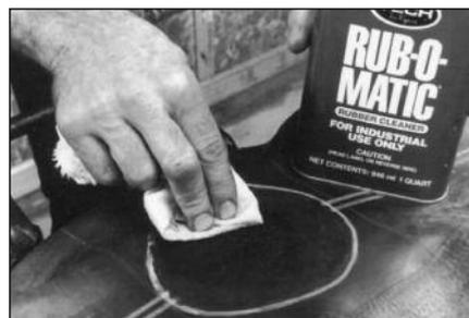
**9** После шерохования камеры нанесите обезжиривающую (чистящую) жидкость на ткань не содержащую ворс и очистите место повреждения, двигаясь от центра ремонтируемой области к краям. Повторите эту процедуру 2-3 раза. Дайте обезжиривающей жидкости 3-4 минуты для того, чтобы полностью высохнуть.
