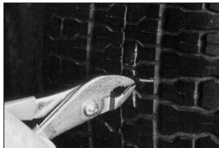
**16** Зажмите плоскогубцами металлический держатель с внешней стороны покрышки и вытяните ножку грибка. Если металлический держатель отделится от ножки, когда ножка грибка выйдет из прокола, зажмите ее плоскогубцами и тяните до тех пор, пока подложка не коснется поверхности покрышки изнутри.
