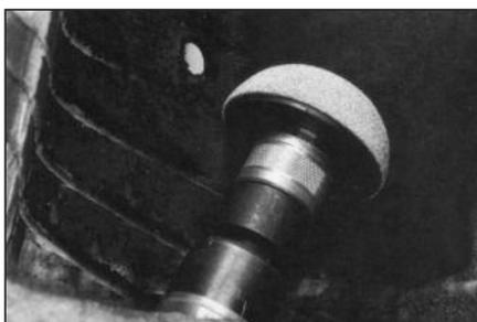
**28** Обработайте отмеченную область мелкозернистой абразивной полусферой на низкооборотной дрели до получения ровной шероховатой поверхности. Это нужно для увеличения площади контакта заплаты с покрышкой. При работе всегда пользуйтесь защитными очками № S918.
