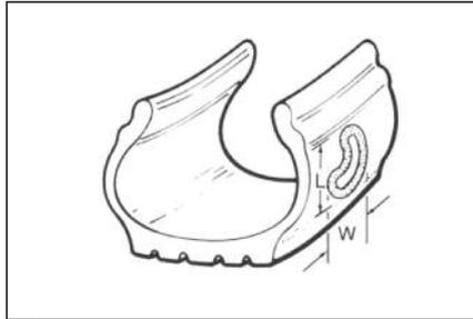
**20** На данном рисунке показано, как правильно измерять размеры повреждения. Длина измеряется по вертикали в направлении от бортика до борта, а ширина по горизонтали параллельно беговой дорожке.
