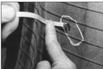
**4** Измерьте расстояние между краем обода покрышки и краем повреждения. Повреждение не должно находиться близко к посадочному месту на диске (в неремонтируемой зоне покрышки A-B).
