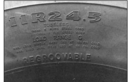
**21** По сведениям, указанным на боковой поверхности покрышки, определите ширину профиля покрышки, а также, является ли покрышка камерной или бескамерной.
