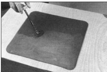
**72** Нанесите слой клея для горячей вулканизации на заднюю сторону заплата и дайте ему высохнуть в течение 15 минут или более при повышенной влажности. После высыхания клея снова наложите защитное покрытие на заплата.
