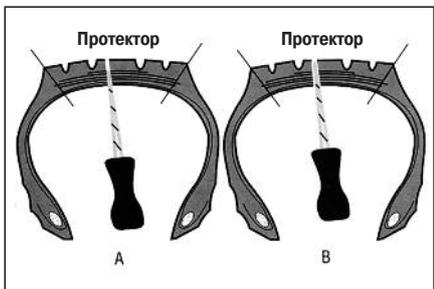
**4** Исследуйте повреждение с внешней и внутренней стороны шины с помощью спирального шила №915. Проверьте угол и глубину прокола снаружи и изнутри. Если в прокол входит ТОЛЬКО заостренная (конусная) часть спирального шила, то его диаметр 3 мм (ремонтируется грибком № 250UL, см. рисунок А). Если в прокол входит основная часть шила, то его диаметр 6 мм (ремонтируется грибком № 251UL, см. рисунок В).
