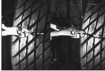
**18** Зажмите плоскогубцами металлический держатель с внешней стороны покрышки и вытяните ножку грибка. Если металлический держатель отделится от ножки, когда ножка грибка выйдет из прокола, зажмите ее плоскогубцами и тяните до полной установки грибка.
