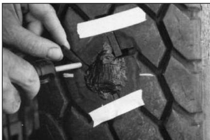
**30** Канавки протектора в месте ремонта заполните кусочками резины, чтобы сырая резина в процессе вулканизации не растекалась по рисунку протектора и не вулканизировала его. Если канавка большая, можно использовать гипс или алюминиевую фольгу в качестве блокирующего материала.
