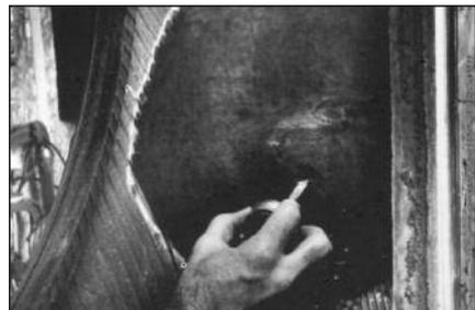
**44** Нанесите слой клея на обработанную поверхность. Дайте клею примерно 3-5 минут для того, чтобы он полностью высох. Если ремонтируемая область камерной покрышки обработана до синтетических нитей корда, нанесите на нее 2 слоя клея и увеличьте время высыхания вдвое.
