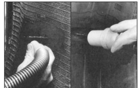
**24** Очистите пылесосом № S999 обработанную область для удаления металлической стружки и резиновой пыли с внутренней и внешней стороны покрышки.
