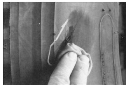
**9** Нанесите чистящую жидкость на ткань не содержащую ворса и очистите место повреждения с внешней стороны покрышки.
