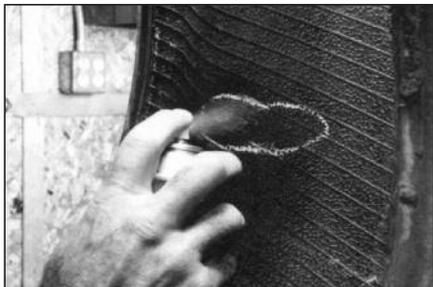
**7** Если покрывка подлежит ремонту, нанесите чистящую жидкость № 704 на отмеченную область покрывки с помощью атомайзера (распылителя) № 975.
