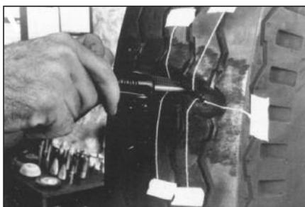
**29** Утрамбуйте сырую резину в месте пореза покрышки тупым инструментом для трамбовки резины. Не старайтесь заполнять сразу большую область, так как Вы можете оставить воздушные мешки между утрамбованными слоями резины, что увеличит её пористость в месте ремонта после вулканизации. Трамбуйте резину до тех пор, пока не сможете перейти к раскатке.
