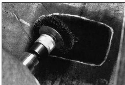
**20** Удалите частицы резины на обработанной области с помощью мягкой проволоочной щетки № 893 и низкооборотной дрели. При этом двигайтесь справа налево.
