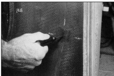
**12** Нанесите клей для химической вулканизации № 760 внутрь прокола по всей его длине с помощью спирального шила, поворачивая шило по часовой стрелке. Повторите эту процедуру от 3 до 5 раз. Оставьте шило в проколе до тех пор, пока не перейдете к выполнению пункта 15 данной инструкции.
