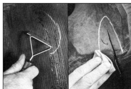
**6** Изнутри покрышки измерьте максимальные габариты повреждения (корда). По таблице по применению заплат ВР определите, подлежит ли повреждение ремонту (см. приложение).
