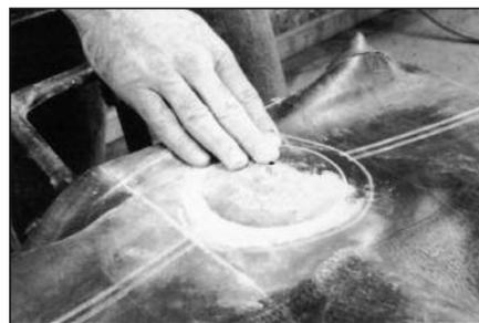
**15** Удалите прозрачную полиэтиленовую пленку с подложки и посыпьте отремонтированное место тальком № 706. Это предотвратит прилипание серого слоя подложки к внутренней поверхности крышки.
