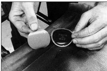
**4** Выберите подходящую заплату для ремонта повреждения. Заплата должна перекрывать размеры повреждения на 15 мм со всех сторон.
