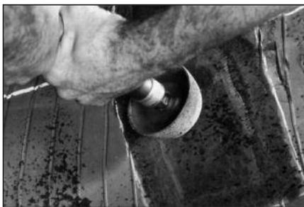
**47** Используя средне или мелкозернистую полусферу на низкооборотной дрели, обработайте пористый слой резины до получения ровной текстуры. Затем обработайте скос между заплатой и оставшимся участком заштрихованной области.
