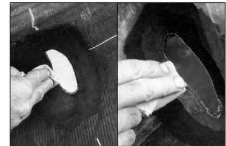
**23** Нанесите чистящую жидкость на ткань не содержащую ворс и тщательно очистите место повреждения изнутри и снаружи покрывки, двигаясь от центра к краям. Дайте чистящей жидкости 3-5 минут, чтобы полностью высохнуть. Если виден корд, дайте чистящей жидкости высохнуть в течение 6-8 минут.
