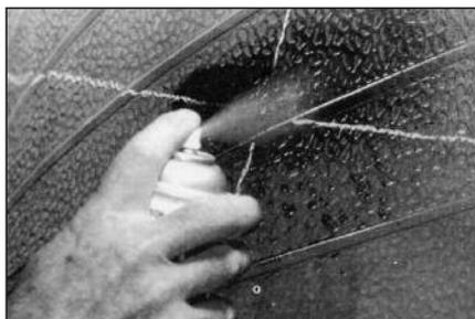
**7** Изнутри покрышки очистите область вокруг повреждения на ширину 100 мм во всех направлениях чистящей жидкостью с помощью атомизера (распылителя). Помещение при этом должно хорошо проветриваться.
