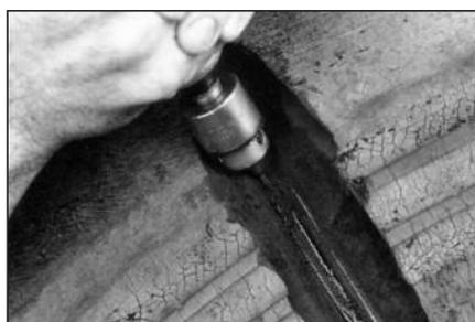
**13** Отрежьте с помощью алмазного бура № 283 на высокооборотной дрели (при минимальной скорости вращения 20 000 об/мин) концы повреждённых нитей металлокорда с одного края повреждения. Держите бур под углом 90° к нити корда.
