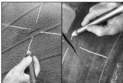
**2** При осмотре найдите и отметьте все повреждения изнутри и снаружи покрышки длинными линиями, пересекающимися под прямым углом. Это поможет потом отцентровать по ним вулканизатор и заплату.
