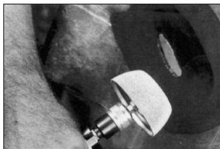
**17** Используя шероховальную полусферу на низкооборотной дрели, обработайте область по периметру вокруг повреждения на ширину примерно 50 мм с внешней стороны покрышки. Этот процесс снимает легкое окисление и готовит поверхность повреждения для вулканизации. Все глубокие порезы должны быть ликвидированы перед их заполнением сырой резиной.
