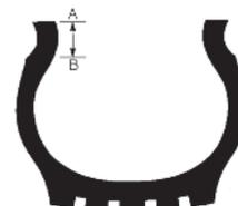
Для правильного выбора заплаты необходимо определить размер повреждения в покрышке, измерив самое широкое место поврежденной части корда. Найдите размер повреждения в горизонтальном столбце таблицы. Затем определите количество слоев корда в покрышке (PL - Ply Rating) (крайний левый столбец). Рекомендуемый размер заплаты находится в квадрате пересечения найденных столбцов. Эта схема имеется также в виде НАСТЕННОЙ ТАБЛИЦЫ.
