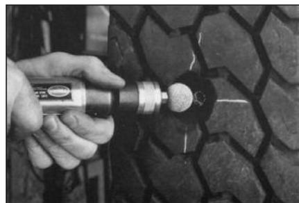
**12** Для получения необходимой текстуры обработайте повреждение снаружи стороны покрышки шероховатым шариком с зернистостью (230 SSG) на низкооборотной пневмодрели. Держите шерохователь под углом 45°.
