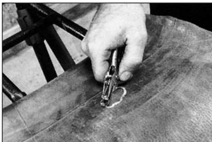
**2** Для предотвращения увеличения разрыва камеры в дальнейшем, необходимо обработать порез, закруглив края.
