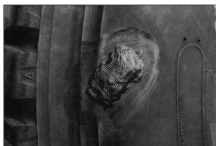
**41** Порез должен быть заполнен сырой резиной так, чтобы она выступала на 3-6 мм над поверхностью покрышки. Самая большая толщина слоя сырой резины должна находиться по центру поврежденного места и уменьшаться к его краям.
