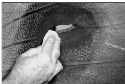
**25** Нанесите обезжиривающую (чистящую) жидкость на ткань не содержащую ворс и очистите место повреждения изнутри. Повторите эту процедуру 2-3 раза для хорошей очистки поверхности. Чистящая (обезжиривающая) жидкость должна полностью высохнуть.
