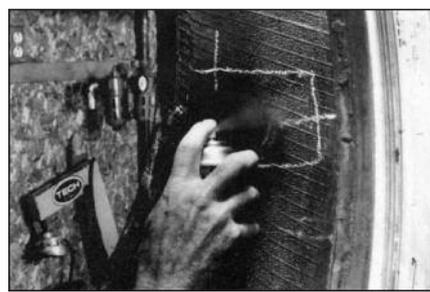
**42** Нанесите чистящую жидкость № 704 с помощью атомайзера № 975 на отмеченную область покрышки.
