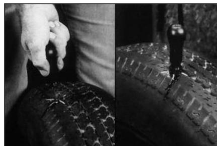
**6** Поместите спиральное шило в повреждение и, вращая по часовой стрелке, промажьте прокол клеем по всей глубине. Затем, вращая спиральное шило по часовой стрелке, удалите его из покрышки. Убедитесь в том, что правильно определили угол прокола, так как возможно дополнительное повреждение шины. Данный пункт следует повторить, как минимум, 3 раза. Оставьте спиральное шило в проколе до выполнения пункта № 11 настоящей инструкции.
