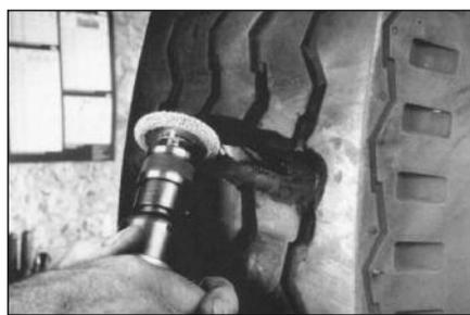
**13** Обработайте повреждение под углом 45°, используя шероховальный круг с зернистостью (230 SSG) на низкооборотной дрели. Для ускорения процесса обработки резины в месте повреждения используйте круг с большей зернистостью (390 SSG).
