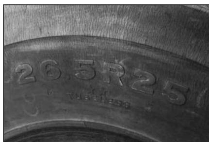
**23** По маркировке на боковине шины определите ее размер и тип.
