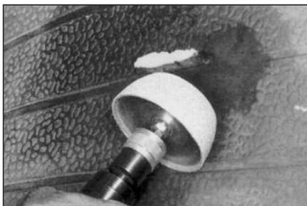
**19** Изнутри покрышки обработайте область вокруг повреждения шириной 50 мм во все стороны мелкозернистой полусферой. Далее при применении двухэтапного метода с использованием вулканизатора следуйте указаниям пунктов с 20 по 59. **Если Вы используете одноэтапный метод с использованием вулканизационной камеры или вулканизатора типа Монафлекс, сразу переходите к пункту 60, минуя пункты с 20 по 59.**
