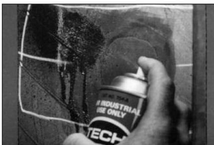
**37** Нанесите чистящую жидкость № 704 с помощью атомайзера (распылителя) № 975 на отмеченную область покрышки.
