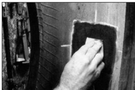
**14** Нанесите обезжиривающую жидкость на ткань, не содержащую ворс. Очистите место повреждения, двигаясь от центра ремонтируемой области к краям. Повторите эту процедуру столько раз, сколько требуется для хорошей очистки ремонтируемой поверхности. Дайте обезжиривающей жидкости 3-4 минуты для того, чтобы полностью высохнуть.
