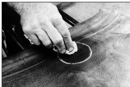
**7** После механической обработки (зачистки) камеры, нанесите на ткань обезжиривающую жидкость и очистите место повреждения, двигаясь от центра ремонтируемой области к краям. Повторите эту процедуру для качественной очистки ремонтируемой поверхности. Дайте чистящей жидкости 3-4 минуты для того, чтобы полностью высохнуть.
