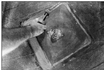
**88** Нанесите герметик № 738 по периметру заплатки и на оставшуюся обработанную поверхность. Если Вы ремонтируете камерную покрывку, посыпьте отремонтированное место тальком № 706. Это предотвратит слипание серого слоя на краях заплатки и камеры.
