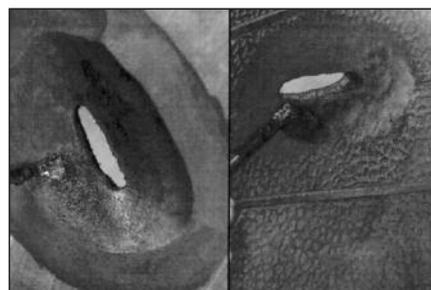
**26** Нанесите слой клея для горячей вулканизации № 1082 на область вокруг повреждения изнутри и снаружи покрышки. Дайте клею высохнуть в течение 15 минут и удвойте время высыхания при высокой влажности, если корд обнажен.
