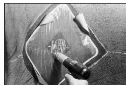
**52** Используя пневмомолоток № S990, прижмите заплату к поверхности покрышки от центра к краям.
