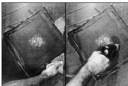
**77** Снимая по 50 мм защитного синего покрытия, прокатывайте заплата раскаткой или прибивайте пневмомолотком, пока вся заплата не будет прижата полностью. Если Вы используете заплата для холодной химической вулканизации, снимите сверху прозрачную полиэтиленовую защитную плёнку.
