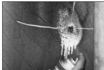
**6** Нанесите чистящую жидкость № 704 на отмеченную область изнутри покрывки с помощью атомайзера (распылителя) № 975.
