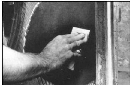
**43** Нанесите на ткань чистящую жидкость и тщательно очистите место повреждения, двигаясь от центра ремонтируемой области к краям. Дайте чистящей жидкости 3-4 минуты, чтобы полностью высохнуть. Увеличьте время высыхания в 2 раза на камерных шинах, если корд обнажён.
