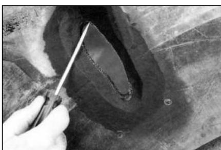
**16** С помощью спирального шила с тупым концом проверьте, что весь поврежденный корд удален.
