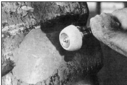
**87** Обработайте место ремонта покрышки снаружи шероховкой на низкооборотной дрели, дойдя до первоначальной поверхности покрышки и следя за тем, чтобы шероховка вращалась в направлении от центра к краям места вулканизации. Это гарантирует, что завулканизированная резина на краях не будет задирается.
