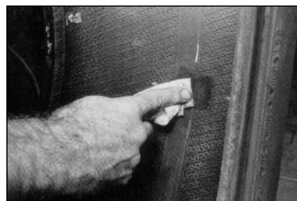
**11** Нанесите обезжиривающую (чистящую) жидкость на ткань не содержащую ворс и очистите место повреждения, двигаясь от центра ремонтируемой области к краям. Повторите эту процедуру 2-3 раза для хорошей очистки поверхности. Чистящая (обезжиривающая) жидкость должна полностью высохнуть.
