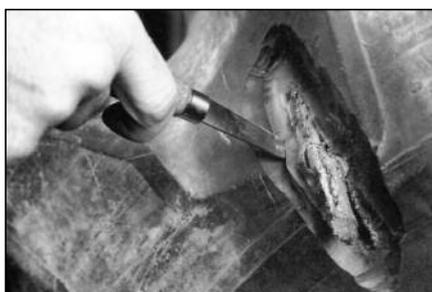
**12** Используя специальный нож № 940, окончательно удалите резину из поврежденного места покрышки. Нож должен быть направлен под углом 90° к покрышке.
