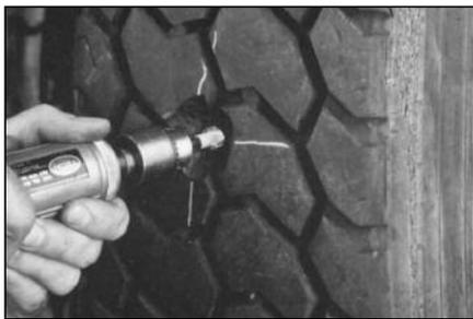
**10** Используя камень из оксида алюминия № S872 на высокооборотной пневмодрели, обработайте все расплывшиеся нити стального корда до самой резины в месте повреждения. При этом действуйте с перерывами, чтобы резина не подгорала.
