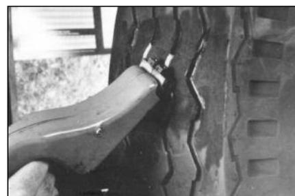
**54** Нарезьте канавки в протекторе с помощью специальной машинки-регривера № S145, но не глубже существующих канавок. Покрышка готова к эксплуатации.
