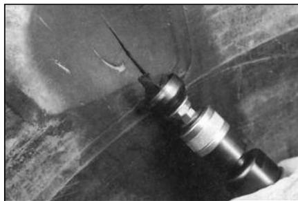
**10** Удалите резину в месте повреждения с внешней стороны покрышки колпачковым обрезателем № S2045, установленным на низкооборотной пневмодрели (максимальная скорость вращения 5000 об/мин). Также вы можете использовать шейм с зернистостью (390 SSG).
