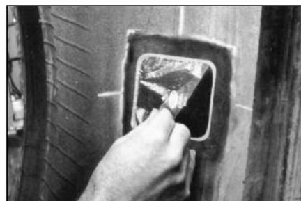
**27** Удалите прозрачную полиэтиленовую защитную пленку.
