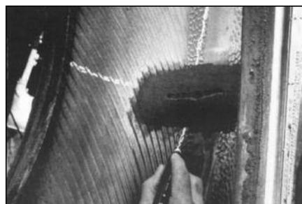
**21** Маркировочным мелком № 951 обозначьте место по центру повреждения изнутри покрышки, чтобы легче можно было отцентрировать заплатку.
