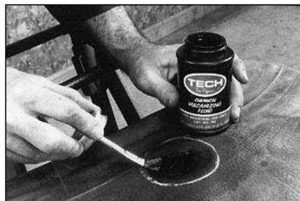
**8** Нанесите тонкий слой клея для химической (холодной) вулканизации № 760, двигаясь от центра ремонтируемой области к краям. Не наносите второй (дополнительный) слой клея. Дайте клею примерно 3-4 минуты для того, чтобы он полностью высох.
