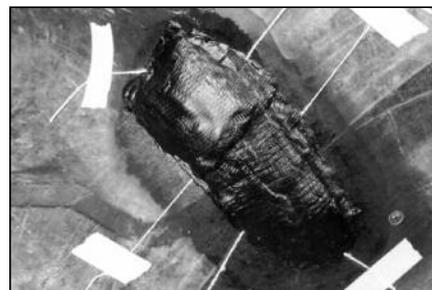
**31** Заполните повреждение так, чтобы сырая резина выступала на 3 - 6 мм над поверхностью покрышки (больше всего над центром обработанной области). Если повреждение находится в плечевой области покрышки, заполняйте повреждение до уровня на 9 мм выше поверхности покрышки, чтобы обеспечить нужное давление при вулканизации.
