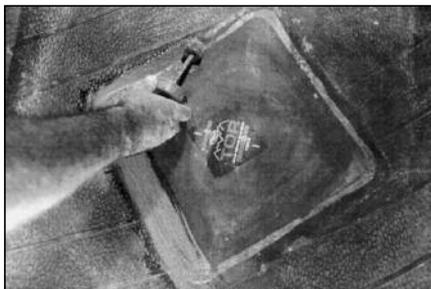
**88** Нанесите герметик № 738 по периметру заплаты и на оставшуюся обработанную поверхность. Если Вы ремонтируете камерную покрышку, посыпьте отремонтированное место тальком № 706. Это предотвратит слипание серого слоя на краях заплаты и камеры.
