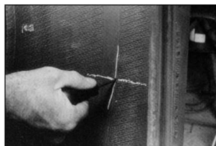
**5** Определите размер, угол и глубину прокола снаружи и изнутри с помощью спирального шила № 915.
