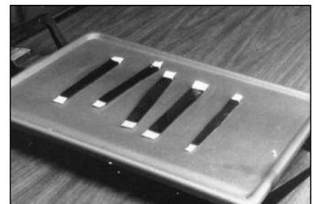
**25** Подготовьте сырую резину для использования. Нарежьте достаточное количество полосок резины для горячей вулканизации для заполнения повреждения. Предварительно нагрейте резину до температуры 49° - 55°С.
