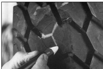
**51** Вы можете нарезать протектор заново в месте ремонта, если вулканизированное место закрывает канавку рисунка протектора. Это обеспечит необходимую гибкость отремонтированному месту повреждения и исключит нагрев покрышки в этом месте. Отметьте канавки восковым маркирующим мелком.
