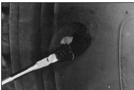
**31** Нанесите слой клея для холодной или горячей вулканизации на всю обработанную область вокруг повреждения снаружи покрывки и дайте ему высохнуть.
