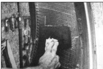
**46** Нанесите чистящую жидкость на ткань и тщательно очистите место повреждения, двигаясь от центра ремонтируемой области к краям. Дайте чистящей жидкости 3-4 минуты, чтобы полностью высохнуть.
