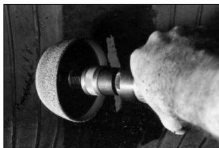
**20** Используя средне или мелкозернистую полусферу на низкооборотной дрели, зачистите изнутри покрышки зону вокруг повреждения на расстоянии 50-65 мм.
