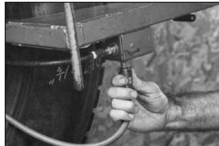
**35** После окончания процесса вулканизации отсоедините линию подачи воздуха и снимите вулканизатор с покрышки. Дайте покрышке остыть, а затем, используя нож, отрежьте остатки непроваренной резины на покрышке. Это обычно не требуется, если Вы используете вулканизатор с пневмоподжимом.
