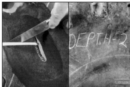
**20** Измерьте максимальную глубину повреждения для расчета времени вулканизации до заполнения повреждения сырой резиной и запишите значение глубины на покрышке снаружи.
