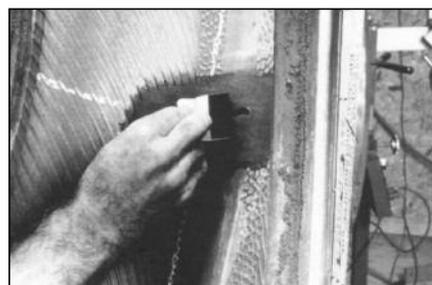
**24** Вырежьте полоску сырой резины толщиной 3 мм и шириной на 25 мм больше, чем размеры обработанного повреждения. Расположите полоску сырой резины с внутренней стороны покрышки таким образом, чтобы порез располагался строго по центру.
