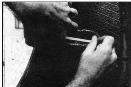
**6** Измерьте длину и ширину повреждения. По таблице определите, подлежит ли данное повреждение ремонту (см. приложение). Ширина повреждения в радиальной шине определяется количеством нитей повреждённого корда.
