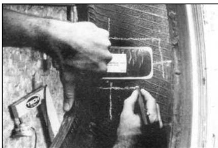
**41** Используя нарисованные Вами линии (см. пункт 26), расположите заплату, выбранную заранее (см. пункт 22), по центру повреждения. Обведите заплату маркировочным мелком по периметру на расстоянии примерно 25 мм от краёв заплаты. Это будет область для механической обработки шерохователем.
