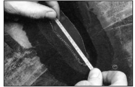
**20** Измерьте длину повреждения после обработки, чтобы определить необходимый размер заплаты ВР. Определите количество слоев корда в покрывке.
