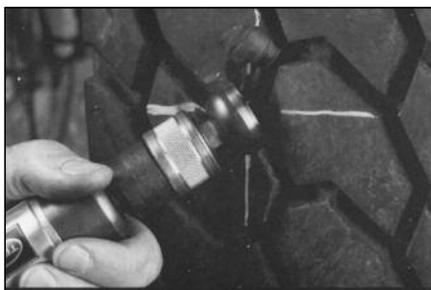
**8** Удалите резину в месте повреждения с внешней стороны покрывки колпачковым обрезателем № S2045, установленным на низкооборотной пневмодрели (максимальная скорость вращения 5000 об/мин). **Внимание!** Старайтесь не повредить при этом стальные нити корда.
