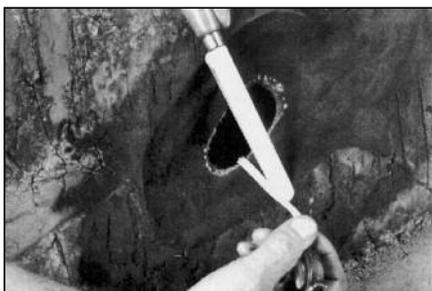
**60** Если Вы используете вулканизационную камеру, измерьте максимальную глубину повреждения, чтобы рассчитать время вулканизации. Расчет времени вулканизации не может быть закончен, пока повреждение не будет заполнено.
