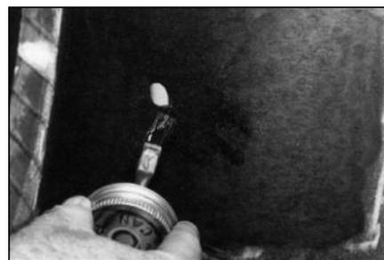
**32** Нанесите слой клея для холодной вулканизации на отмеченную область изнутри покрывки. Дайте клею примерно 3-5 минут для того, чтобы он полностью высох.
