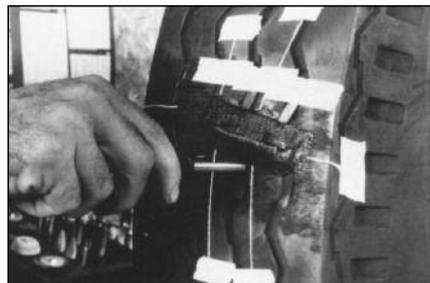
**32** Канавки протектора в месте ремонта заполните кусочками резины, чтобы сырая резина в процессе вулканизации не растекалась по рисунку протектора и не вулканизировала его. Если канавка большая, можно использовать гипс в качестве блокирующего материала.
