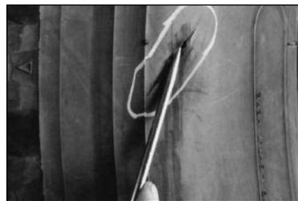
**3** Определите размер повреждения и возможное расслоение слоёв корда с помощью спирального шила с тупым концом.
