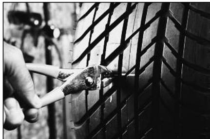
**2** Удалите предмет, вызвавший прокол покрышки, а затем исследуйте покрышку на предмет расслоения корда.
