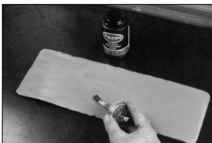
**52** Нанесите слой клея для холодной вулканизации на всю заплату для улучшения процесса холодной вулканизации.
