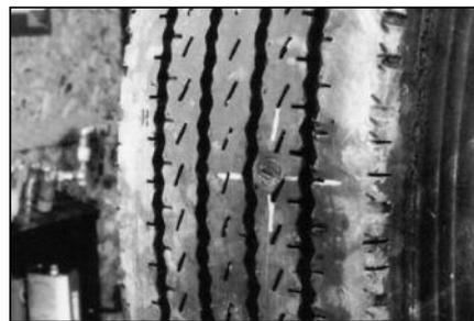
**30** Ремонт завершен. Шина готова к эксплуатации.
