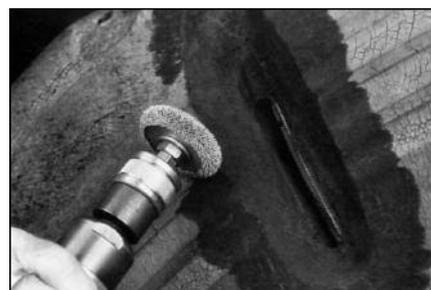
**18** Тем же шероховальным кольцом слегка зачистите поверхность покрышки по периметру повреждения на расстоянии 25 - 40 мм.
