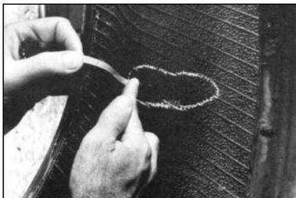
**4** Измерьте расстояние между краем обода покрывки и краем повреждения. Повреждение не должно находиться близко к посадочному месту на диске (в неремонтируемой зоне покрывки A-B).
