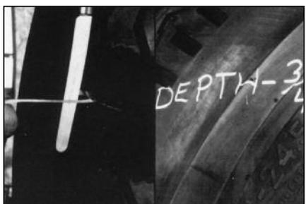
**16** Для определения времени вулканизации в дальнейшем Вам необходимо знать максимальную толщину шины в месте повреждения покрышки, которая подлежит вулканизации. Измерьте максимальную глубину пореза. Напишите размеры на внешней стороне покрышки для дальнейшего использования.
