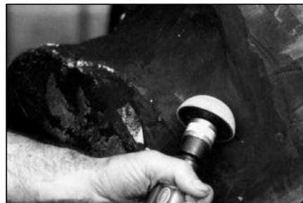
**54** Используя мелкозернистую абразивную полусферу на низкооборотной дрели, обработайте место ремонта покрышки снаружи так, чтобы оно стало вровень с остальной поверхностью покрышки.
