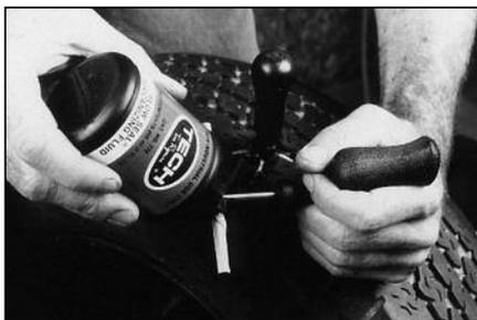
**10** Нанесите слой клея для химической вулканизации на жгут с двух сторон. Не опускайте жгут в банку с клеем, так как клей может загустеть в течение короткого времени.
