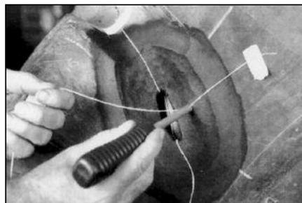
**30** Перед заполнением повреждения сырой резиной положите на него крест-накрест тонкие х/б нити, как показано на рисунке. Они должны заканчиваться на расстоянии 50 мм от краёв повреждения. Эти вентиляционные нити позволяют лишнему воздуху выходить из резины при вулканизации.
