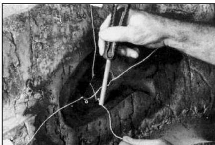
**79** Перед заполнением повреждения положите в него хлопковые тонкие нити на расстоянии примерно 40 мм друг от друга. Они должны выходить за пределы повреждения на 50 мм, как показано на рисунке. Эти нити необходимы для снижения давления и выхода воздуха из зоны корда покрышки.
