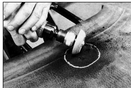
**6** Обработайте ремонтируемую область для удаления технологических неровностей и верхнего слоя камеры. Скорость вращения дрели при обработке не должна превышать 5000 об/мин. Используйте шлифовальную полусферу.
