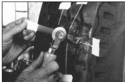
**31** Заполните обработанную область таким образом, чтобы сырая резина выступала примерно на 3-6 мм над поверхностью покрышки (больше всего над центром обработанной области).
