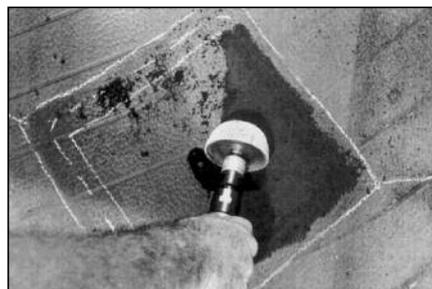
**66** Крупнозернистой полусферой на низкооборотной дрели снимите верхний бутиловый слой резины в пределах внутренней сплошной отмеченной линии. При этом полусфера всегда должна вращаться в одну сторону по поверхности, что предотвратит задираание бутилового слоя резины. Обрабатывайте бутиловый наружный слой резины до тех пор, пока под ним не появится внутренний слой каландровой резины. Вы заметите его появление по изменению цвета. Он более чёрный.
