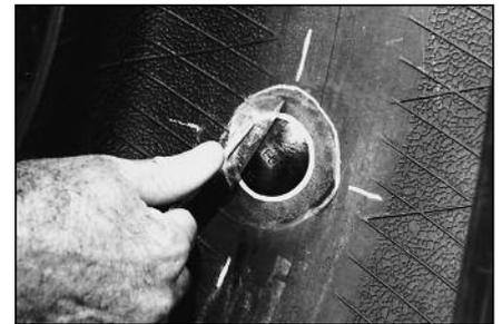
**22** Удалите прозрачную полиэтиленовую защитную пленку.
