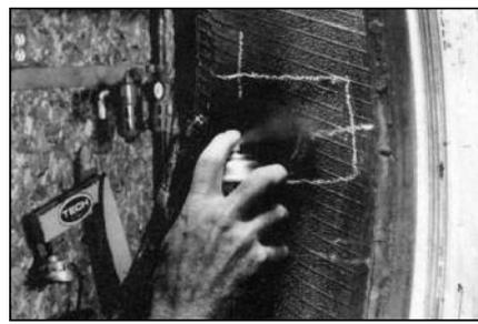
**42** Нанесите чистящую жидкость с помощью атомайзера № 975 на отмеченную область покрывки.
