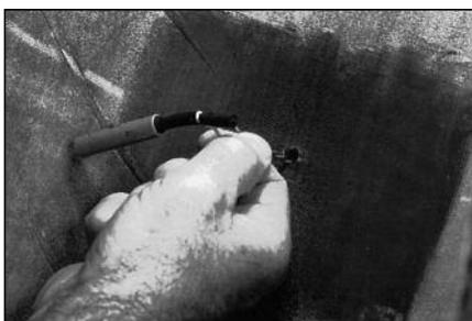
**14** Удалите спиральное шило из прокола и вставьте проволочный металлический держатель в прокол с внутренней стороны покрышки. Протолкните металлический держатель наружу.
