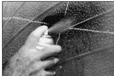
**7** Очистите область изнутри покрышки вокруг повреждения на ширину 100 мм во всех направлениях чистящей жидкостью с помощью атомизера (распылителя). Помещение при этом должно хорошо проветриваться.
