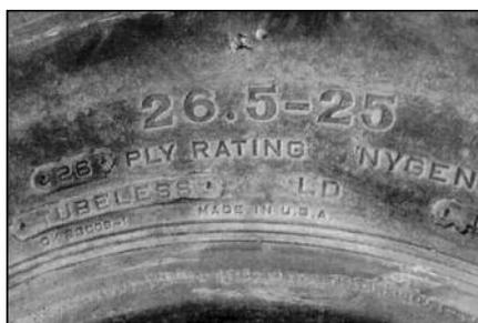
**22** Определите число слоев корда на покрышке, затем по таблице выбора заплат TOR (см. приложение) выберите заплату.
