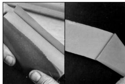
**51** Разорвите перфорацию на синей защитной плёнке и полностью снимите её. Важно не касаться серого слоя руками!
