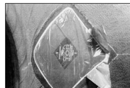
**53** По мере применения пневмомолотка снимайте полиэтиленовое покрытие, но сразу не более, чем по 50 мм во избежание сохранения воздуха под заплатай.
