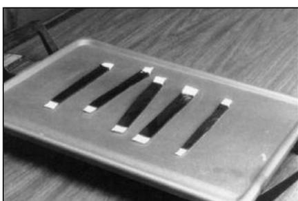
**38** Нарезьте достаточное количество полосок резины для горячей вулканизации шириной 1 см. Для наиболее качественного заполнения повреждения нагрейте предварительно резину до температуры 49°- 55°С.
