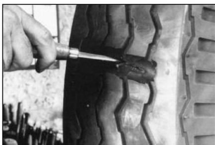
**10** Используя специальный нож № 940, окончательно удалите резину из повреждённого места покрышки. Нож должен быть направлен под углом 90° к покрышке.
