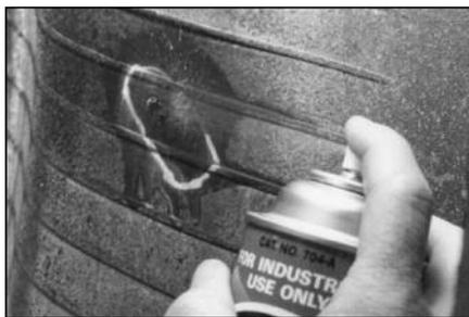
**7** Нанесите чистящую жидкость № 704 на отмеченную область покрывки с помощью атомайзера (распылителя) № 975.
