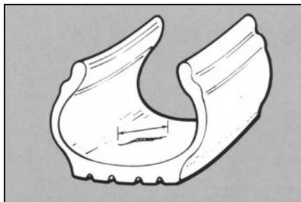
**5** Измерьте с внутренней стороны покрывки максимальный размер повреждения, а затем проверьте по таблице по выбору радиальных заплат Centech (см. приложение), подлежит ли покрывка ремонту.
