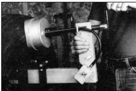
**37** Установите вулканизатор на покрывку, предварительно убедившись, что нагревательные элементы находятся по центру пореза снаружи и изнутри шины. Для точного расположения нагревательных элементов по центру используйте нарисованные восковым мелком линии.
