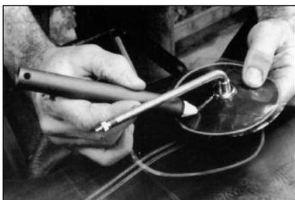
**7** Плотнo прикрутите новый вентиль к подложке и мелом отметьте на ней направление вентиля для правильной установки подложки и предотвращения возможной утечки воздуха в дальнейшем.
