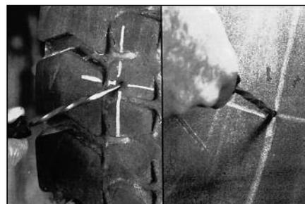
**3** Исследуйте повреждение с внешней и внутренней стороны шины с помощью спирального шила. Проверьте глубину и угол прокола снаружи и изнутри.
