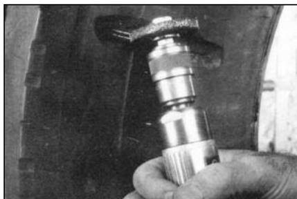
**11** Удалите оставшуюся резину между нитями корда с помощью металлощётки в полиуретане № S890 на низкооборотной дрели. Обработайте порез так, чтобы обнажились только те нити корда, которые повреждены по всей длине пореза. При этом металлощётки в полиуретане не повреждают нити корда.
