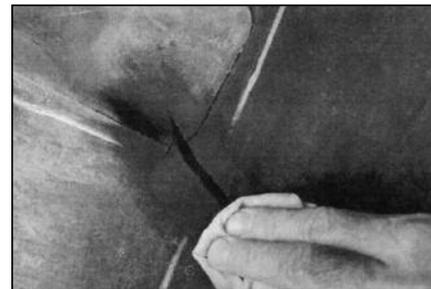
**9** Нанесите обезжиривающую (чистящую) жидкость на ткань не содержащую ворс и очистите место повреждения, двигаясь от центра ремонтируемой области к краям. Повторите эту процедуру 2-3 раза для хорошей очистки поверхности. Чистящая (обезжиривающая) жидкость должна полностью высохнуть.
