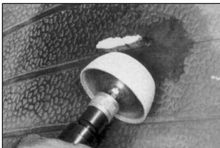
**19** Если Вы используете вулканизатор, обработайте область по периметру повреждения на ширину 50 мм изнутри покрышки мелкозернистой полусферой. Если Вы используете вулканизационную камеру, переходите к пункту 60 для подготовки повреждения изнутри к вулканизации.
