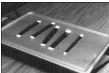
**28** Нарезьте достаточное количество полос из сырой резины толщиной 3 мм, чтобы заполнить обработанный порез. Предварительно положите полоски резины на нагревательный стол и нагрейте примерно до 49°-55°С.
