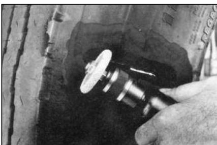
**16** Обработайте покрышку с внешней стороны по периметру на ширину 40 мм вокруг повреждения шероховальным кругом с зернистостью (230 SSG) или мелкозернистой абразивной полусферой на низкооборотной дрели.
