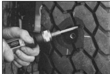
**15** Обработайте канавки протектора шерохователем в виде абразивного карандаша для лучшего последующего приклеивания вулканизирующей резины. Скорость вращения дрели при обработке не должна превышать 5000 об/мин.
