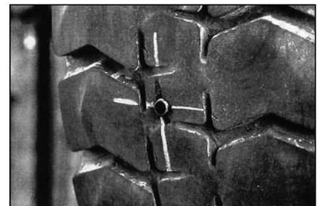
**25** Ремонт завершен. Шина готова к эксплуатации.
