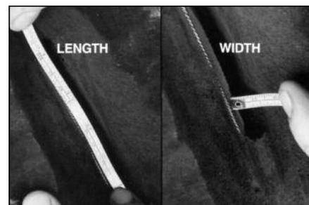
**21** Измерьте максимальную длину и ширину повреждения для последующего выбора необходимой заплаты.
