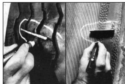
**1** Внимательно осмотрите покрышку с внешней и внутренней стороны, чтобы определить её ремонтпригодность (см. приложение). Зона осмотра должна быть хорошо освещена.
