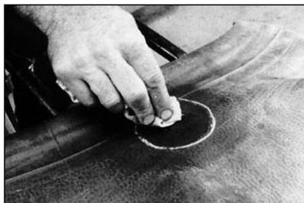
**7** После механической обработки (зачистки) камеры, нанесите на ткань обезжиривающую жидкость и очистите место повреждения, двигаясь от центра ремонтируемой области к краям. Повторите эту процедуру для хорошей очистки ремонтируемой поверхности. Дайте чистящей жидкости 3-4 минуты для того, чтобы полностью высохнуть.
