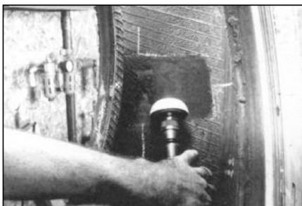
**44** Обработайте отмеченную область мелкозернистой абразивной полусферой на низкооборотной дрели до получения ровной шероховатой поверхности. Это нужно для увеличения площади контакта заплаты с покрывкой. При работе всегда пользуйтесь защитными очками № S918.
