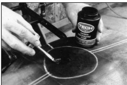
**10** Нанесите тонкий слой клея от центра ремонтируемой области к краям. Не наносите дополнительный слой клея, так как это только увеличит время его высыхания. Дайте клею примерно 3-4 минуты для того, чтобы он полностью высох.
