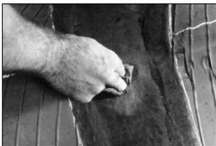
**49** Нанесите чистящую жидкость на ткань не содержащую ворс и тщательно очистите место повреждения, двигаясь от центра ремонтируемой области к краям. Дайте чистящей жидкости 3-4 минуты, чтобы полностью высохнуть.
