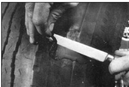
**40** После окончания вулканизации отсоедините линию подачи воздуха и снимите вулканизатор с покрывки. Дайте покрывке остыть, а затем специальным ножом отрежьте остатки непроваренной резины на покрывке.
