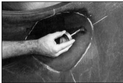
**47** Нанесите слой клея № 760 для холодной вулканизации на обработанную поверхность. Дайте клею примерно 3-5 минут для того, чтобы он полностью высох. Если ремонтируемая область камерной покрышки обработана до синтетических нитей корда, нанесите на нее 2 слоя клея и увеличьте время высыхания вдвое.
