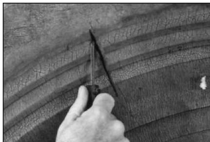
**2** Для определения характера повреждения и возможного расслоения корда обследуйте повреждение изнутри и снаружи с помощью спирального шила № 915.
