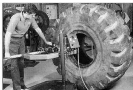
**84** Используя указательные линии, установите вулканизатор по центру повреждения. Затяните его в соответствии с рекомендациями производителя.
