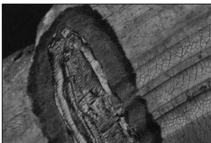
**35** Порез должен быть заполнен сырой резиной так, чтобы она выступала на 6-9 мм над поверхностью покрышки. Максимальная толщина слоя сырой резины должна находиться по центру поврежденного места и уменьшаться к его краям.
