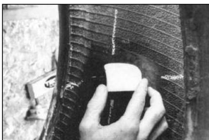
**29** Вырежьте платформу сырой резины толщиной 3 мм и шириной на 25 мм больше, чем размеры обработанного повреждения. Расположите платформу сырой резины с внутренней стороны покрышки строго по центру повреждения.
