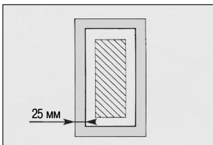
**64** Снятие серого бутилового слоя резины изнутри рекомендуется на покрышках с количеством слоев корда больше 20. На рисунке область снятия верхнего слоя резины заштрихована. Средняя жирная линия это периметр заплаты. Внешняя линия на расстоянии 25 мм от линии периметра заплаты ограничивает область шерохования.
