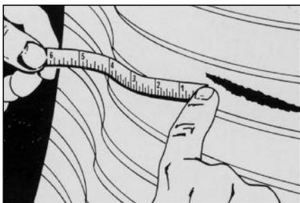
**4** Измерьте расстояние между обоим кольцом шины и краем повреждения изнутри шины. Если повреждение находится в неремонтируемой зоне A-B по таблице, то шина ремонту не подлежит.
