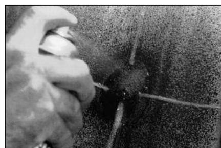
**6** Нанесите чистящую (обезжиривающую) жидкость № 704 на отмеченную область покрышки с помощью атомайзера (распылителя).
