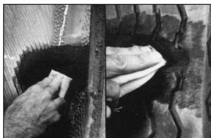
**22** Нанесите на ткань чистящую жидкость и тщательно очистите место повреждения изнутри и снаружи покрышки, двигаясь от центра ремонтируемой области к краям. Дайте чистящей жидкости 3-4 минуты, чтобы полностью высохнуть. Если корд обнажён, увеличьте время высыхания чистящей жидкости в 2 раза.
