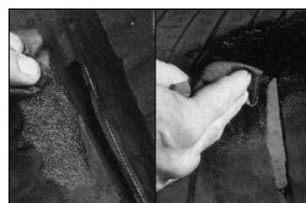
**27** Нанесите чистящую жидкость на ткань не содержащую ворс и тщательно очистите место повреждения изнутри и снаружи покрышки. Дайте чистящей жидкости 3-5 минут, чтобы полностью высохнуть.
