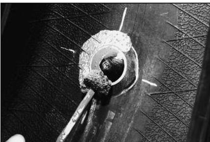
**23** При ремонте бескамерной покрышки нанесите специальный герметик № 736 по периметру шляпки грибка и на оставшуюся обработанную поверхность. При ремонте камерной покрышки нанесите тальк во избежание слипания краев шляпки грибка и камеры.
