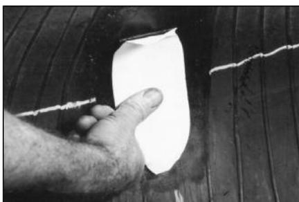
**31** Вырежьте платформу из сырой резины толщиной 3 мм и размером на 25 мм больше, чем размеры обработанного повреждения внутри покрышки. Расположите платформу по центру повреждения и прижмите ее большим пальцем.
