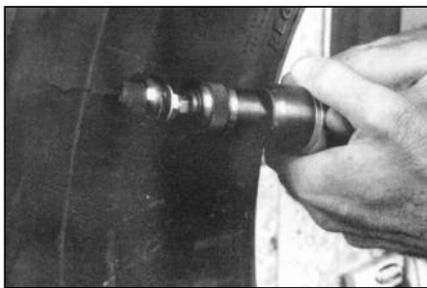
**10** Снимите верхний слой резины в месте повреждения с внешней стороны покрышки колпачковыми обрезателями, установленными на низкооборотной дрели (максимальная скорость вращения 5000 об/мин).
