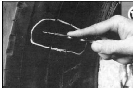
**3** С помощью спирального шила № 915 определите размер повреждения с внешней стороны шины и проверьте, не расслоились ли нити корда.
