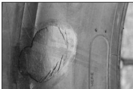
**44** После вулканизации извлеките покрывку из вулканизатора и дайте ей остыть. Проверьте качество ремонта.
