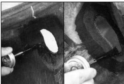
**24** Нанесите слой клея для холодной или горячей вулканизации на очищенное место повреждения изнутри и снаружи покрывки и дайте ему высохнуть.
