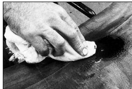
**3** Очистите ремонтируемую область с помощью чистящей (обезжиривающей) жидкости и ткани, не содержащей ворс.
