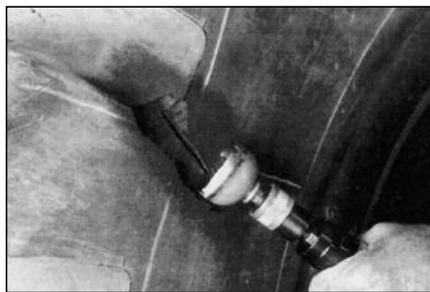
**11** Удалите резину в месте повреждения с внешней стороны покрышки колпачковым обрезателем № S2045, установленными на низкооборотной пневмодрели (максимальная скорость вращения 5000 об/мин). **Внимание!** Всегда одевайте защитные очки № S918.
