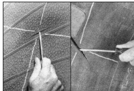
**3** После осмотра покрышки проверьте повреждение изнутри и снаружи спиральным шилом для определения расслоения слоев корда и длины повреждения.
