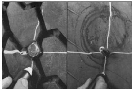
**2** При осмотре найдите и отметьте восковым маркировочным мелком № 951 все повреждения изнутри и снаружи покрывки.
