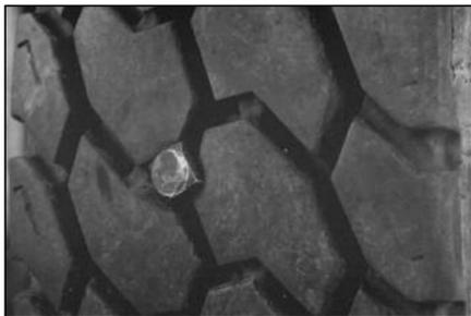
**1** Внимательно осмотрите покрывку с внешней и внутренней стороны, найдите повреждения, чтобы определить, подлежит ли она ремонту (см. приложение). Зона осмотра должна быть хорошо освещена.
