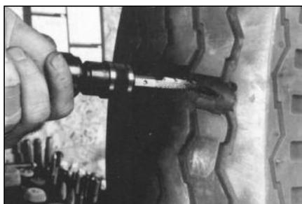
**11** Шерохователем типа "карандаш" с мелкой зернистостью (230 SSG), установленным на низкооборотной дрели, обработайте основание повреждения и закруглите его концы, чтобы оно не увеличилось после ремонта.
