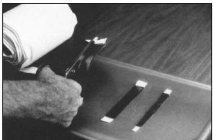
**25** Нарезьте достаточное количество полос из сырой резины толщиной 3 мм, чтобы заполнить обработанный порез. Предварительно положите полоски резины на нагревательный стол и нагрейте до 49°-55°С.
