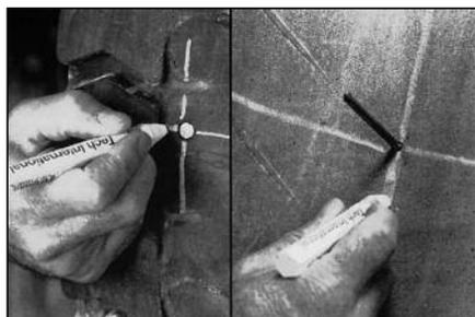
**1** Обозначьте место повреждения покрышки с внешней и внутренней стороны с помощью воскового маркировочного мелка № 951.
