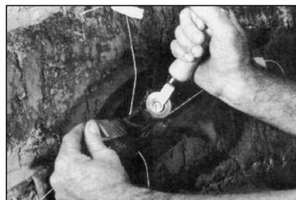
**81** Закончите процесс заполнения сырой резиной толщиной 6 мм и раскаткой. Сырая резина должна выступать над поверхностью покрышки на 3-6 мм, чтобы на нее оказывалось равномерное давление
