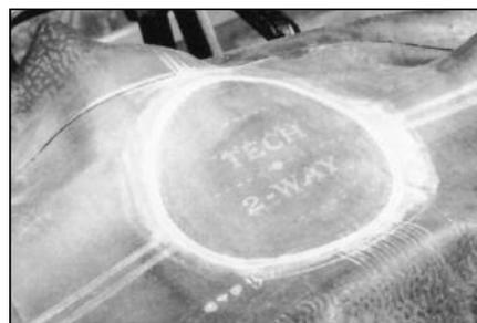
**3** Отремонтируйте поврежденный участок камеры в месте, где был старый вентиль, заплаткой TECH для ремонта камер соответствующего размера, следуя инструкции по ремонту RM-1 автомобильных камер.
