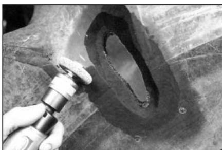
**15** Обработайте с внешней стороны покрышки область вокруг повреждения по периметру на ширину 40 мм шероховальным кругом с зернистостью (230 SSG) или мелкозернистой абразивной полусферой на низкооборотной дрели (максимальная скорость вращения 5000 об/мин).
