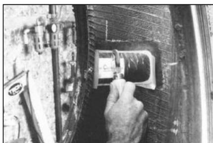
**50** Тщательно прикатайте заплату раскаткой № 936 от центра к краям. Нажимайте на раскатку для обеспечения более плотного контакта заплата и покрышки.
