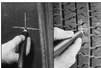
**2** Обозначьте место повреждения покрышки с внешней и внутренней стороны с помощью воскового маркировочного мелка № 951.
