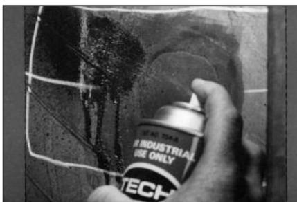
**37** Нанесите чистящую жидкость № 704 с помощью атомайзера (распылителя) № 975 на отмеченную область покрывки.
