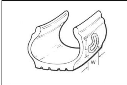
**20** На данном рисунке показано, как правильно измерять размеры повреждения. Длина измеряется от бортика до борта, а ширина по горизонтали параллельно беговой дорожке.
