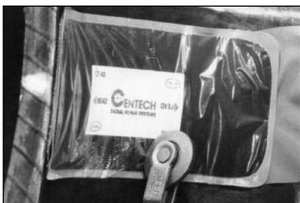
**35** Тщательно прикатайте центральную часть заплатки раскаткой № 936 от середины к краям. Нажимайте на раскатку для обеспечения более плотного прилегания заплатки к покрышке.
