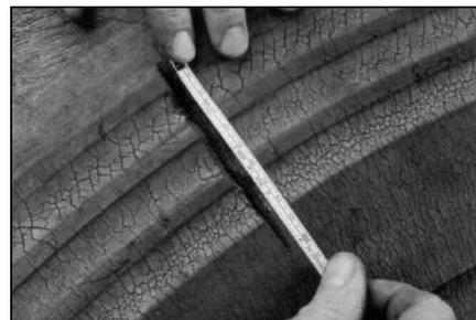
**3** Определите длину и ширину повреждения для определения ремонтпригодности. Если есть скрытые повреждения, прибавьте их размер.
