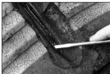
**11** Определите глубину повреждения. Учтите, что данная шина имеет слой защитного корда в боковой стенке, что усложняет определение степени повреждения до основного корда. Если это сделать невозможно, необходимо сначала удалить защитный корд в месте повреждения.
