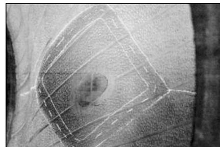
**42** Удаление серого бутилового верхнего слоя резины изнутри покрышки рекомендуется на покрышках с числом слоев корда больше 20 для увеличения адгезии. На рисунке показано, как отмечать область для снятия. Далее в пунктах 64 и 65 подробно описано, как отмечать разные области вокруг заплаты для обработки.
