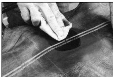
**5** Очистите ремонтируемую область с помощью чистящей (обезжиривающей) жидкости № 704 и ткани, не содержащей ворс.
