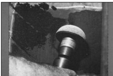
**39** Обработайте отмеченную область мелкозернистой абразивной полусферой на низкооборотной дрели (не более 5000 об/мин) до получения ровной поверхности. Это необходимо для увеличения площади соприкосновения заплаты с покрывкой.
