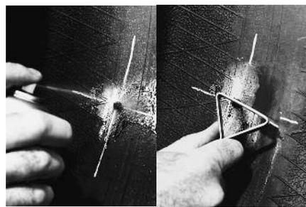
**5** Нанесите чистящую (обезжиривающую) жидкость № 704 на отмеченную область покрышки с помощью атомайзера (распылителя) № 975. Пока отмеченная область еще влажная, удалите грязь скребком. Повторите эту процедуру, как минимум, 2-3 раза.
