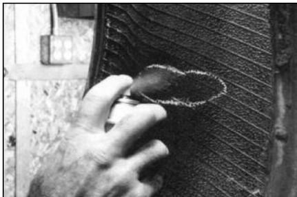
**7** Если покрывка подлежит ремонту, нанесите чистящую жидкость на отмеченную область покрывки с помощью атомизера (распылителя).
