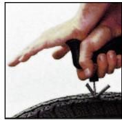
рис.2 Жгуты PERMACURE можно легко установить, применяя спиральное шило и ручку для установки жгутов.
