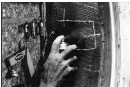
**46** Нанесите чистящую жидкость №704Е с помощью атомайзера №975 на отмеченную область покрышки.
