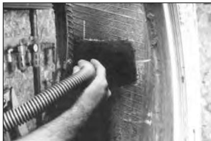
**50** Очистите пылесосом №S999 обработанную область для удаления металлической стружки и мелких частиц резины.
