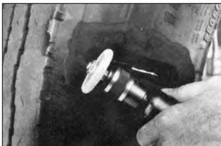
**19** Обработайте покрышку с внешней стороны по периметру на ширину 40 мм вокруг повреждения шероховатым кругом с зернистостью (230 SSG) или мелкозернистой абразивной полусферой на низкооборотной дрели.
