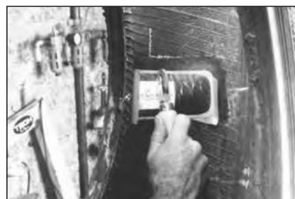
**54** Тщательно прикатайте заплату раскаткой №936 от центра к краям. Нажимайте на раскатку для обеспечения более плотного контакта заплаты и покрышки.
