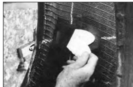
**39** Снимите с сырой резины защитную полиэтиленовую пленку.
