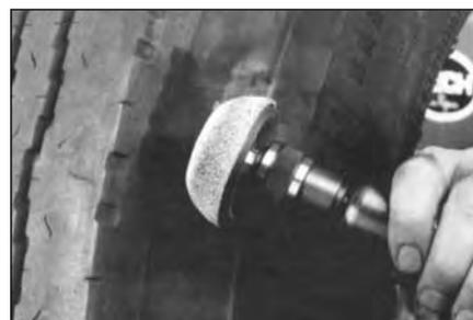
**57** Используя мелкозернистую абразивную полусферу на низкооборотной дрели, обработайте место ремонта покрышки снаружи так, чтобы оно стало вровень с остальной поверхностью покрышки. Обработку производите движениями от центра повреждения к краям. Эта операция носит косметический характер.
