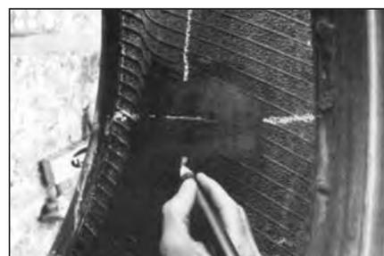
**30** Обозначьте место повреждения покрышки с внешней и внутренней стороны восковым маркировочным мелком. Нарисуйте указательные линии под прямым углом к повреждению на внутренней стороне покрышки в виде креста, чтобы легче можно было отцентрировать заплату.
