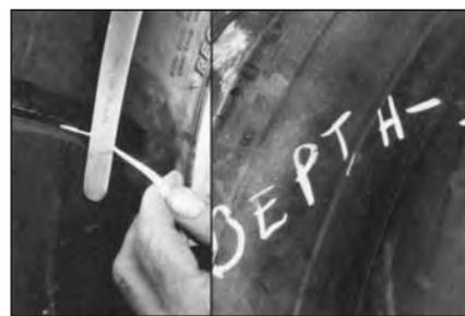
**27** Для дальнейшей вулканизации вам необходимо измерить толщину резинового слоя. Измерьте максимальную глубину пореза и запишите ее значение на внешней стороне покрышки.
