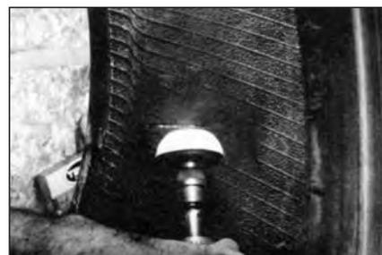
**21** Обработайте покрышку с внутренней стороны по периметру на ширину 40 мм вокруг повреждения мелкозернистой абразивной полусферой на низкооборотной дрели. Вы должны получить ровную платформу для вулканизационной резины.
