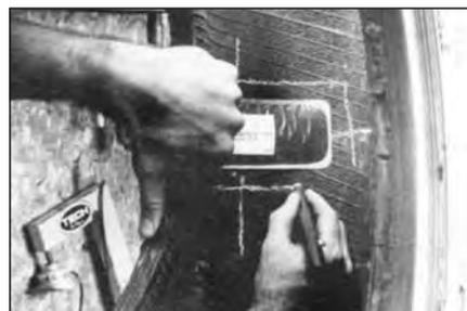
**45** Используя нарисованные вами линии (см. пункт 30), расположите заплату, выбранную заранее (см. пункт 26), по центру повреждения. Обведите заплату маркировочным мелком по периметру на расстоянии примерно 25 мм от краев заплаты. Это будет область для механической обработки шерохователем.
