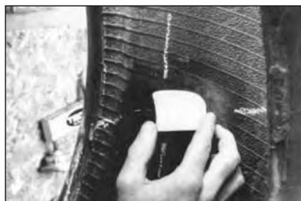
**33** Вырежьте платформу сырой резины толщиной 3 мм и шириной на 25 мм больше, чем размеры обработанного повреждения. Расположите платформу сырой резины с внутренней стороны покрышки строго по центру повреждения.
