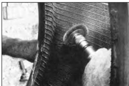
**20** Обработайте края пореза внутри покрышки с помощью текстурной проволочной щетки №S893 на низкооборотной дрели, чтобы придать им необходимую шероховатую текстуру.
