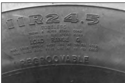
**25** По сведениям, указанным на боковой поверхности покрышки, определите ширину профиля покрышки, а также является ли покрышка камерной или бескамерной.
