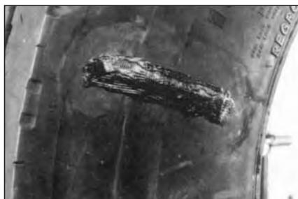
**38** Порез должен быть заполнен сырой резиной так, чтобы она выступала на 3-6 мм над поверхностью покрышки. Самая большая толщина слоя сырой резины должна находиться по центру поврежденного места и уменьшаться к его краям.
