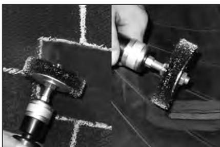
**28** Очистите место повреждения мягкой проволочной щеткой на низкооборотной дрели с последующей очисткой пылесосом.
