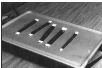
**32** Нарежьте достаточное количество полос из сырой резины толщиной 3 мм, чтобы заполнить обработанный порез. Предварительно положите полоски резины на нагревательный стол и нагрейте примерно до 49°-55°С.
