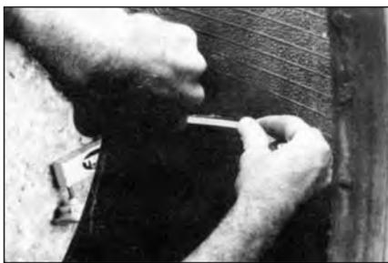
**23** Измерьте длину и ширину обработанного повреждения изнутри покрышки для правильного выбора заплаты.
