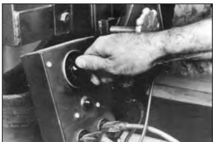
**43** Установите таймер, используя расчетное время вулканизации.
