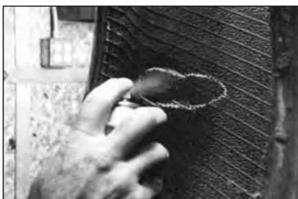
**7** Если покрывка подлежит ремонту, нанесите чистящую жидкость №704E на отмеченную область покрывки с помощью атомайзера (распылителя) №975.
