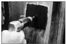
Подготовьте повреждение с помощью карбидной фрезы на пневмодрели. Скорость вращения пневмодрели при обработке прокола не должна превышать 1200 об/мин. Используйте вращение по часовой стрелке. Обработайте прокол с внутренней стороны покрышки. Повторите эту процедуру как минимум три раза.
