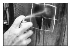
8 Нанесите чистящую жидкость на отмеченную область покрышки с помощью атомайзера №975.
