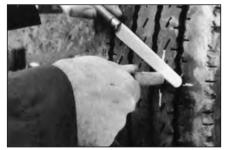
Отрежьте выступающую часть ножки грибка вровень с поверхностью покрышки. Если ножка закрывает канавку рисунка протектора, вы можете нарезать протектор заново в месте ремонта.
