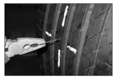
Вытяните ножку грибка плоскогубцами за металлический стержень, пока он не встанет на место. При этом проверьте совпадение направления стрелки к ободу.
