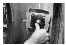
Как только грибок установлен на место, нажмите на шляпку грибка большим пальцем и прижмите его к шине.
