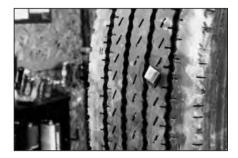
Внимательно осмотрите покрышку с внешней и внутренней стороны, чтобы определить ее ремонтопригодность (см. приложение). Зона осмотра должна быть хорошо освещена.
