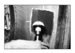
Обработайте отмеченную область абразивной полусферой на пневмодрели. Скорость вращения пневмодрели при обработке не должна превышать 4000 об/мин.
