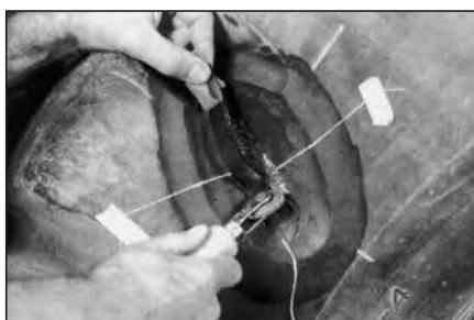
**32** Заполняйте до того момента, когда можно использовать раскатку, прокатайте сырую резину так, чтобы повреждение было заполнено до уровня 3-6 мм над поверхностью покрышки. При подготовке повреждения в плечевой области или в зоне протектора нужно сделать перемычку в канавке протектора, чтобы резина не вытекала при вулканизации. Перемычки можно делать из частиц резины, остающихся при шероховке, из алюминиевой фольги или алебаstra.
