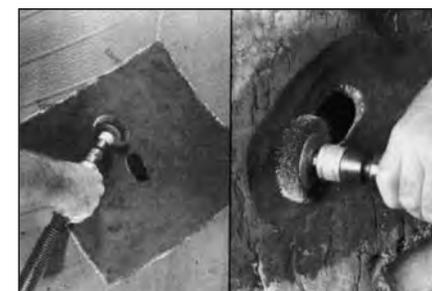
**68** Очистите область вокруг повреждения изнутри и снаружи покрышки проволочной щеткой №892 на низкооборотной дрели.
