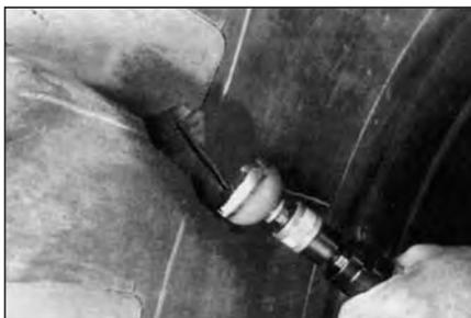
**11** Удалите резину в месте повреждения с внешней стороны покрышки колпачковым обрезателем №S2045, установленными на низкооборотной пневмодрели (максимальная скорость вращения 4000 об/мин). **Внимание!** Всегда надевайте защитные очки №S918.
