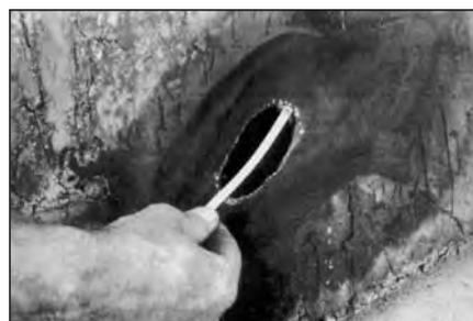
**61** Измерьте максимальную длину зоны повреждения корда, чтобы определить размер повреждения. Определите число слоев корда в покрышке и выберите заплата по таблице TOR (см. приложение).
