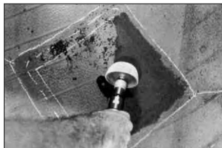
**66** Крупнозернистой полусферой на низкооборотной дрели снимите верхний бутиловый слой резины в пределах внутренней сплошной отмеченной линии. При этом полусфера всегда должна вращаться в одну сторону по поверхности, что предотвратит задираание бутилового слоя резины. Обрабатывайте бутиловый наружный слой резины до тех пор, пока под ним не появится внутренний слой каландровой резины. Вы заметите его появление по изменению цвета. Он более черный.
