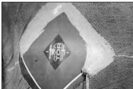
**57** При ремонте бескамерной покрышки нанесите герметик №738 на края заплатай и по периметру вокруг заплатай.
