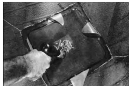
**76** Используя пневмомолоток №S990, прижмите заплата к месту ремонта, а затем прикатайте ее раскаткой, двигаясь от центра к краям.
