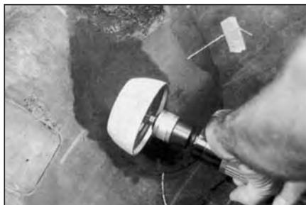
**58** Механически обработайте область повреждения с наружной стороны покрышки шероховальной полусферой до получения ровной поверхности на одном уровне с первоначальной поверхностью покрышки. При этом полусфера должна вращаться в направлении от центра повреждения к краям. Это позволит отремонтированной области иметь такую же гибкость, как и вся покрышка.
