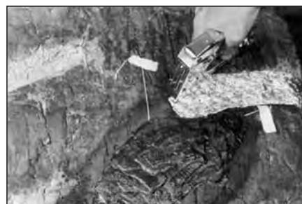
**83** При использовании вулканизационной камеры или вулканизатора типа Монафлекс перед проведением вулканизации в области протектора и в плечевой области необходимо поставить перемычку в канавке протектора, чтобы остановить «растекание» резины во время вулканизации.
