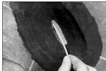
**21** Измерьте максимальную длину повреждения корда, чтобы определить размер заплаты.
