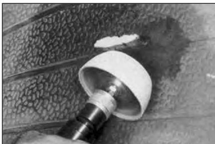
**19** Изнутри покрышки обработайте область вокруг повреждения шириной 50 мм во все стороны мелкозернистой полусферой. Далее при применении комбинированного метода с использованием вулканизатора следуйте указаниям пунктов с 20 по 59. **Если вы используете одноэтапный метод с использованием вулканизационной камеры или вулканизатора типа Монафлекс, сразу переходите к пункту 60, минуя пункты с 20 по 59.**
