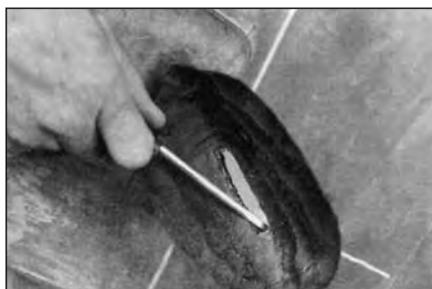
**13** Проверьте повреждение по периметру, чтобы определить, что все поврежденные нити корда удалены.
