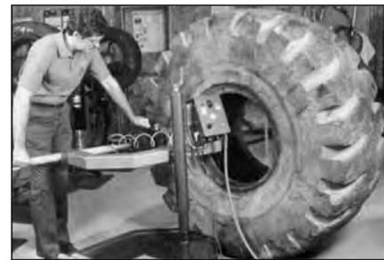
**36** Используя указательные линии, установите вулканизатор по центру повреждения. Затяните его в соответствии с рекомендациями производителя.
