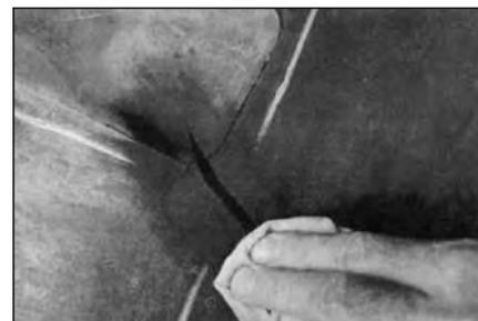
**9** Нанесите обезжиривающую (чистящую) жидкость на ткань, не содержащую ворс, и очистите место повреждения с наружной стороны покрышки, двигаясь от центра ремонтируемой области к краям. Повторите эту процедуру 2-3 раза для хорошей очистки поверхности. Чистящая (обезжиривающая) жидкость должна полностью высохнуть.
