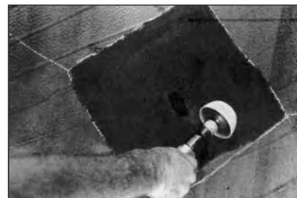
**67** Среднезернистой или мелкозернистой полусферой на низкооборотной дрели обработайте каландровый слой резины до получения бархатной текстуры. Затем сформируйте наклон по направлению к первоначальному контуру заплатки. После этого слегка обработайте поверхность покрышки изнутри за пределами контура заплатки.
