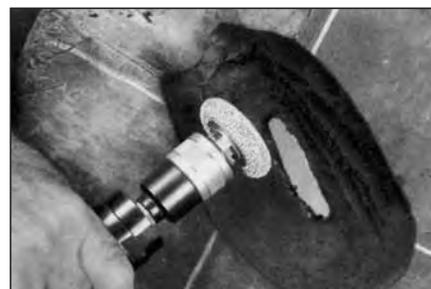
**15** Используя крупнозернистый шероховальный круг на низкооборотной дрели, удалите всю подгоревшую резину и неровности и постарайтесь, чтобы угол скоса повреждения был  $45^\circ$ , если оно на боковой поверхности шины, а на повреждениях в плечевой области и в области протектора  $60^\circ$ .
