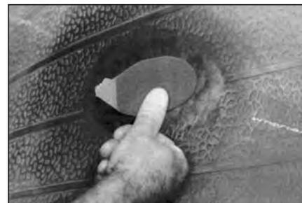
**27** Отрежьте кусок сырой резины толщиной 3 мм и размером примерно на 25 мм больше размера повреждения и положите его на повреждение изнутри покрышки. Он будет использоваться как платформа.
