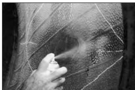
**40** Очистите обведенную область изнутри покрышки чистящей жидкостью №704Е с помощью атомизера (распылителя) №975.
