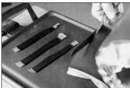
**29** Нарезьте достаточное количество полос сырой резины для заполнения повреждения снаружи покрышки и положите их на поддон, нагретый до температуры 50-55°С. Нагрев сырой резины сокращает возможность сохранения воздуха в ней.
