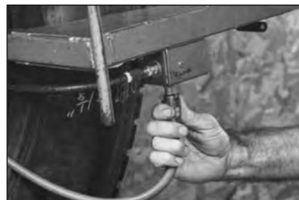
**36** После окончания процесса вулканизации отсоедините линию подачи воздуха и снимите вулканизатор с покрышки. Дайте покрышке остыть, а затем, используя нож, отрежьте остатки непроваренной резины на покрышке. Это обычно не требуется, если вы используете вулканизатор с пневмоподжимом.
