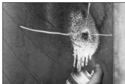
**6** Нанесите чистящую жидкость №704E на отмеченную область изнутри покрывки с помощью атомайзера (распылителя) №975.
