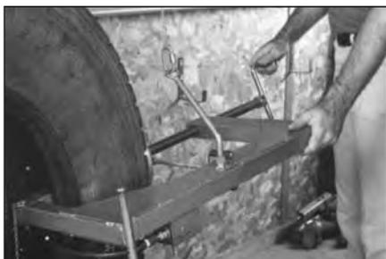
**34** Установите вулканизатор на покрышку, предварительно убедившись, что нагревательные элементы находятся по центру пореза снаружи и внутри шины. Установите пневмоподжим на вулканизаторе, подсоединив линию подачи воздуха.
