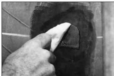
**32** Снимите с сырой резины защитную полиэтиленовую пленку.
