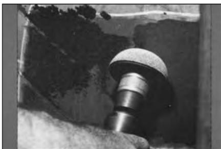
**40** Обработайте отмеченную область мелкозернистой абразивной полусферой на низкооборотной дрели (не более 4000 об/мин) до получения ровной поверхности. Это необходимо для увеличения площади соприкосновения заплаты с покрышкой.
