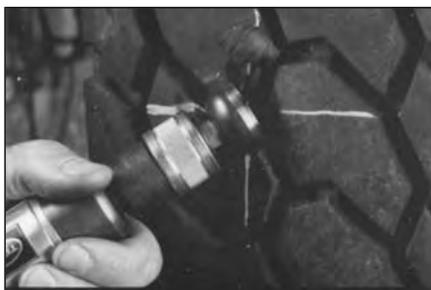
**8** Удалите резину в месте повреждения с внешней стороны покрывки колпачковым обрезателем №S2045, установленным на низкооборотной пневмодрели (максимальная скорость вращения 4000 об/мин). **Внимание!** Старайтесь не повредить при этом стальные нити корда.
