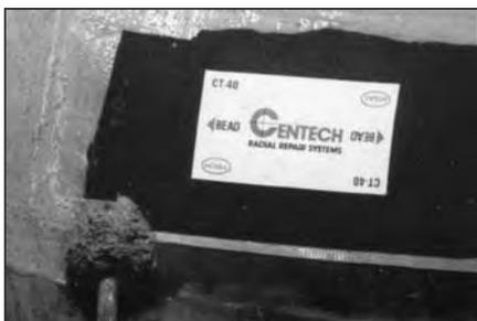
**49** При ремонте бескамерной покрышки нанесите герметик №738 по периметру заплаты и на оставшуюся обработанную поверхность. Если ремонтируете камерную покрышку, посыпьте отремонтированное место тальком №706. Это предотвратит слипание серого слоя на краях заплаты и камеры.
