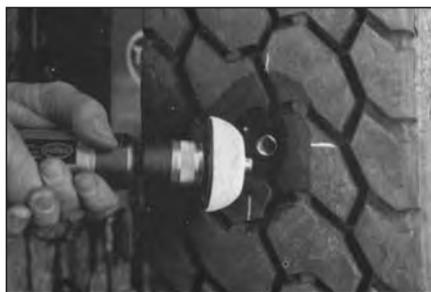
**14** Обработайте область вокруг повреждения на ширину от 40 до 50 мм абразивной полусферой на низкооборотной пневмодрели.
