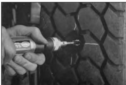
**13** Обработайте края пореза снаружи покрышки короткой проволочной щеткой №S896 на низкооборотной дрели, чтобы придать им необходимую шероховатую текстуру, так как происходит пригорание резины при использовании инструмента на высокооборотной дрели. Держите щетку под углом 90°.
