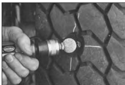
**11** Удалите все неровности шероховальным шариком с зернистостью (390 SSG) на низкооборотной дрели. Скорость вращения дрели при обработке не должна превышать 4000 об/мин.
