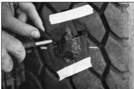
**31** Канавки протектора в месте ремонта заполните кусочками резины, чтобы сырая резина в процессе вулканизации не растекалась по рисунку протектора и не вулканизировала его. Если канавка большая, можно использовать гипс или алюминиевую фольгу в качестве блокирующего материала.
