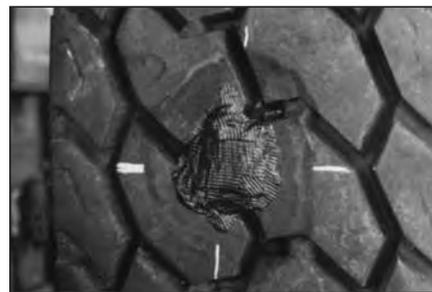
**30** Порез должен быть заполнен сырой резиной так, чтобы она выступала на 3-6 мм над поверхностью покрышки. Самая большая толщина слоя сырой резины должна находиться по центру поврежденного места и уменьшаться к его краям.
