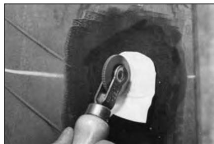
**25** Подготовьте сырую резину для использования. Нарезьте достаточное количество полосок резины для горячей вулканизации для заполнения повреждения. Предварительно нагрейте резину до температуры 49° - 55°С.
