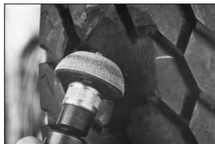
**51** Обработайте место ремонта покрышки снаружи мелкозернистой абразивной полусферой на низкооборотной пневмодреде (не более 4000 об/мин) так, чтобы поверхность покрышки стала ровной.
