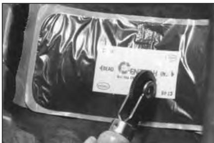
**46** Тщательно прикатайте заплату раскаткой №936 от центра к краям. Нажимайте на раскатку для обеспечения более плотного прилегания заплаты к покрышке.
