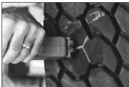
**53** Нарезьте канавки с помощью регрувера №1571631 (S146B) для нарезки протектора. Глубина нарезки должна совпадать с глубиной уже существующих канавок.
