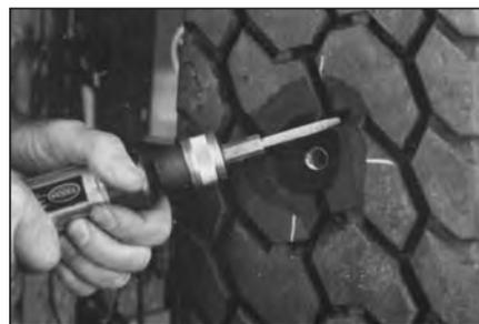
**15** Обработайте канавки протектора шерохователем в виде абразивного карандаша для лучшего последующего приклеивания вулканизирующей резины. Скорость вращения дрели при обработке не должна превышать 4000 об/мин.
