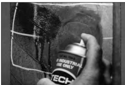
**38** Нанесите чистящую жидкость №704Е с помощью атомайзера (распылителя) №975 на отмеченную область покрышки.
