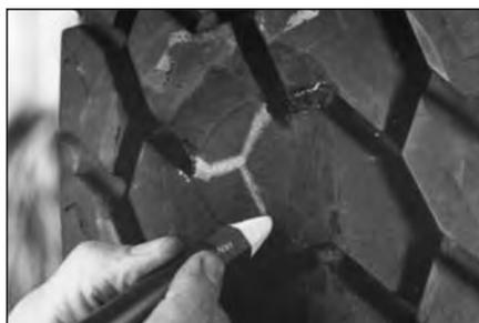
**52** Вы можете нарезать протектор заново в месте ремонта, если вулканизированное место закрывает канавку рисунка протектора. Это обеспечит необходимую гибкость отремонтированному месту повреждения и исключит нагрев покрышки в этом месте. Отметьте канавки восковым маркирующим мелком.
