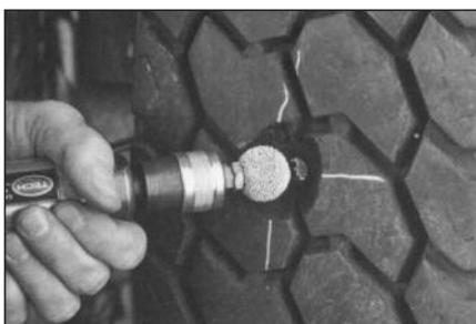
**11** Удалите все неровности шероховатым шариком с зернистостью (390 SSG) на низкооборотной дрели. Скорость вращения дрели при обработке не должна превышать 5000 об/мин.
