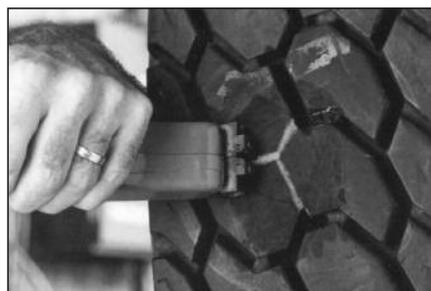
**52** Нарезьте канавки с помощью регрувера № S145 для нарезки протектора. Глубина нарезки должна совпадать с глубиной уже существующих канавок.
