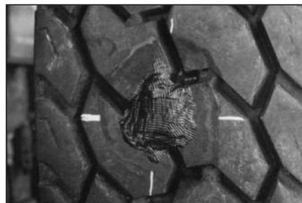
**29** Порез должен быть заполнен сырой резиной так, чтобы она выступала на 3-6 мм над поверхностью покрышки. Самая большая толщина слоя сырой резины должна находиться по центру поврежденного места и уменьшаться к его краям.
