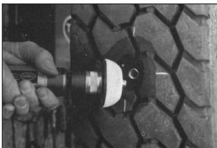
**14** Обработайте область вокруг повреждения на ширину от 40 до 50 мм абразивной полусферой на низкооборотной пневмодреде.
