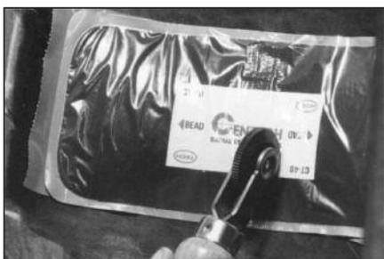
**45** Тщательно прикатайте заплату раскаткой № 936 от центра к краям. Нажимайте на раскатку для обеспечения более плотного прилегания заплаты к покрышке.
