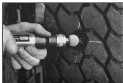
**12** Для получения необходимой текстуры обработайте повреждение снаружи стороны покрышки шероховатым шариком с зернистостью (230 SSG) на низкооборотной пневмодреде. Держите шерохователь под углом 45°.
