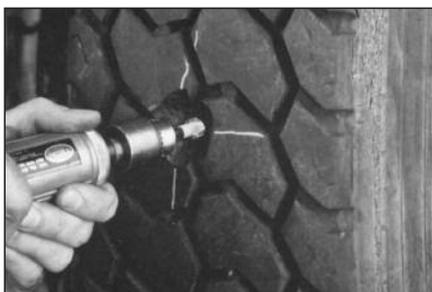
**10** Используя камень из оксида алюминия № S872 на высокооборотной пневмодреде, обработайте все расплывшиеся нити стального корда до самой резины в месте повреждения. При этом действуйте с перерывами, чтобы резина не подгорала.
