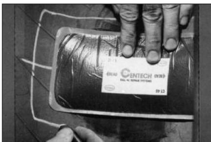
**36** Используя нарисованные Вами линии (см. пункт 2), приложите заплату, выбранную ранее (см. пункт 19) на повреждение по центру. Обведите периметр заплаты восковым маркировочным мелком примерно на 25 мм больше размеров заплаты. Это область для механической обработки шероховкой.
