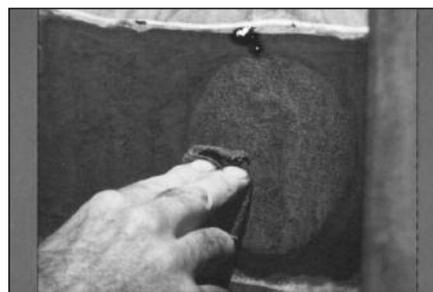
**41** Нанесите чистящую жидкость № 704 на ткань не содержащую ворса и очистите место повреждения, двигаясь от центра к краям. Повторите эту процедуру столько раз, сколько требуется для хорошей очистки ремонтируемой поверхности. Дайте чистящей жидкости 3-5 минут, чтобы полностью высохнуть (во влажных условиях время высыхания увеличивается).
