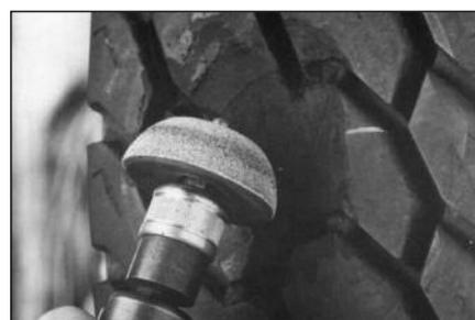
**50** Обработайте место ремонта покрышки снаружи мелкозернистой абразивной полусферой на низоборотной пневмодрели (не более 5000 об/мин) так, чтобы поверхность покрышки стала ровной.
