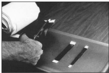
25 Нарежьте достаточное количество полос из сырой резины толщиной 3 мм, чтобы заполнить обработанный порез. Предварительно положите полоски резины на нагревательный стол и нагрейте до 49°-55°C.
