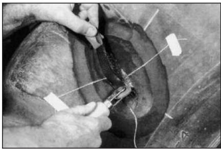
32 Заполняйте до того момента, когда можно использовать раскатку, прокатайте сырую резину так, чтобы повреждение было заполнено до уровня 3-6 мм над поверхностью покрышки. При подготовке повреждения в плечевой области или в зоне протектора нужно сделать перемычку в канавке протектора, чтобы резина не вытекала при вулканизации. Перемычки можно делать из частиц резины, остающихся при шероховке, из алюминиевой фольги или алеабстра.
