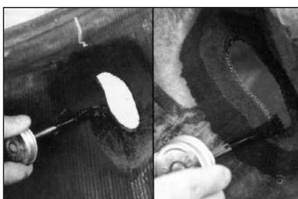
**24** Нанесите слой клея для холодной или горячей вулканизации на очищенное место повреждения изнутри и снаружи покрышки и дайте ему высохнуть.
