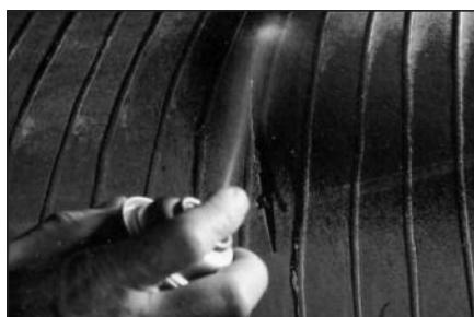
**4** Измерьте расстояние между ободным кольцом шины и краем повреждения изнутри шины. Если повреждение находится в неремонтируемой зоне А-В по таблице, то шина ремонту не подлежит.
