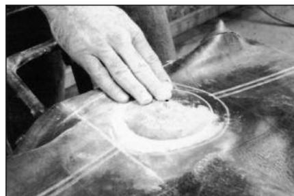
**15** Удалите прозрачную полиэтиленовую пленку с подложки и посыпте отремонтированное место тальком № 706. Это предотвратит прилипание серого слоя подложки к внутренней поверхности покрышки.
