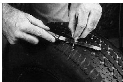
**15** Отрежьте оставшиеся на поверхности части жгута с внешней стороны покрышки.
