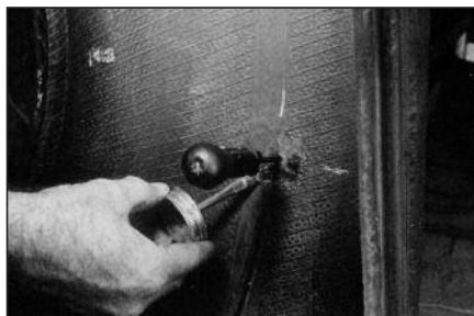
**13** Нанесите клей для химической вулканизации № 760 на обработанную поверхность. Дайте клею примерно 3-4 минуты для того, чтобы он полностью высох. При ремонте камерной покрышки обработайте область до синтетических нитей корда, нанесите на нее 2 слоя клея. При работе в помещении с высокой влажностью или низкой температурой необходимо увеличить время высыхания клея.
