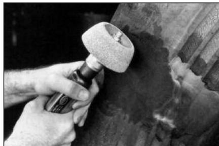
59 Используя абразивную полусферу на низкооборотной дрели, снимите излишки резины с внешней стороны покрышки по направлению от центра к краям до получения ровной поверхности.
