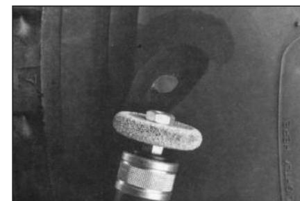
**18** Обработайте область по периметру вокруг повреждения на ширину от 25 до 40 мм тем же шероховальным кругом или абразивной полусферой на низкооборотной дрели.
