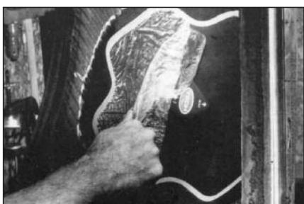
**49** Снимите прозрачную полиэтиленовую пленку с заплаты.
