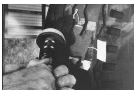
**52** Используя мелкозернистую абразивную полусферу на низкооборотной дрели, обработайте место ремонта покрышки снаружи так, чтобы оно стало вровень с остальной поверхностью покрышки.
