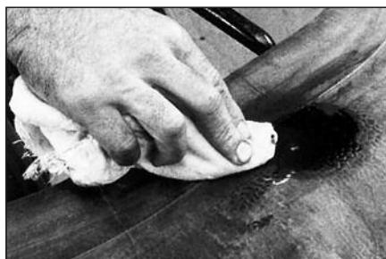
3 Очистите ремонтируемую область с помощью чистящей (обезжирающей) жидкости № 704 и ткани, не содержащей ворса.
