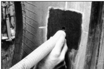
**13** Очистите пылесосом № S999 обработанную область для удаления металлической стружки и резиновой пыли.
