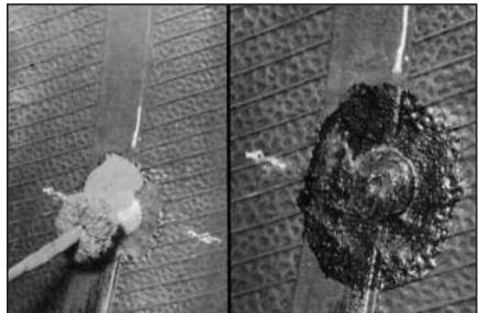
**19** При ремонте бескамерной покрышки нанесите герметик № 738 по периметру шляпки грибка и на оставшуюся обработанную поверхность. При ремонте камерной покрышки, нанесите тальк № 706 во избежание слипания краев шляпки грибка и камеры.
