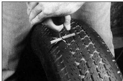
**12** Установите ручку с иглой № 925, содержащую жгут, в повреждение покрышки.
