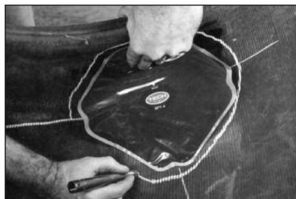
**42** Используя нарисованные ранее линии (см. пункт 17), приложите заплату, выбранную ранее (см. пункт 21) на центр повреждения изнутри покрышки. Обведите маркировочным мелком заплату по периметру примерно на 25 мм от краёв заплаты. Это область для механической обработки шероховкой.
