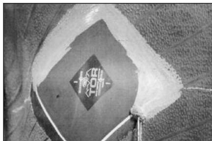
**57** При ремонте бескамерной покрышки нанесите герметик № 738 на края заплаты и по периметру вокруг заплаты.
