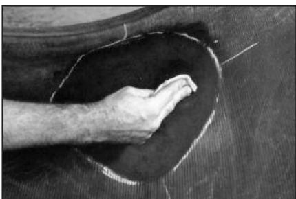
**46** Нанесите чистящую жидкость на ткань не содержащую ворс и тщательно очистите место повреждения, двигаясь от центра ремонтируемой области к краям. Дайте чистящей жидкости 3-4 минуты, чтобы полностью высохнуть. Увеличивайте время высыхания в 2 раза на камерных шинах.
