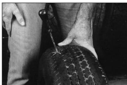
4 Определите угол прокола или повреждения с помощью спирального шила № 915.
