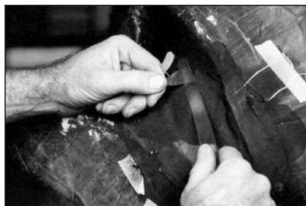
**41** Отрежьте ножом остатки «непроваренной» резины на покрышке. Это обычно не требуется, если Вы используете вулканизатор с пневмоподжимом.
