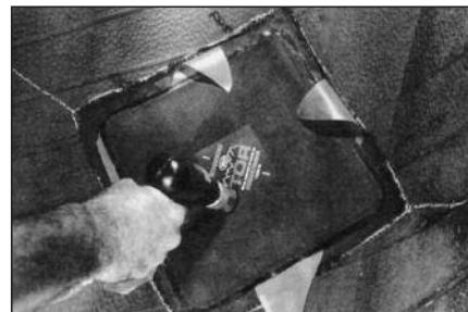
76 Используя пневмомолоток № S990, прижмите заплату к месту ремонта, а затем прикатайте ее раскаткой, двигаясь от центра к краям.
