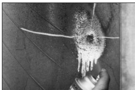
4 Определите размер повреждения и возможное расслоение слоёв корда с помощью спирального шила с тупым концом.
