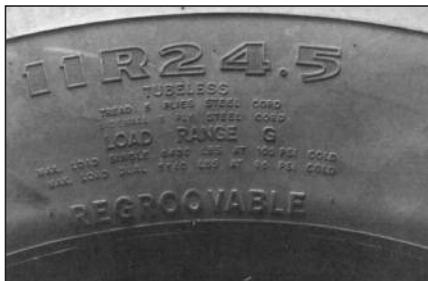
**21** По сведениям, указанным на боковой поверхности покрышки, определите ширину профиля покрышки, а также, является ли покрышка камерной или бескамерной.
