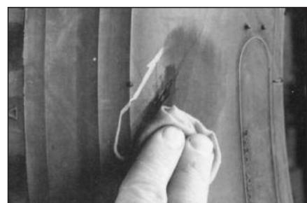
**7** Нанесите чистящую жидкость № 704 на отмеченную область покрышки с помощью атомайзера (распылителя) № 975.
