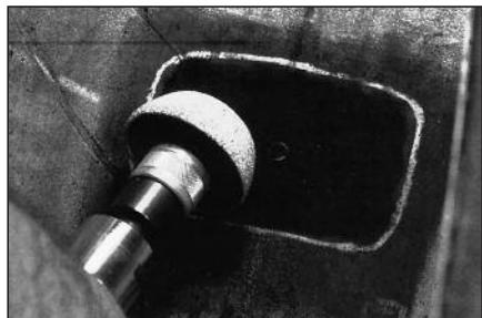
**19** Обработайте выступающую часть ножки, а затем отмеченную область мелкозернистой абразивной полусферой. Скорость вращения дрели при обработке не должна превышать 5000 об/мин.
