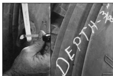
**23** Для вулканизации в дальнейшем вам необходимо знать толщину резинового слоя. Измерьте максимальную глубину пореза и запишите её значение снаружи покрышки.
