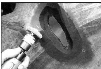
**15** Обработайте с внешней стороны покрышки область вокруг повреждения по периметру на ширину 40 мм шероховальным кругом с зернистостью (230 SSG) или мелкозернистой абразивной полусферой на низкооборотной дрели (максимальная скорость вращения 5000 об/мин).
