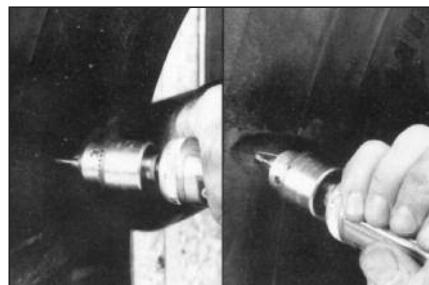
**14** Отрежьте с помощью алмазного бура № 280 на высокомощной дрели (при минимальной скорости вращения 20 000 об/мин) все концы поврежденных нитей металлокорда. Держите бур под углом 90° к нити корда. Если повреждено большое количество нитей корда, используйте алмазный бур № 283 совместно со шлифовальным камнем из оксида алюминия № S872 для их обработки.
