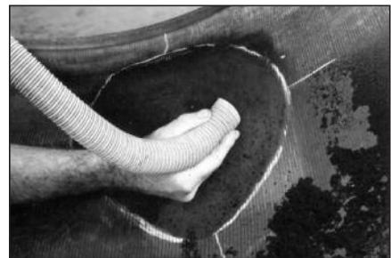
**45** Очистите пылесосом № S999 обработанную область для удаления металлической стружки и мелких частиц резины.
