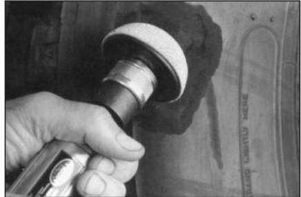
**46** Обработайте место ремонта покрышки снаружи мелкозернистой абразивной полусферой на низко-оборотной дрели со скоростью вращения не более 5000 об/мин., чтобы поверхность покрышки стала ровной. Обработку производите движениями от центра повреждения к краям. Эта операция носит косметический характер.
