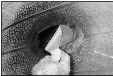
33 Снимите с платформы сырой резины, уложенной в пункте 27, защитное полиэтиленовое покрытие.
