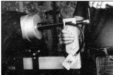
**37** Установите вулканизатор на покрышку, предварительно убедившись, что нагревательные элементы находятся по центру пореза снаружи и изнутри шины. Для точного расположения нагревательных элементов по центру используйте нарисованые восковым мелком линии.
