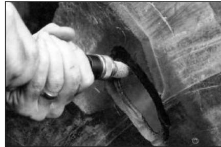
**13** Шерохователем типа "карандаш" с мелкой зернистостью (230 SSG), установленным на низкооборотной дрели (максимальная скорость вращения 5000 об/мин), обработайте основание повреждения и закруглите его концы, чтобы оно не увеличилось после ремонта.
