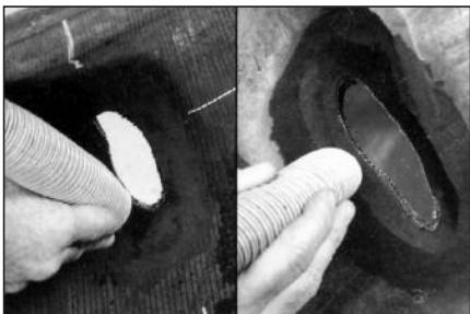
**18** Очистите вакуумным пылесосом № S999 обработанную область, чтобы удалить частицы резины и резиновой пыли с внутренней и внешней стороны покрышки.
