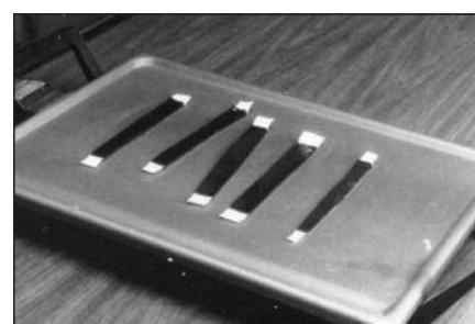
24 Подготовьте сырью резину для использования. Нарежьте достаточное количество полосок резины для горячей вулканизации для заполнения повреждения. Предварительно нагрейте резину до температуры 49° - 55°C.
