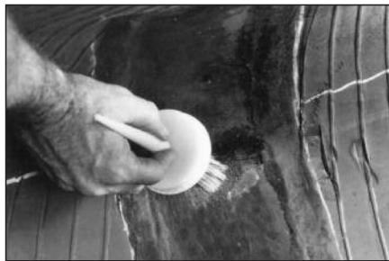
**50** Нанесите клей для холодной вулканизации на всю обработанную область двигаясь от центра к краям. Дайте клею высохнуть в течение 3–5 минут.
