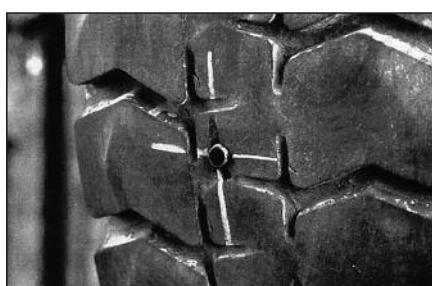
25 Ремонт завершен. Шина готова к эксплуатации.
