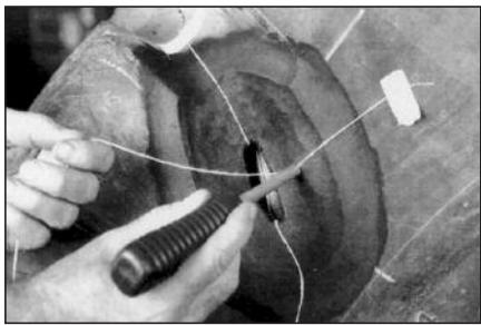
30 Перед заполнением повреждения сырой резиной положите на него крест-накрест тонкие х/б нити, как показано на рисунке. Они должны заканчиваться на расстоянии 50 мм от краев повреждения. Эти вентиляционные нити позволяют лишнему воздуху выходить из резины при вулканизации.
