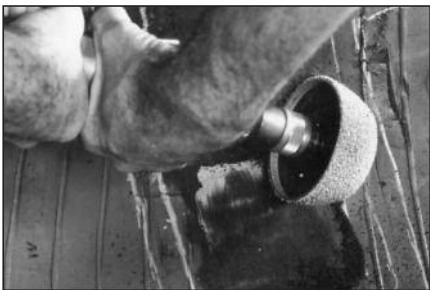
**46** Используя крупнозернистую шероховательную полусферу на низкооборотной дрели, снимите верхний слой резины в пределах заштрихованной области, пока не появится слой пористой резины. Обязательно используйте защитные очки № S918.
