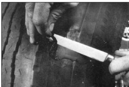
**40** После окончания вулканизации отсоедините линию подачи воздуха и снимите вулканизатор с покрышки. Дайте покрышке остыть, а затем гипским ножом № 942 отрежьте остатки непроваренной резины на покрышке.
