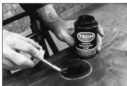
8 Нанесите тонкий слой клея для химической (холодной) вулканизации № 760, двигаясь от центра ремонтируемой области к краям. Не наносите второй (дополнительный) слой клея. Дайте клею примерно 3-4 минуты для того, чтобы он полностью высохнуть.
