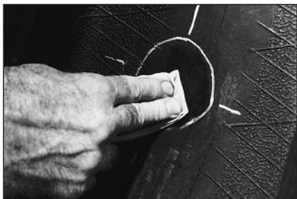
**11** Нанесите обезжиривающую (чистящую) жидкость № 704 на ткань не содержащую ворс и очистите место повреждения, двигаясь от центра ремонтируемой области к краям. Повторите эту процедуру столько раз, сколько требуется для хорошей очистки поверхности. Чистящая (обезжиривающая) жидкость должна полностью высохнуть.
