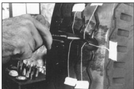
29 Утрамбуйте сырью резину в месте пореза покрышки тупым инструментом для трамбовки резины. Не старайтесь заполнять сразу большую область, так как Вы можете оставить воздушные мешки между утрамбованными слоями резины, что увеличит её пористость в месте ремонта после вулканизации. Трамбуйте резину до тех пор, пока не сможете перейти к раскатке.
