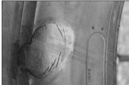
**44** После вулканизации извлеките покрышку из вулканизатора и дайте ей остыть. Проверьте качество ремонта.
