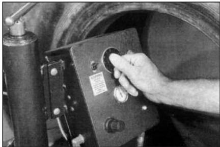
**37** Подайте давление на вулканизатор и установите на таймере время вулканизации. Не оставляйте включенный вулканизатор без внимания.
