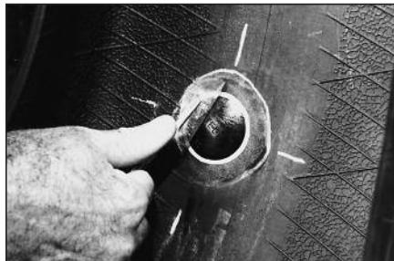
22 Удалите прозрачную полиэтиленовую защитную пленку.
