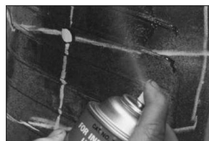
**26** Нанесите чистящую жидкость № 704 с помощью атомайзера (распылителя) № 975 на отмеченную область покрышки.
