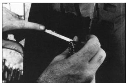
**17** Измерьте поврежденное место после обработки, чтобы определить необходимый размер заплаты ВР. Определите количество слоев корда в покрышке. Используйте таблицу по выбору диагональных заплат ВР (см. приложение). Не измеряйте глубину повреждения под углом 45°.
