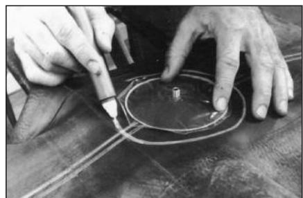
6 Приложите заплату по центру отверстия и обведите ее на расстоянии 15 мм. Это будет область для механической обработки камеры. Обозначьте на камере направление оригинального металлического вентиля для дальнейшего правильного монтажа камеры в ободе.
