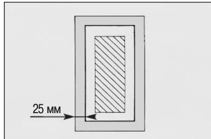
**64** Снятие серого бутилового слоя резины изнутри рекомендуется на покрышках с количеством слоев корда больше 20. На рисунке область снятия верхнего слоя резины заштрихована. Средняя жирная линия это períметр заплаты. Внешняя линия на расстоянии 25 мм от линии períметра заплаты ограничивает область шерохования.
