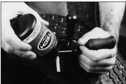
**10** Нанесите слой клея для химической вулканизации на жгут с двух сторон. Не опускайте жгут в банку с kleem, так как клей может загустеть в течение короткого времени.
