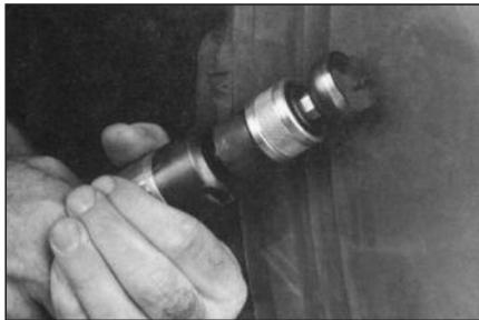
**10** Удалите резину в месте повреждения с внешней стороны покрышки колпачковым обрезателем № S2045, установленным на низкооборотной дрели (максимальная скорость вращения 5000 об/мин).
