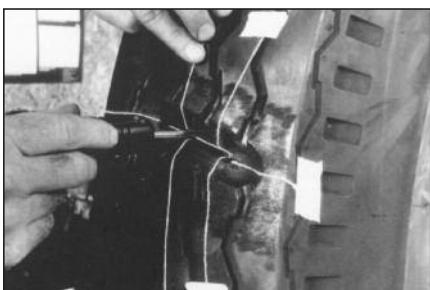
28 Положите в область пореза с внешней стороны покрышки х/б нити для вентиляции, чтобы снять давление воздуха с корда (внутри повреждённой части корда покрышки при вулканизации накапливается воздух). Закрепите пластирем концы нитей на внешней стороне покрышки примерно на расстоянии 75 мм от обработанной зоны повреждения.
