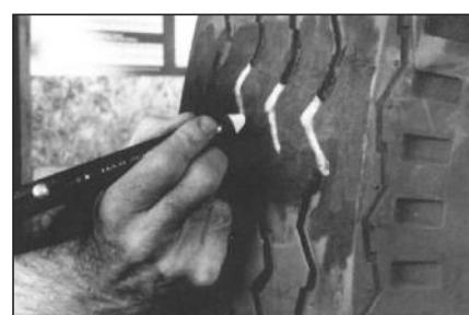
**53** Вы должны восстановить протектор в месте ремонта шины на беговой дорожке. Это обеспечит необходимую гибкость шины в месте ремонта и исключит её нагрев в этом месте. Сначала отметьте канавки маркировочным мелком.
