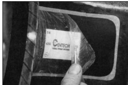
37 Снимите прозрачную полиэтиленовую пленку с заплаты.
