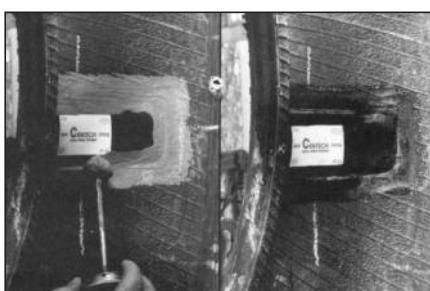
52 Снимите прозрачную полиэтиленовую пленку с заплаты. При ремонте бескамерной покрышки нанесите герметик заплат № 738 по периметру заплаты и на оставшуюся обработанную поверхность. Если Вы ремонтируете камерную покрышку, посыпьте отремонтированное место тальком № 736. Это предотвратит слипание серого слоя на краях заплаты и камеры.
