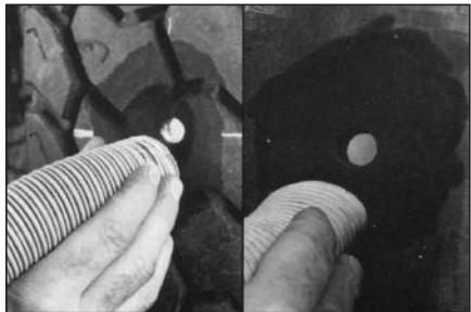
19 С помощью таблицы по выбору заплат Centech (см. приложение), а также на основании размеров повреждения и типа покрышки определите правильный номер заплаты, требуемой для ремонта. Найдите максимальный размер повреждения на беговой дорожке Вашей покрышки в таблице и посмотрите ширину поперечного профиля покрышки. На пересечении Вы найдете тип необходимой заплаты.
