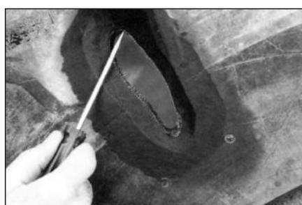
**16** С помощью спирального шила с тупым концом проверьте, что весь повреждённый корд удален.
