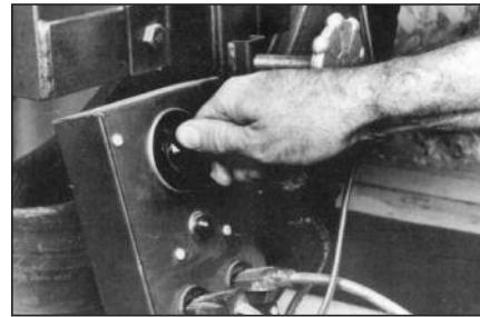
**39** Установите таймер, используя расчётное время вулканизации.
