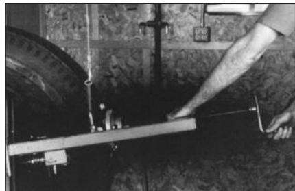
35 Установите вулканизатор на покрышке так, чтобы нагревательные элементы находились по центру пореза снаружи и изнутри шины.
