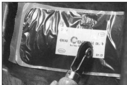
**45** Тщательно прикатайте заплату раскаткой № 936 от центра к краям. Нажмите на раскатку для обеспечения более плотного прилегания заплаты к покрышке.
