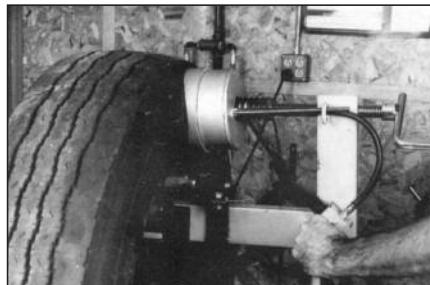
**38** Установите пневмоподжим на вулканизаторе, подсоединив линию подачи воздуха. Подайте давление воздуха не более 2 атм. Если Вы используете ручной вулканизатор без пневмоподжима, то Вам необходимо снова затянуть его через 5-10 минут после начала процесса вулканизации.
