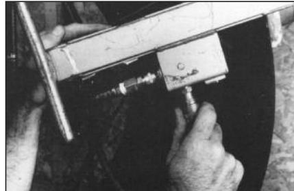
36 Установите пневмоподжим на вулканизаторе, подсоединив линию подачи воздуха. Подайте давление воздуха не более 2 атм. Если Вы используете ручной вулканизатор без пневмоподжима, то Вам необходимо снова затянуть его через 5-10 минут после начала процесса вулканизации.
