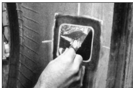
**27** Удалите прозрачную полиэтиленовую защитную пленку.
