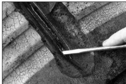
**11** Определите глубину повреждения. Учитите, что данная шина имеет слой защитного корда в боковой стенке, что усложняет определение степени повреждения до основного корда. Если это сделать невозможно, необходимо сначала удалить защитный корд в месте повреждения.
