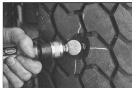
**11** Удалите все неровности шероховальным шариком с зернистостью (390 SSG) на низкооборотной дрели. Скорость вращения дрели при обработке не должна превышать 5000 об/мин.
