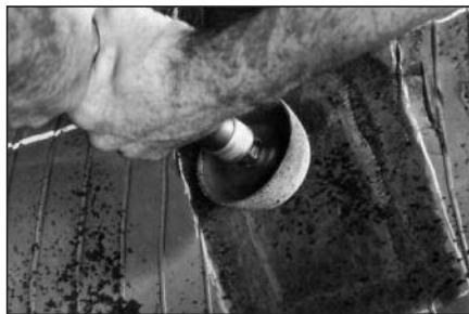
**47** Используя средне или мелкозернистую полусферу на низкооборотной дрели, обработайте пористый слой резины до получения ровной текстуры. Затем обработайте скос между внешним контуром по периметру заплаты и оставшимся участком заштрихованной области.
