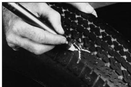
1 Найдите инородный предмет или повреждение и отметьте его с помощью воскового маркировочного мелка. При необходимости используйте жидкость для поиска проколов.
