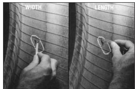
**4** Измерьте расстояние между краем обода покрышки и краем повреждения. Повреждение не должно находиться близко к посадочному месту на диске (в неремонтируемой зоне покрышки А-В).
