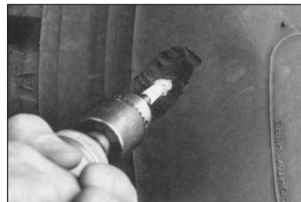
**15** Обработайте концы металлокорда камнем из оксида алюминия № S872 на высокооборотной дрели.
