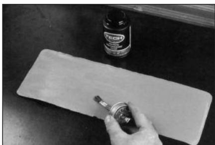
**52** Нанесите слой клея № 760 для холодной вулканизации на всю заплату для улучшения процесса холодной вулканизации.
