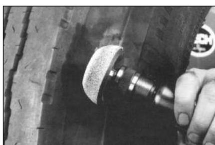
53 Используя мелкозернистую абразивную полусферу на низкооборотной дрели, обработайте место ремонта покрышки снаружи так, чтобы оно стало вровень с остальной поверхностью покрышки. Обработку производите движениями от центра повреждения к краям. Эта операция носит косметический характер.
