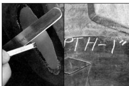
**19** Для определения времени вулканизации в Вам необходимо знать толщину шины в месте повреждения. Измерьте максимальную глубину пореза. Напишите размеры на внешней стороне покрышки для дальнейшего использования. Не измеряйте глубину повреждения под углом 45°.
