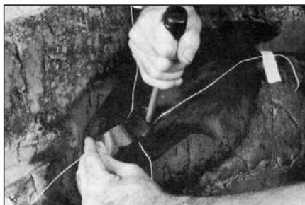
80 Уложите в повреждение полосы резины толщиной 3 мм, предварительно нагретые до температуры 50-60° С, и уплотните их с помощью трамбовки.
