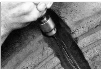
**13** Отрежьте с помощью алмазного бура № 283 на высокогооборотной дрели (при минимальной скорости вращения 20 000 об/мин) концы повреждённых нитей металлокорда с одного края повреждения. Держите бур под углом 90° к нити корда.
