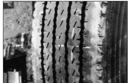
**30** Ремонт завершен. Шина готова к эксплуатации.
