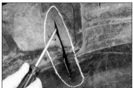
**4** Измерьте расстояние между краем обода покрышки и краями повреждения изнутри покрышки, чтобы определить неремонтируемую зону. Если повреждение попадает в неремонтируемую зону, покрышка не подлежит ремонту. Для покрышек размером 13.9 и меньше это расстояние 75 мм, для покрышек от 14.9 до 20.8 – 100 мм, для покрышек 23.1 и более – 150 мм.
