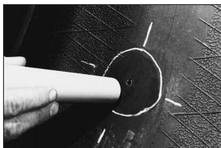
**10** Очистите пылесосом № S999 обработанную область для удаления металлической стружки и резиновой пыли.
