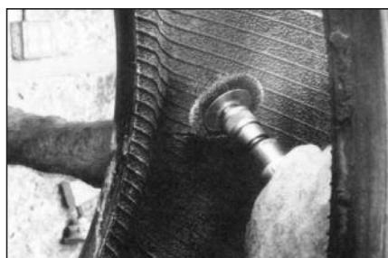
**17** Обработайте края пореза внутри покрышки с помощью текстурной проволочной щетки № S893 на низкооборотной дрели, чтобы придать им необходимую шероховатую текстуру.
