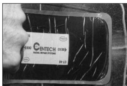
**25** Используя нарисованные Вами линии (см. пункт 24), расположите заплату, выбранную ранее (см. пункт 22), по центру повреждения. Обведите заплату маркировочным мелком по периметру на расстоянии примерно 25 мм от краев заплаты. Это будет область для механической обработки шерохователем.
