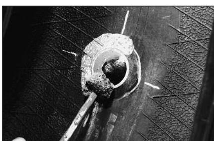
23 При ремонте бескамерной покрышки нанесите специальный герметик № 738 по периметру шляпки грибка и на оставшуюся обработанную поверхность. При ремонте камерной покрышки нанесите тальк во избежание слипания краев шляпки грибка и камеры.
