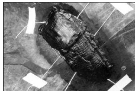
**31** Заполните повреждение так, чтобы сырая резина выступала на 3 - 6 мм над поверхностью покрышки (больше всего над центром обработанной области). Если повреждение находится в плечевой области покрышки, заполните повреждение до уровня на 9 мм выше поверхности покрышки, чтобы обеспечить нужное давление при вулканизации.
