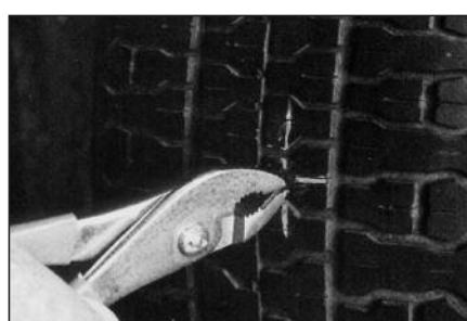
**16** Зажмите плоскогубцами металлический держатель с внешней стороны покрышки и вытяните ножку грибка. Если металлический держатель отделяется от ножки, когда ножка грибка выйдет из прокола, зажмите ее плоскогубцами и тяните до тех пор, пока подложка не коснется поверхности покрышки изнутри.
