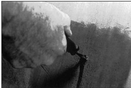
10 Нанесите клей для химической вулканизации № 760 внутрь прокола и по всей его длине с помощью спирального шила, поворачивая шило по часовой стрелке. Повторите эту процедуру от 3 до 5 раз. Оставьте шило в проколе до тех пор, пока не перейдете к выполнению пункта 14.
