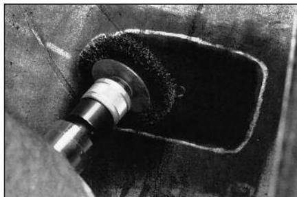
**20** Удалите частицы резины на обработанной области с помощью мягкой проволочной щетки № 893 и низкооборотной дрели. При этом двигайтесь справа налево.
