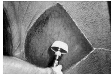
**44** Далее обработайте появившийся слой резины среднезернистой (SSJ 230) или мелкозернистой (SSJ 170) шероховальной полусферой на низкообратной дрели до получения бархатной текстуры. Далее сформируйте скос по направлению к первоначальному контуру заплаты. Затем слегка обработайте поверхность покрышки за пределами заплаты.
