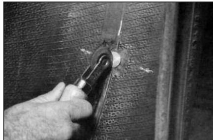
**18** Тщательно прикатайте шляпку грибка с помощью раскатки № 936 от центра к краям. Прижимайте раскатку достаточно сильно, чтобы обеспечить ДОСТАТОЧНУЮ холодную ВУЛКАНИЗАЦИЮ шляпки грибка.
