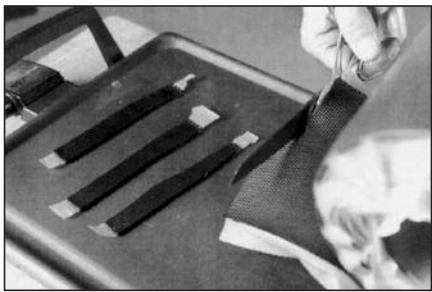
29 Нарежьте достаточное количество полос сырой резины для заполнения повреждения снаружи покрышки и положите их на поддон, нагретый до температуры 50-55°C. Нагрев сырой резины сокращает возможность сохранения воздуха в ней.
