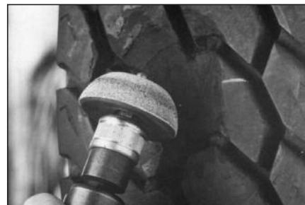
**50** Обработайте место ремонта покрышки снаружи мелкозернистой абразивной полусферой на низкооборотной пневмодрели (не более 5000 об/мин) так, чтобы поверхность покрышки стала ровной.
