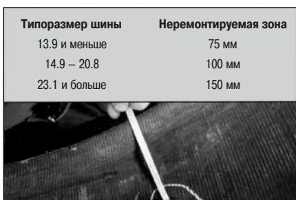
**2** Внимательно осмотрите покрышку с внешней и внутренней стороны, найдите повреждения, чтобы определить, подлежит ли она ремонту (см. приложение). Зона осмотра должна быть хорошо освещена.
