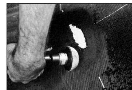
**17** Нарисуйте восковым мелком линии под прямым углом по центру повреждения изнутри покрышки для дальнейшей центровки заплаты по нему. Обработайте периметр вокруг повреждения на ширину 40 мм мелкозернистой абразивной полусферой на низкооборотной дрели. Вы должны получить ровную платформу для вулканизационной резины.
