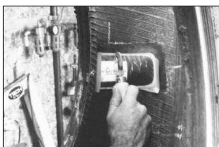
50 Тщательно прикатайте заплату раскаткой № 936 от центра к краям. Нажимайте на раскатку для обеспечения более плотного контакта заплаты и покрышки.
