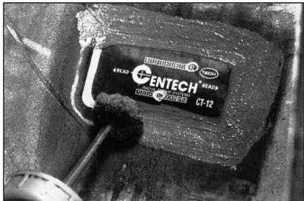
28 При ремонте бескамерной покрышки нанесите специальный герметик № 738 по периметру заплаты и на оставшуюся обработанную поверхность. При ремонте камерной покрышки нанесите тальк № 706 во избежание слипания краев заплаты и камеры.
