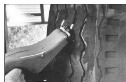
**54** Нарежьте канавки в протекторе с помощью специальной машинки-регувера № S145, но не глубже существующих канавок. Покрышка готова к эксплуатации.
