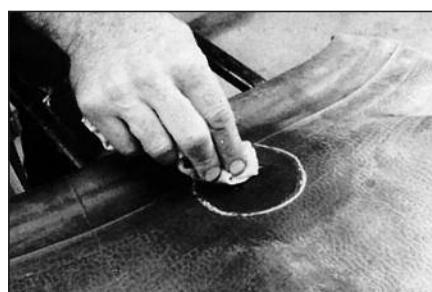
7 После механической обработки (зачистки) камеры, нанесите на ткань обезжирающую жидкость и очистите место повреждения, двигаясь от центра ремонтируемой области к краям. Повторите эту процедуру для качественной очистки ремонтируемой поверхности. Дайте чистящей жидкости 3-4 минуты для того, чтобы он полностью высохнуть.
