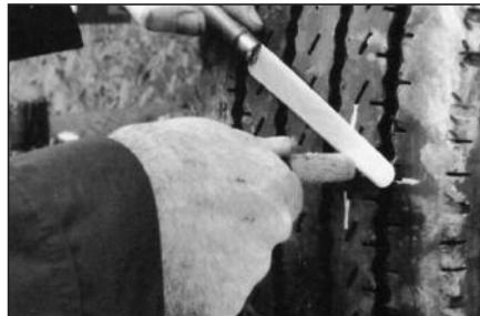
**29** Отрежьте выступающую часть ножки грибка бровень с поверхностью покрышки. Если ножка закрывает канавку рисунка протектора, Вы можете нарезать протектор заново в месте ремонта.
