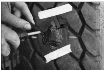
**30** Канавки протектора в месте ремонта заполните кусочками резины, чтобы сырья резина в процессе вулканизации не растекалась по рисунку протектора и не вулканизировала его. Если канавка большая, можно использовать гипс или алюминиевую фольгу в качестве блокирующего материала.
