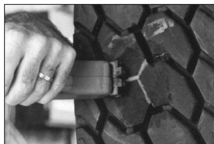
**52** Нарежьте канавки с помощью регуровера № S145 для нарезки протектора. Глубина нарезки должна совпадать с глубиной уже существующих канавок.
