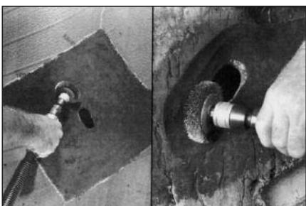
**68** Очистите область вокруг повреждения изнутри и снаружи покрышки проволочной щёткой № 892 на низкооборотной дрели.
