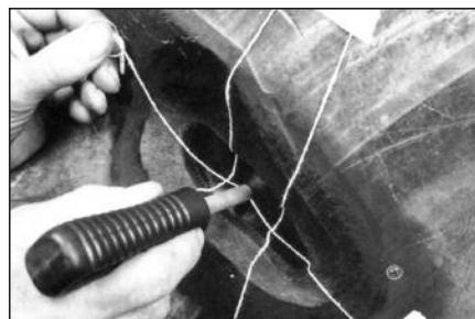
**28** Положите в область пореза с внешней стороны покрышки х/б нити для вентиляции, чтобы снять давление с корда (внутри поврежденной части корда покрышки при вулканизации накапливается воздух). Закрепите пластирем концы нитей на расстоянии 75 мм от краёв повреждения.
