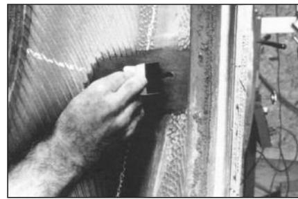
24 Вырежьте полоску сырой резины толщиной 3 мм и шириной на 25 мм больше, чем размеры обработанного повреждения. Расположите полоску сырой резины с внутренней стороны покрышки таким образом, чтобы она полностью перекрывала порез.
