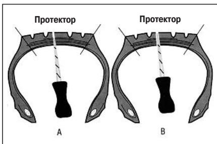
4 Если в прокол входит только заостренная часть спирального шила, то его диаметр 3 мм (ремонтируется ножкой грибка № 250-1, см. рисунок А). Если в прокол входит спиральная часть шила, то его диаметр 6 мм (ремонтируется ножкой грибка № 251-1, см. рисунок В).
