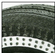
рис.1 Крупный план покрывки, содержащей 950 жгутов PERMACURE в боковой части. Покривка "прошла" 128.720 км при средней скорости 80 км/ч.
