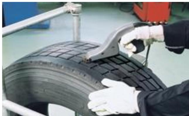
Нарезка протектора шин - сложная операция, которая должна выполняться квалифицированным персоналом в проветриваемом помещении.
