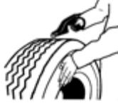
**9. Когда процесс нарезки протектора полностью завершен, ещё раз осмотрите шину, чтобы удостовериться, что вырезанная резина из дорожек протектора полностью удалена. После выполнения всех этих операций шина готова к эксплуатации.**
