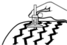
4. Измерьте остающуюся глубину протектора в нескольких местах вокруг шины и используйте наименьшие данные для того, чтобы правильно определить глубину нарезки. Нарезку следует производить, если глубина рисунка протектора составляет не менее 2 - 3 мм.
