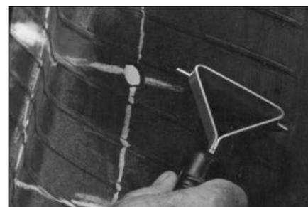
**25** Используя нарисованные Вами линии (см. пункт 24), расположите заплату, выбранную ранее (см. пункт 22), по центру повреждения. Обведите заплату маркировочным мелком по периметру на расстоянии примерно 25 мм от краёв заплаты. Это будет область для механической обработки шерохователем.
