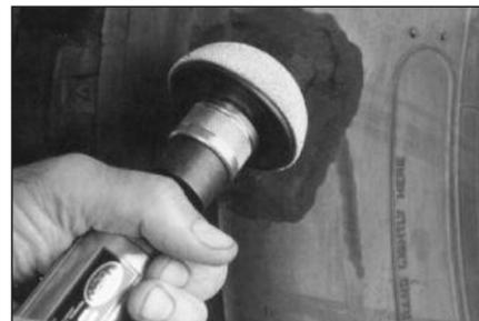
**46** Обработайте место ремонта покрывки снаружи мелкозернистой абразивной полусферой на низкооборотной дрели со скоростью вращения не более 5000 об/мин., чтобы поверхность покрывки стала ровной. Обработку производите движениями от центра повреждения к краям. Эта операция носит косметический характер.
