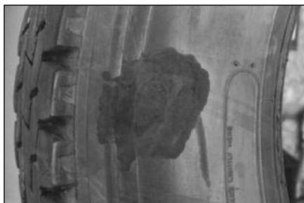
**47** Покрывка готова к эксплуатации. Если ремонт был выполнен при строгом соблюдении данной инструкции, то покрывка прослужит до износа протектора, даже при его многократном восстановлении.
