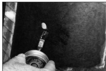
**32** Нанесите один слой клея № 760 для холодной вулканизации на отмеченную область изнутри покрышки. Дайте клею примерно 3-5 минут для того, чтобы он полностью высох.
